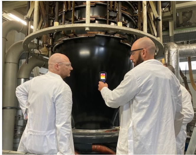
Rys. 4.64. Kontrola temperatury przy wykorzystaniu kamery termowizyjnej podczas wytwarzania w warunkach przemysłowych kompozytowej folii na bazie RLDPE o zawartości 20% mas. napełniacza na bazie UPS-u ze spalania biomasy leśnej
