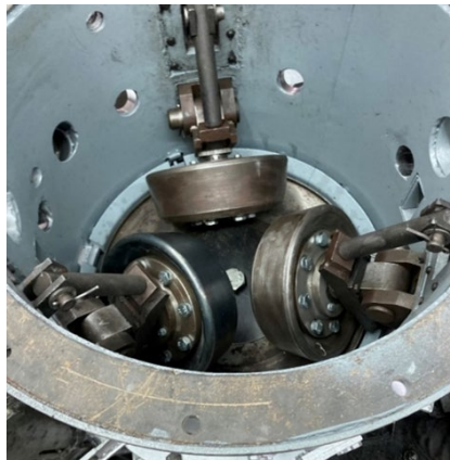
Rys. 5.4. Widok misowo-rolkowego układu mielącego Fig. 5.4. View of the bowl-roller grinding system
