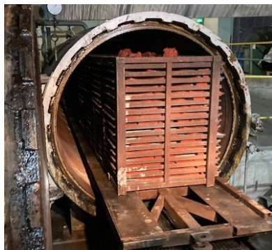
Rys. 4.42. Próbkki przygotowane do procesu wulkanizacji w autoklawie przemysłowym – faza proof of concept
