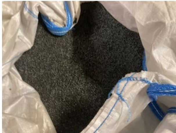
Rys. 4.62. Wytworzony regranulat RLDPE o zawartości 20% mas. napelnacza na bazie UPS-u ze spalania biomasy leśnej
