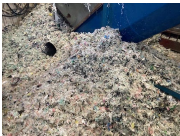
Rys. 4.61. Wytworzony w procesie recyklingu płatek służący do wytwarzania folii RLDPE Fig. 4.61. Flake produced in the recycling process used to produce RLDPE film
