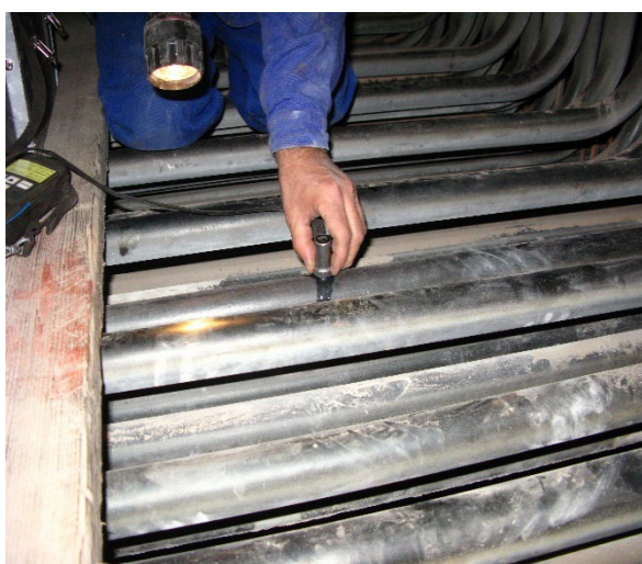
Rys. 2.24. Pomiar grubości ścianki rury Fig. 2.24. Measurement of pipe wall thickness
