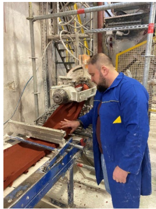
Rys. 4.40. Wytłaczarka produkcyjna, jednoślindakowa firmy VEB Erste Maschinenfabrik – faza proof of concept
