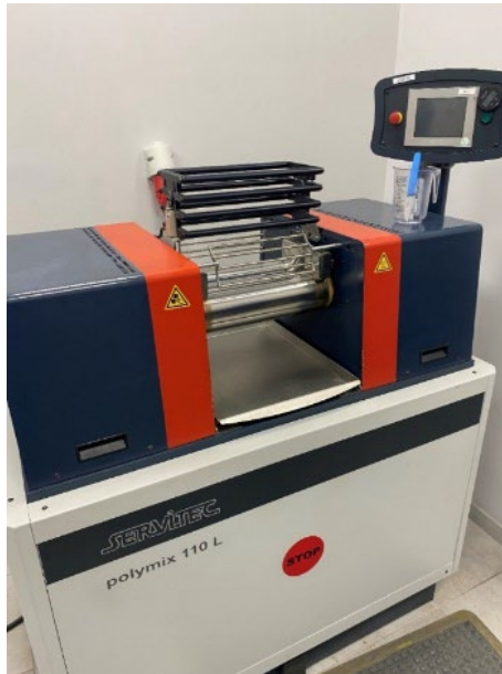
Rys. 4.37. Walcarka laboratoryjna Polymix 110L, Servitec Fig. 4.37. Polymix 110L laboratory rolling mill, Servitec
