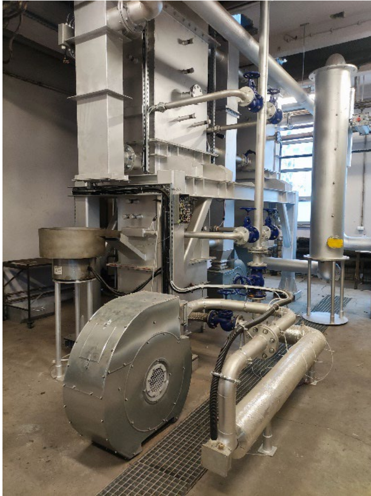
Rys. 5.13. Widok stanowiska badawczego paleniska 0,5 MWt z rusztem wibracyjnym Fig. 5.13. View of the 0.5 MWt furnace test stand with a vibrating grate
