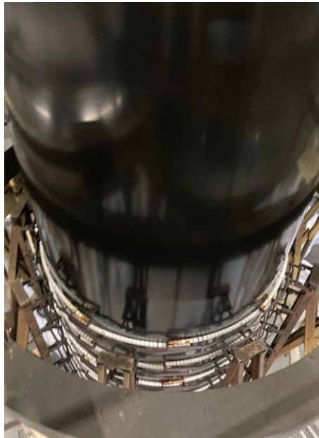
Rys. 4.63. Wytwarzanie w warunkach przemysłowych kompozytowej folii na bazie LDPE o zawartości 20% mas. napelnacza na bazie UPS-u ze spalania biomasy leśnej
