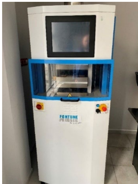
Rys. 4.37. Walcarka laboratoryjna Polymix 110L, Servitec Fig. 4.37. Polymix 110L laboratory rolling mill, Servitec
