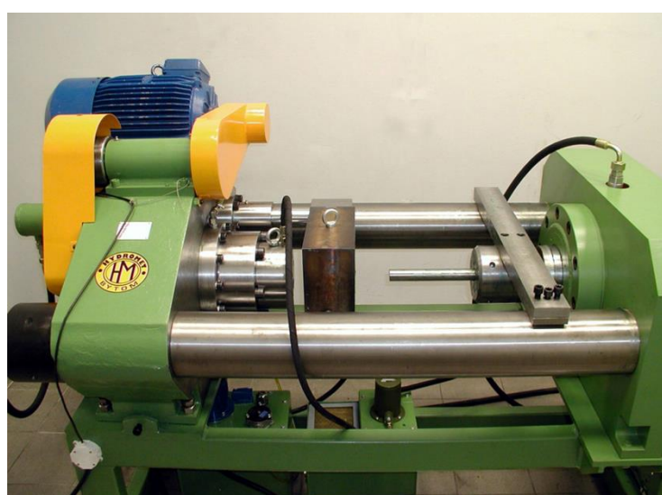
Rys. 3.6. Zdjęcie prasy KOBO umożliwiającej wyciskanie metalu na zimno przez obustronnie skręcaną matrycę
