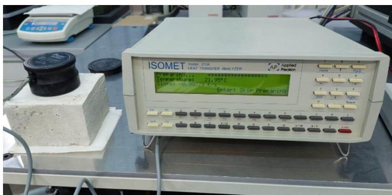
Rys. 11.4. Aparat do badania przewodności cieplnej w trakcie pomiaru
