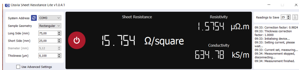
Rys. 13.8. Przykładowy wynik pomiaru cienkiej warstwy ITO o grubości 100 nm Fig. 13.8. An example of the measurement result of a ITO thin film with a thickness of 100 nm
