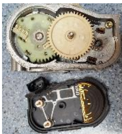
Rys. 3.2.4.1. Przepustnica sterowana elektrycznie (zdjęta pokrywa mechanizmu).
