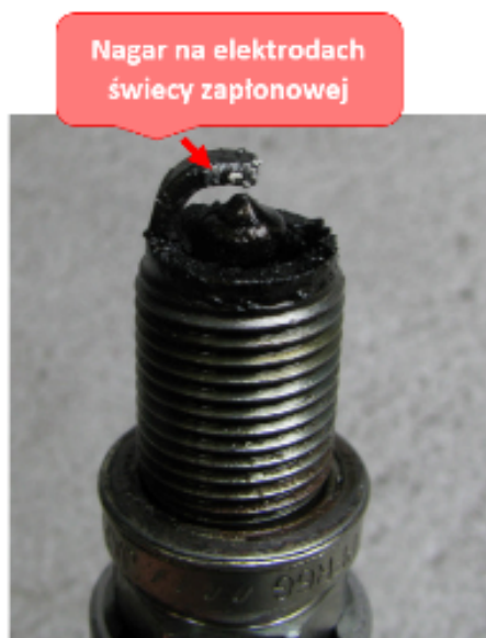
Rys. 5.3.3.13 Zdjęcie elektrod świecy zapłonowej cylindra nr 2 z uwidocznionym nagarem pochodzenia oleju silnikowego
