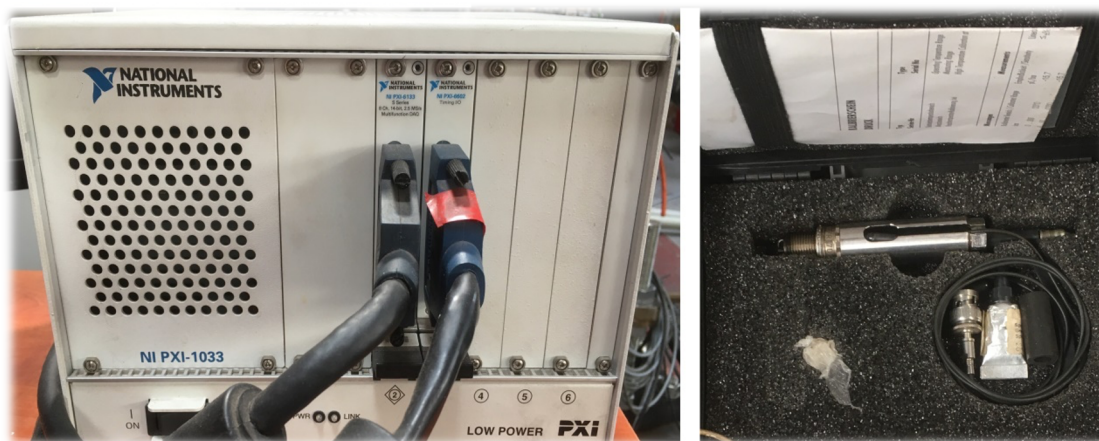
Rys. 4.4.5.1 System pomiarowy NI-PXI 1033 oraz czujnik ciśnienia w cylindrze Kistler typ 6117BF17
