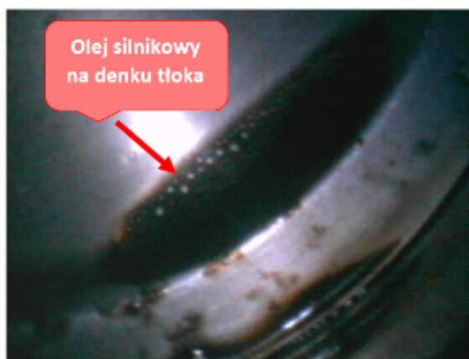
Rys. 5.3.3.11 Zdjęcie denka tłoka cylindra nr 2 z uwidocznioną zawartością oleju silnikowego
