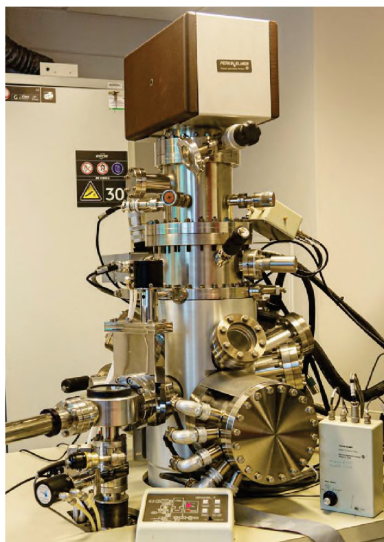
Rys. 6.8.1. Skaningowa nanosonda elektronów Augera PHI 670: •skaningowe działo elektronowe Schottky'ego z emisją polową (energia od 1 do 25 keV) • cylindryczny analizator zwierciadlany energii elektronów Augera (CMA) • skaningowe działo jonów Ar + (energia od 0,5 do 5 keV)
