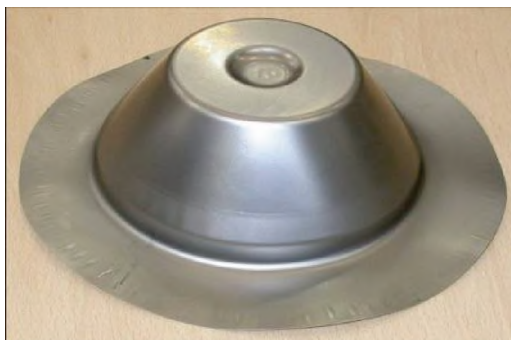
Rys. 2.3.1. Wytłoczka przemysłowa – pokrywa sprężarki silnika lotniczego – stożek, wykonana z blachy o grubości 0,45 mm ze stopu Inconel 625
