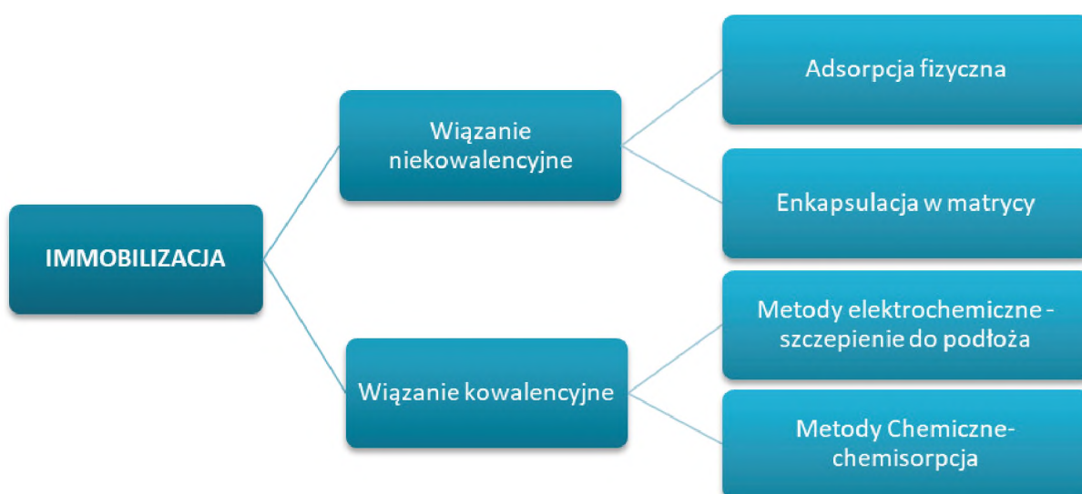
Rys. 5.7.1. Diagram przedstawiający techniki immobilizacji fotouczulaczy na nośnikach Fig. 5.7.1. Diagram illustrating techniques of immobilization of photosensitizers on solid carriers Źródło: opracowanie własne.
