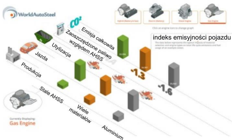
Rys. 4. Analiza cyklu życia produktu (samochodu) przedstawiająca całkowitą emisję CO 2 na kg masy pojazdu z uwzględnieniem materiału z jakiego została wykonana konstrukcja [32].
