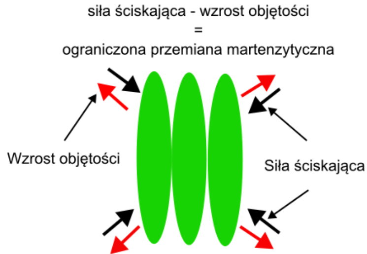
Rys. 112. Schemat oddziaływania osnowy z austenitem szczątkowym w trakcie ściskania.
