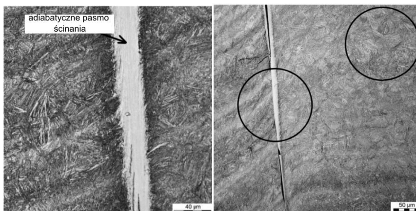
Rys. 65. Mikrostruktura stali nanobainitycznej odkształconej dynamicznie przy wykorzystaniu metody pręta Hopkinsona [59]
