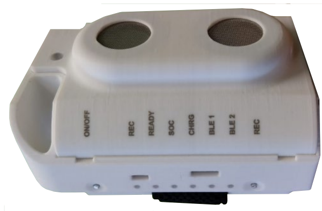
Rys. 3. Prototyp przenośnego detektora jakości powietrza powstały w ramach projektu finansowanego przez Narodowe Centrum Badań i Rozwoju w ramach Programu Operacyjnego Inteligentny Rozwój, POIR.04.01.04-00-0060/19
