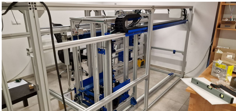
Rys. 2. Projekt stacji automatycznej wymiany akumulatorów SAWA
