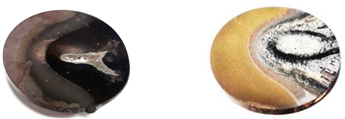
Rys.68 Wygląd powierzchni próbki molibdenowej (z lewej) i niobowej (z prawej) bez warstwy krzemkowej po teście wysokotemperaturowym HVOF. Temperatura osiągnięta na próbce – 1500°C w czasie 30s
