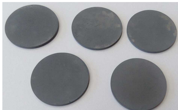
Rys.27 Wybrane próbki z molibdenu po procesie krzemowania
