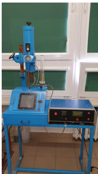
Rys.31 Stanowisko do badań odporności na ścieranie metodą erozyjną
