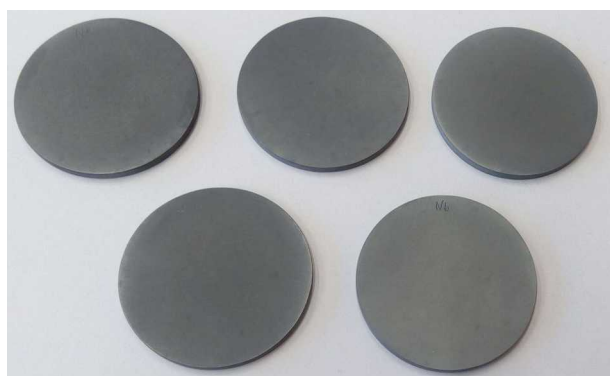
Rys.26 Wybrane próbki z niobu po procesie krzemowania
