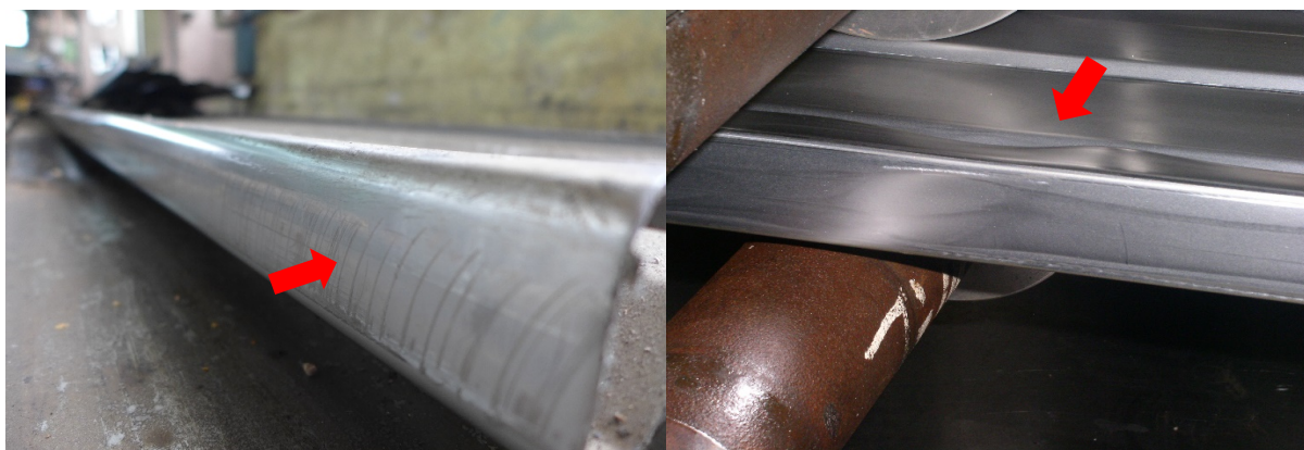
Rys. 137. Zjawisko zacierania półki elektrody oraz jej deformacja związane z błędami konstrukcyjnymi zestawu profilującego oraz dużą zmiennością właściwości wsadu technologicznego [10]
