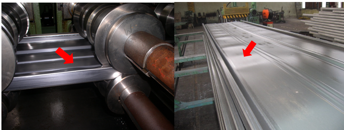
a) b) Rys. 27. Wady elektrody zbiorczej spowodowane zastosowaniem wsadu o nienormowych parametrach: a) deformacja półki elektrody, b) zjawisko pofalowania powierzchni środkowej płyty elektrody zbiorczej [10]
