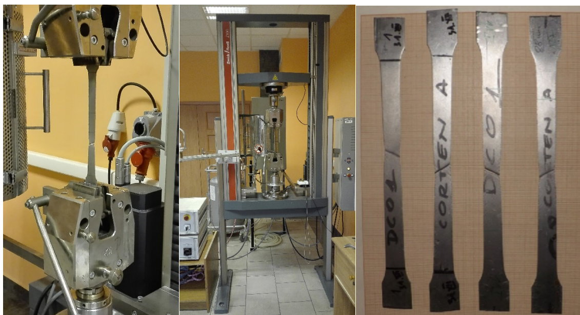
Rys. 75. Maszyna wytrzymałościowa za pomocą której wykonano statyczną próbę rozciągania próbek
