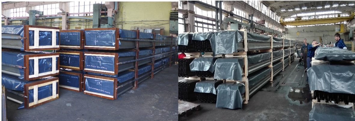
Rys. 42. Opakowanie elektrod zbiorczych – proces przygotowania paczek: a) opakowanie stalowe, b) opakowanie drewniane [10]
