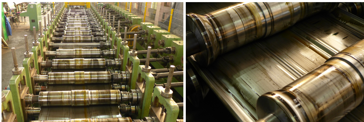
Rys. 26. Proces profilowania elektrody zbiorczej: a) widok wzdłuż poszczególnych stacji roboczych, b) etap kształtowania półki elektrody [10]
