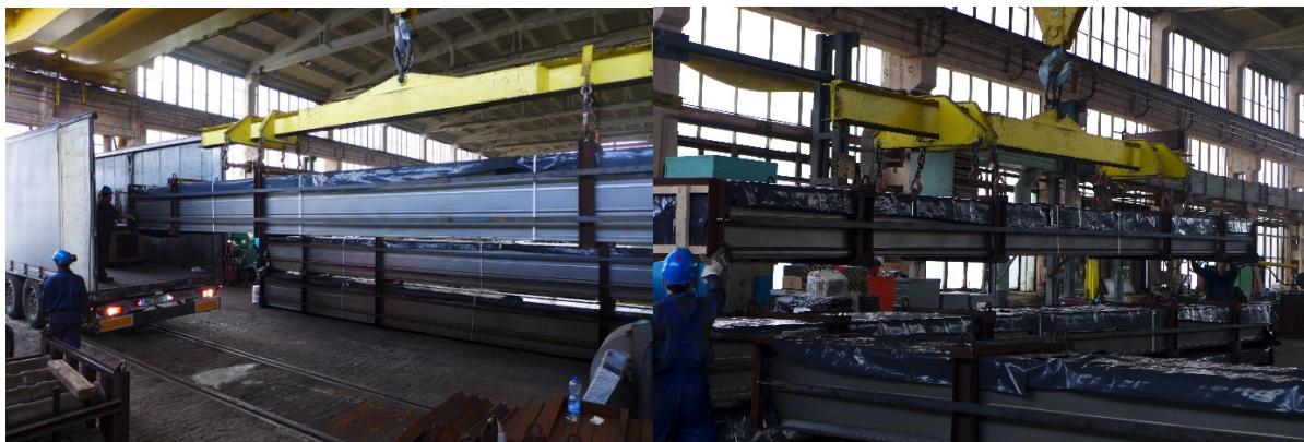
Rys. 42. Opakowanie elektrod zbiorczych – proces przygotowania paczek: a) opakowanie stalowe, b) opakowanie drewniane [10]
