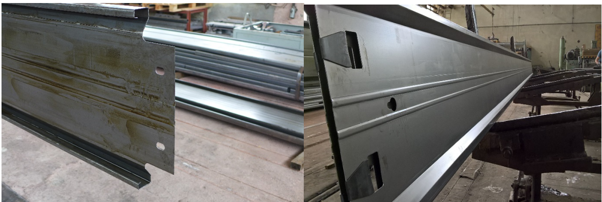
Rys. 40. Przykładowe operacje obróbki plastycznej na zimno wykonywane na prasach bocznych przynależnych do linii produkcyjnej [10]
