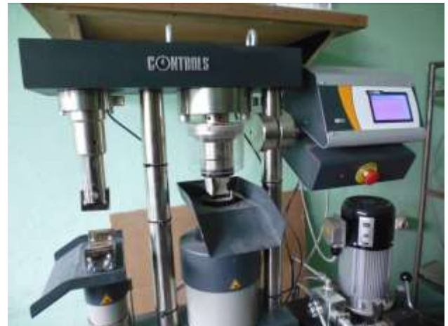
Rys. Z1.4. Badania wytrzymałości na rozciąganie oraz ściskanie badanej zaprawy: a) badanie na zginanie, b) badania na ściskanie
