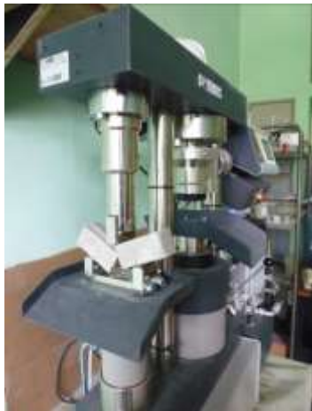
Rys. Z1.4. Badania wytrzymałości na rozciąganie oraz ściskanie badanej zaprawy: a) badanie na zginanie, b) badania na ściskanie
