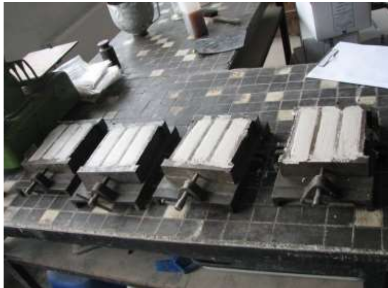
Rys. Z1.2. Próbkki zaprawy po uformowaniu
