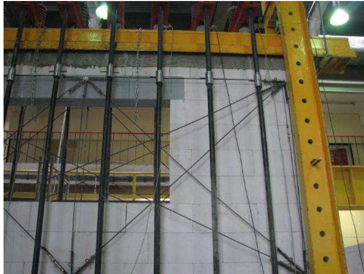
Rys. Z2.139. Pierwsze zarysowania ściany wzdłuż pionowej krawędzi otworu od strony podpory A
