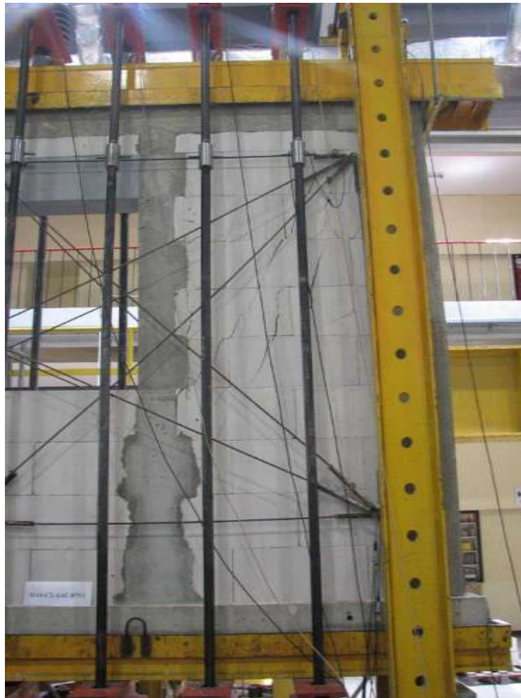
Rys. Z2. 213. Zarysowania skrajnego filarka ściany od strony podpory A
