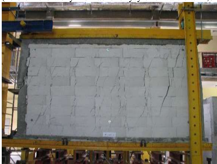
Rys. Z2.74. Widok modelu badawczego HOS-C-AAC-10/2 w chwili zniszczenia od strony N-N
