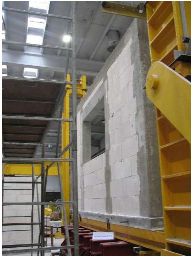
Rys. Z2.237. Widok modelu badawczego HAS-C2-AAC-075/2 w chwili zniszczenia od strony S-S
