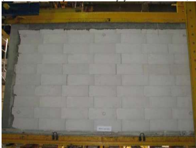
Rys.Z2.21. Widok modelu badawczego HOS-C-AAC-010/2 w chwili zniszczenia od strony N-N
