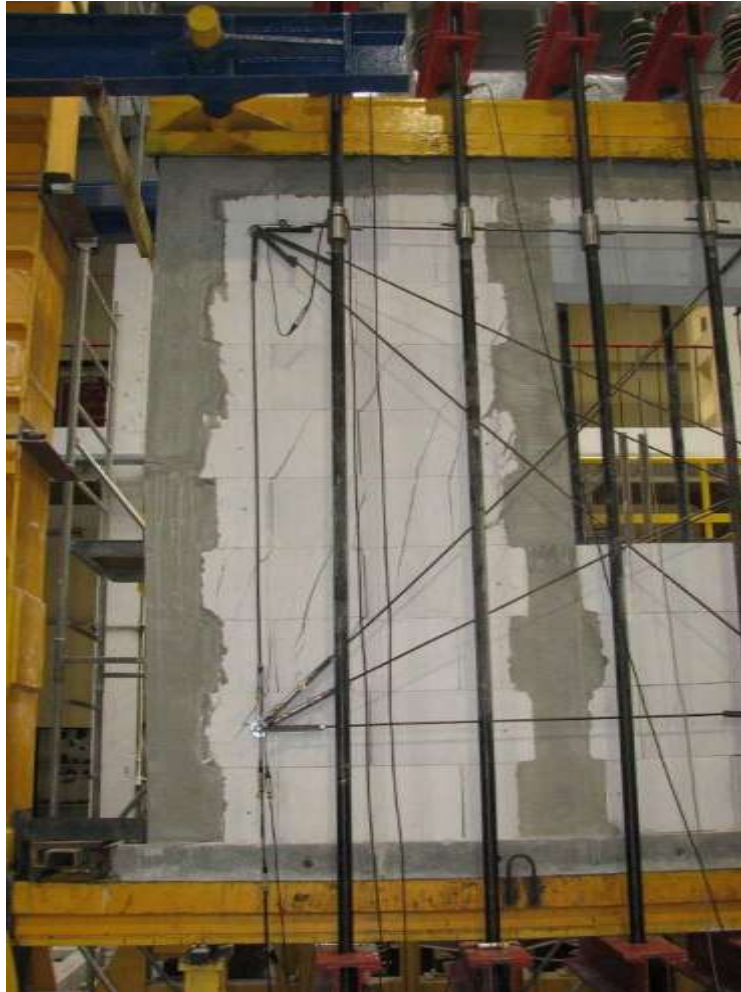
Rys. Z2.230. Zarysowania skrajnego filarka ściany od strony podpory B
