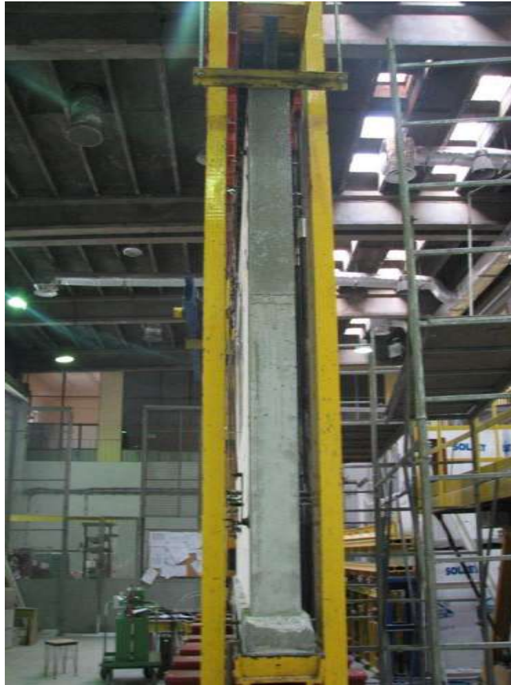
Rys. Z2.131. Poziome zarysowanie żelbetowego rdzenia w połowie wysokości od strony podpory A
