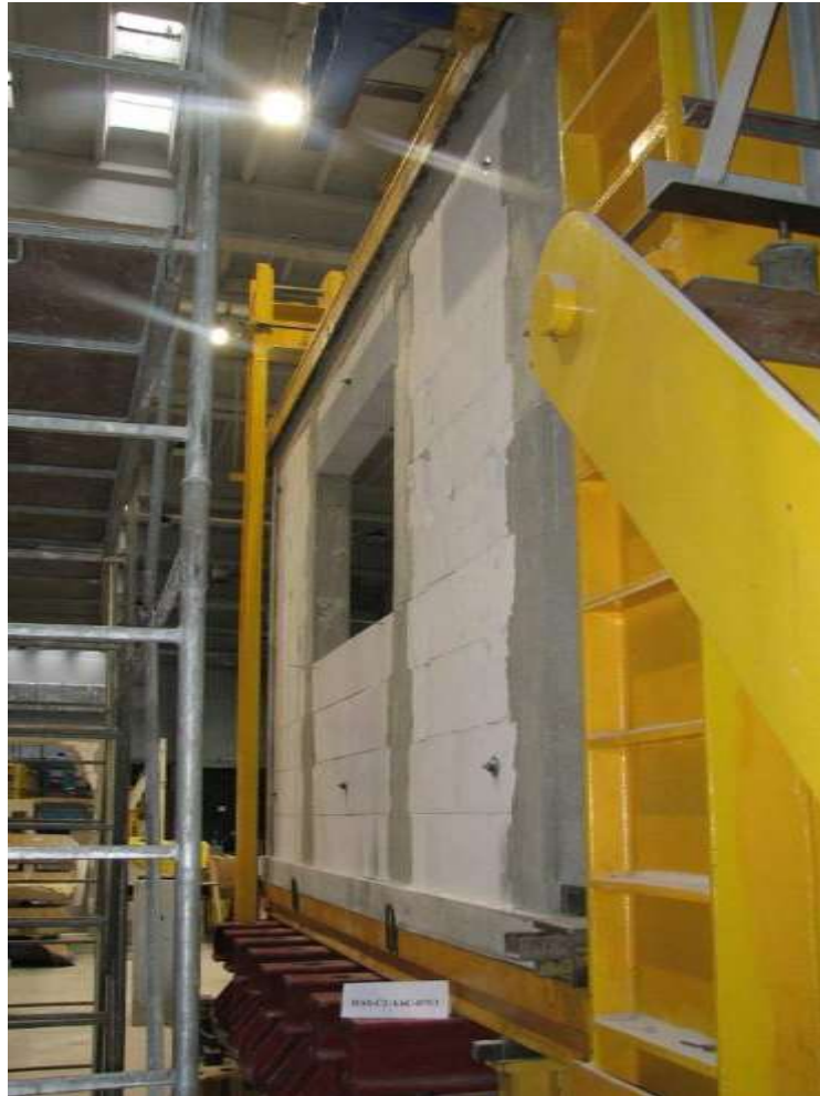
Rys. Z2.220. Widok modelu badawczego HAS-C2-AAC-075/1 w chwili zniszczenia od strony S-S
