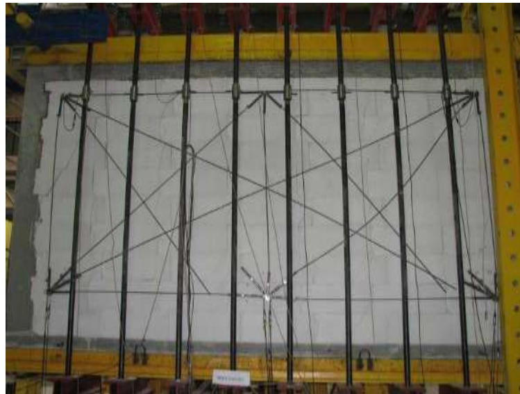
Rys. Z2. 57. Pionowe zarysowania ściany
