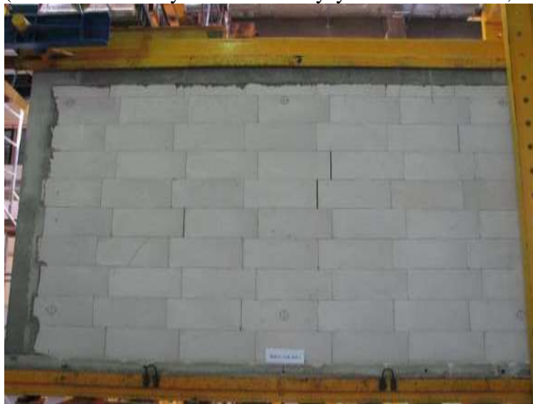
Rys.Z2. 9. Widok modelu badawczego HOS-C-AAC-010/1 w chwili zniszczenia od strony N-N
