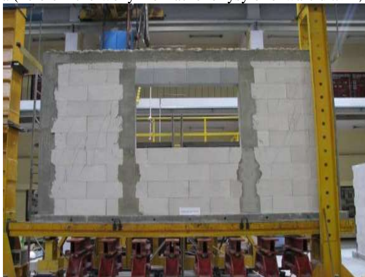
Rys. Z2.236. Widok modelu badawczego HAS-C2-AAC-075/2 w chwili zniszczenia od strony N-N
