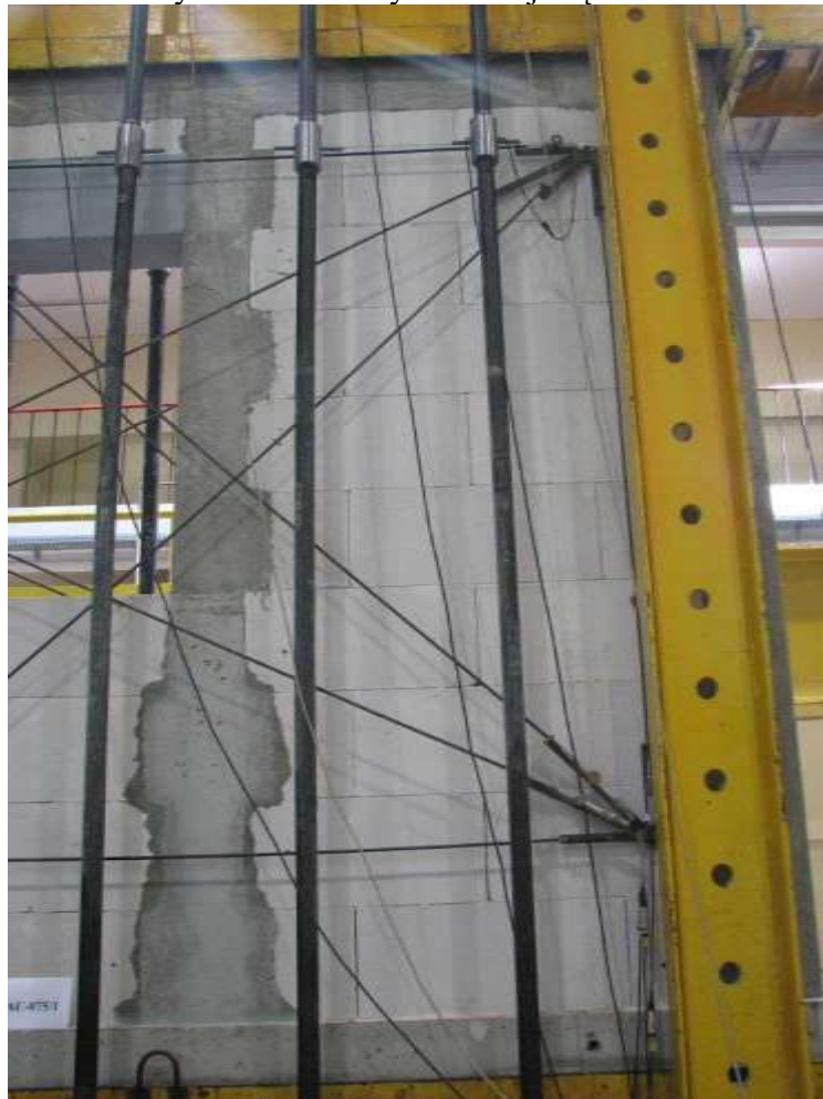
Rys. Z2.208. Pierwsze zarysowania na styku muru i rdzeni w okolicy otworu okiennego od strony podpory B
