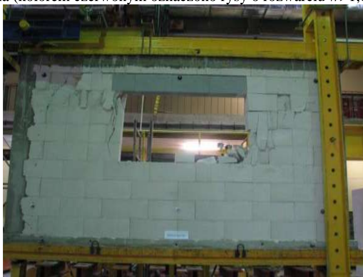
Rys. Z2.147. Widok modelu badawczego HAS-C1-AAC-10/1 w chwili zniszczenia od strony N-N
