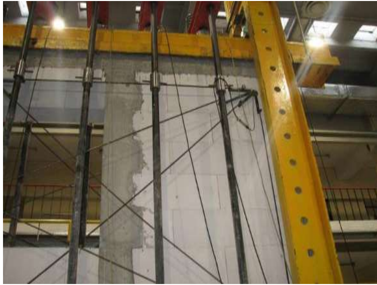
Rys. Z2.261. Pierwsze zarysowania filarka od strony podpory A
