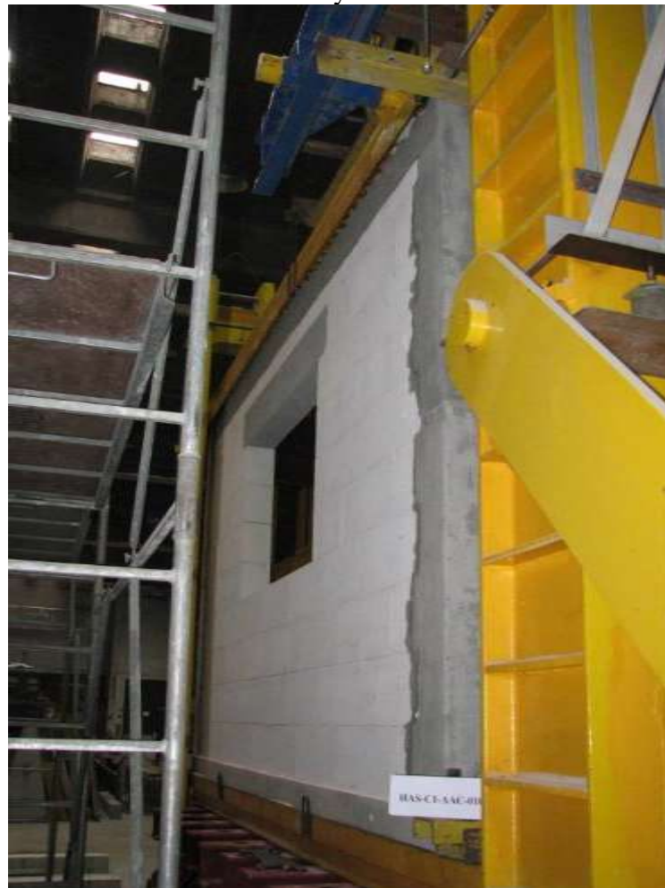
Rys. Z2.105. Widok modelu badawczego HAS-C1-AAC-010/2 w chwili zniszczenia od strony S-S
