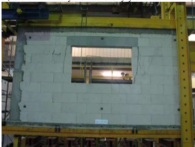
Rys. Z2.133. Widok modelu badawczego HAS-C1-AAC-075/2 w chwili zniszczenia od strony N-N
