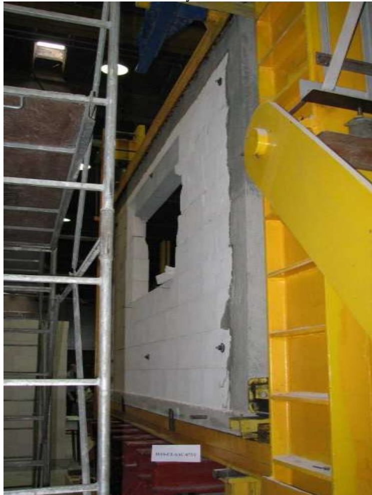
Rys. Z2.120. Widok modelu badawczego HAS-C1-AAC-075/1 w chwili zniszczenia od strony S-S
