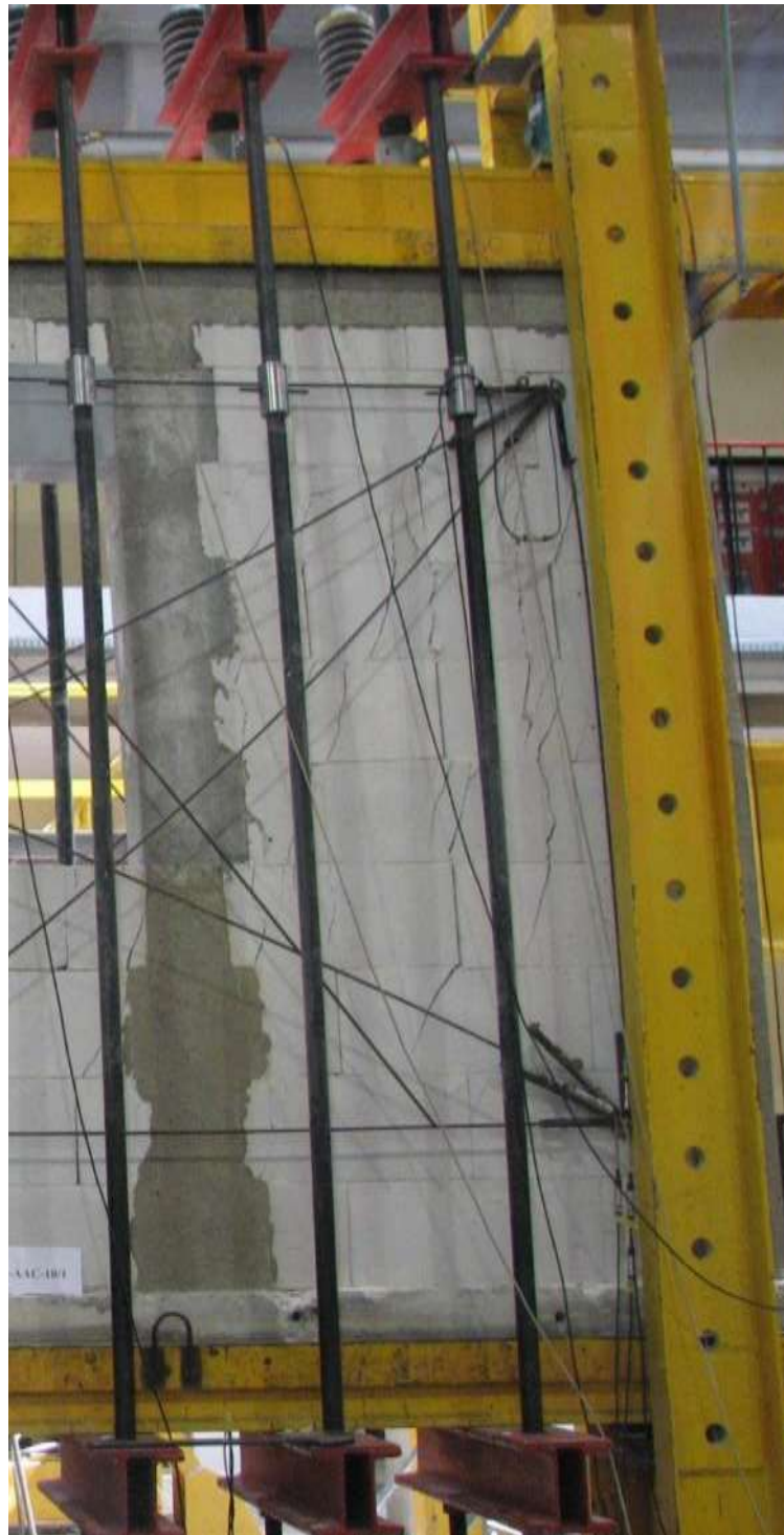
Rys. Z2.248. Zarysowania skrajnego filarka ściany od strony podpory A
