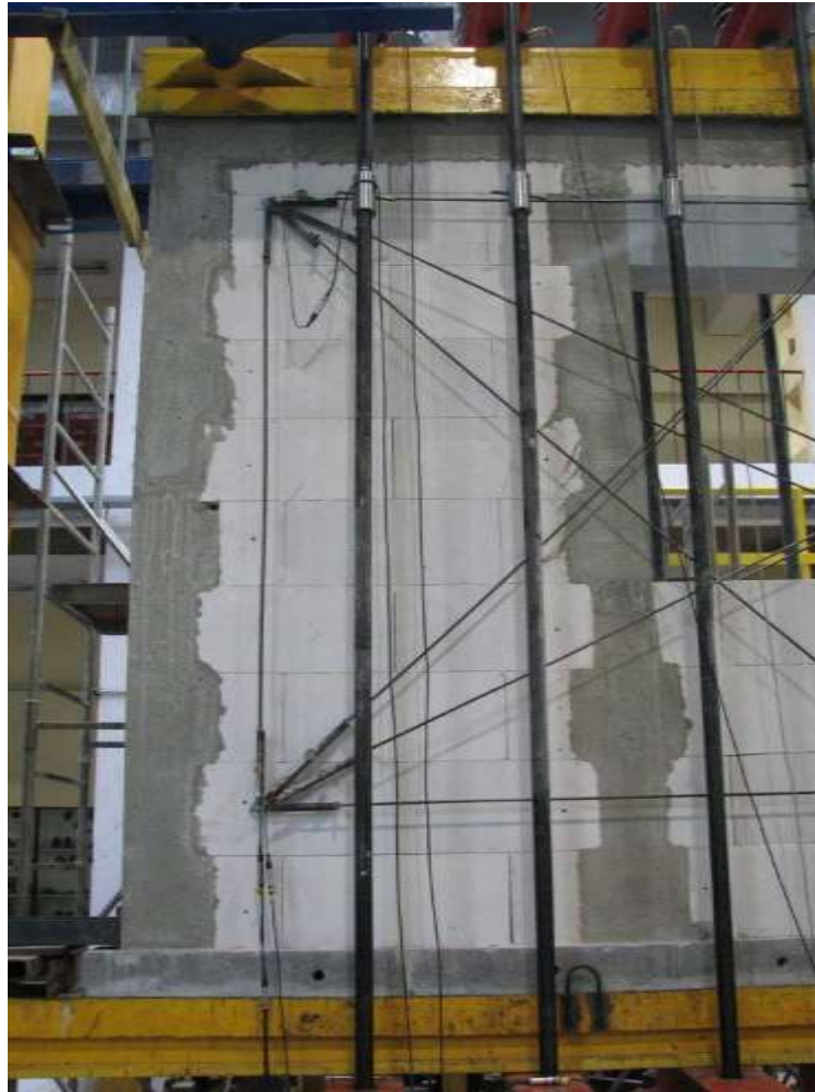
Rys. Z2.227. Wtórne zarysowania filarka od strony podpory B
