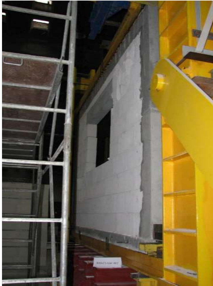
Rys. Z2.164. Widok modelu badawczego HAS-C1-AAC-10/2 w chwili zniszczenia od strony S-S
