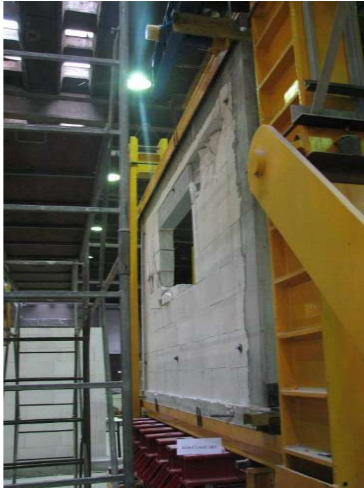
Rys. Z2.148. Widok modelu badawczego HAS-C1-AAC-10/1 w chwili zniszczenia od strony S-S
