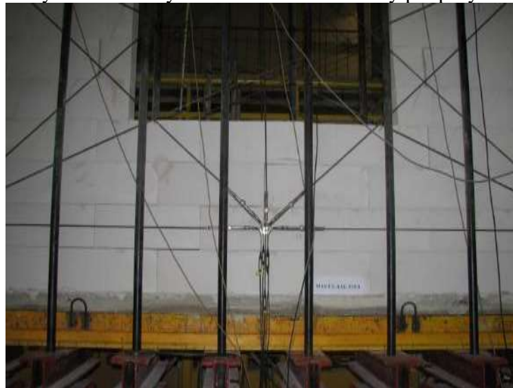
Rys. Z2.85. Zarysowania pasa podokiennego
