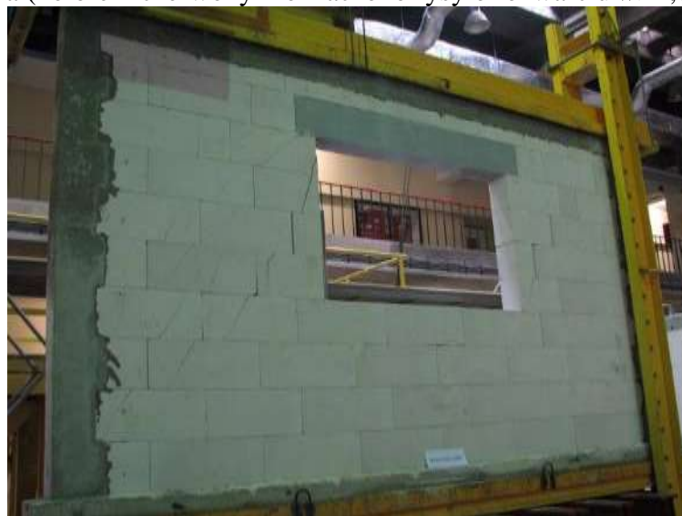
Rys. Z2.89. Widok modelu badawczego HAS-C1-AAC-010/1 w chwili zniszczenia od strony N-N
