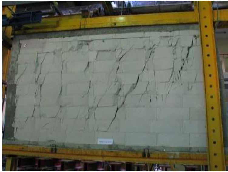
Rys.Z2. 48. Widok modelu badawczego HOS-C-AAC-075/2 w chwili zniszczenia od strony N-N
