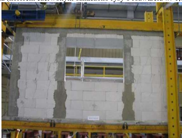
Rys. Z2.253. Widok modelu badawczego HAS-C2-AAC-10/1 w chwili zniszczenia od strony N-N
