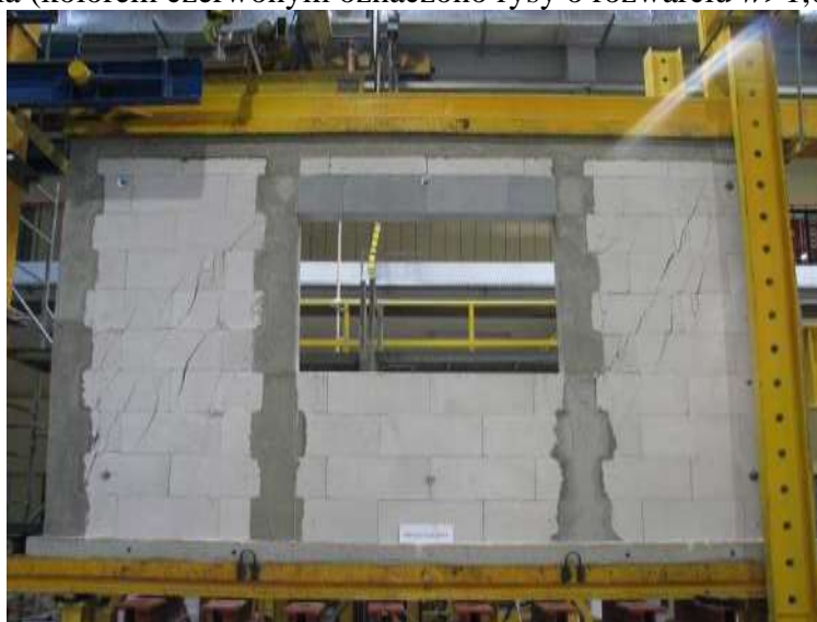
Rys. Z2.219. Widok modelu badawczego HAS-C2-AAC-075/1 w chwili zniszczenia od strony N-N
