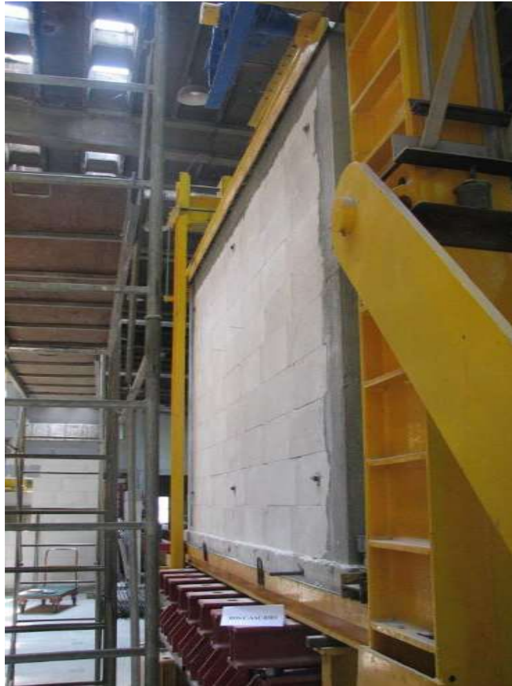
Rys.Z2.22. Widok modelu badawczego HOS-C-AAC-010/2 w chwili zniszczenia od strony N-N
