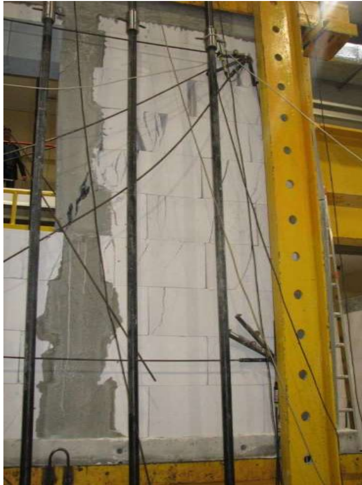
Rys. Z2.177. Ścięcie rdzenia w rejonie dolnego naroża otworu od strony podpory B
