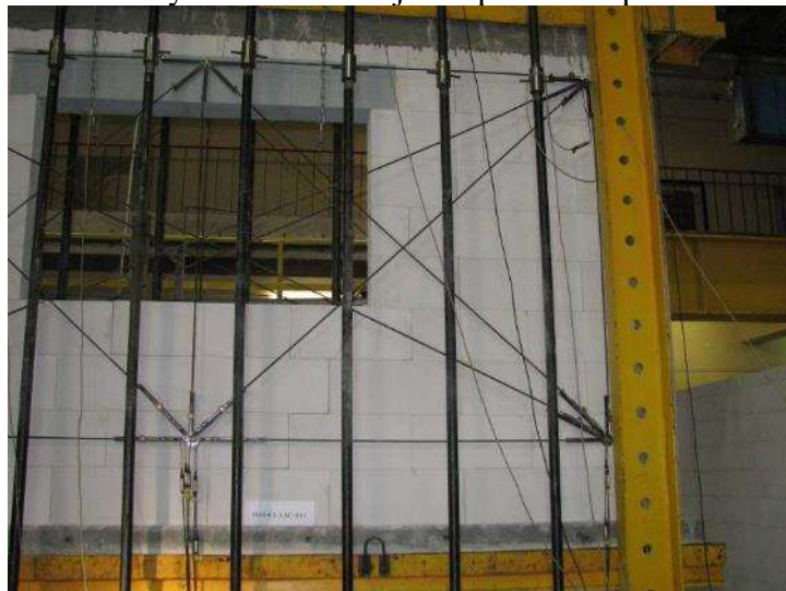
Rys. Z2.155. Wtórne, ukośne zarysowania naroża otworu okiennego
