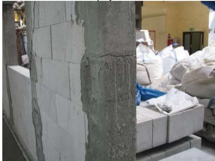
Rys. Z2.199. Pozioma rysa w ryglu od strony podpory B
