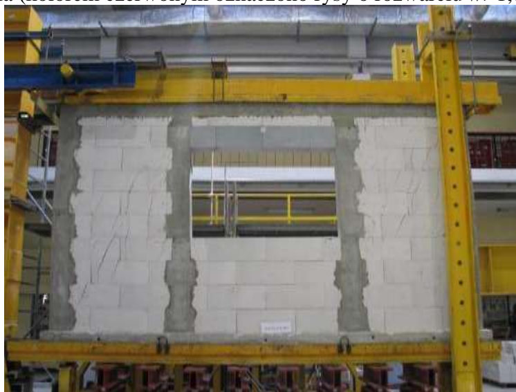
Rys. Z2.272. Widok modelu badawczego HAS-C2-AAC-10/2 w chwili zniszczenia od strony N-N
