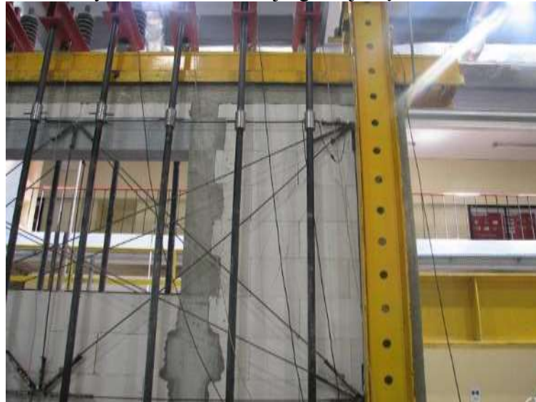
Rys. Z2.210. Wtórne zarysowania w górnej i środkowej części filarka od strony podpory A
