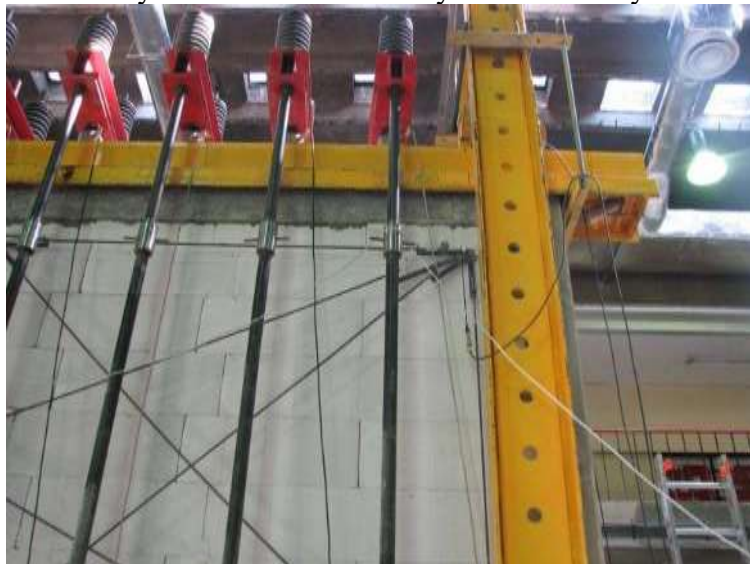
Rys. Z2.68. Wtórne zarysowania ściany od strony podpory A
