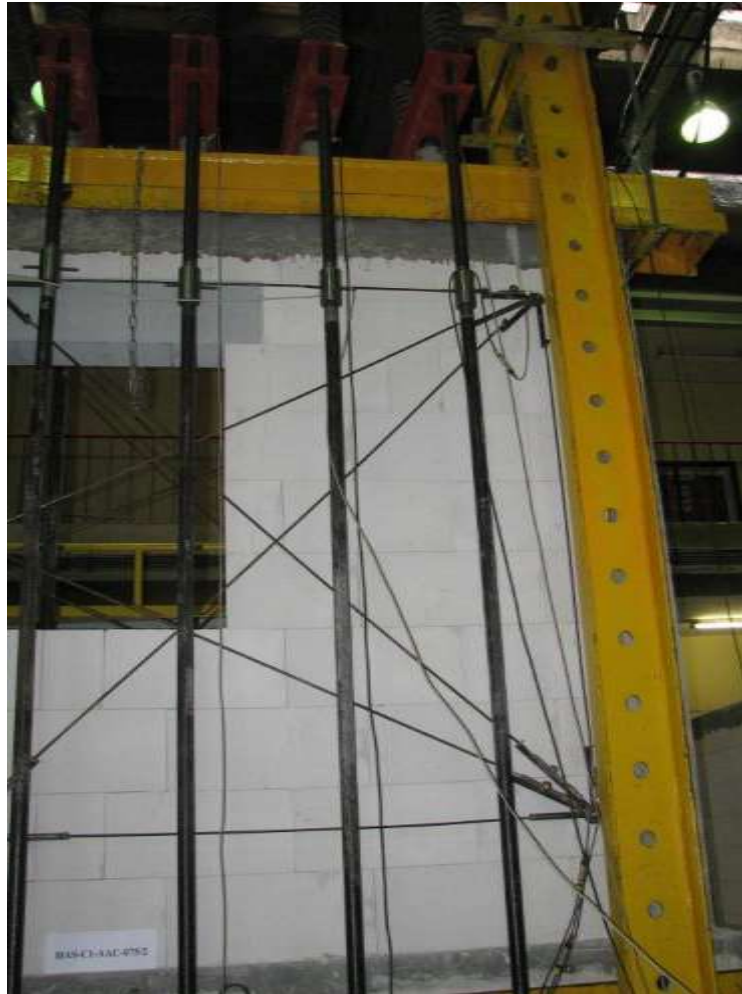
Rys. Z2.127. Wtórne zarysowania filarka od strony podpory A
