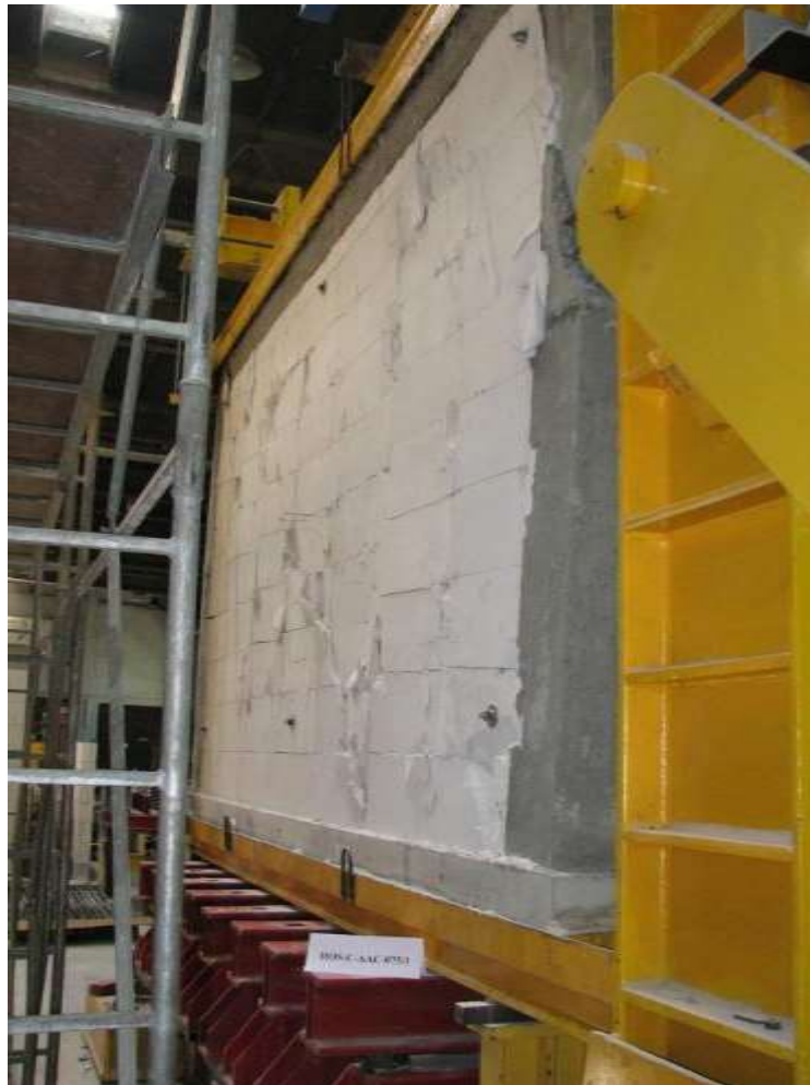
Rys.Z2. 35. Widok modelu badawczego HOS-C-AAC-075/1 w chwili zniszczenia od strony N-N
