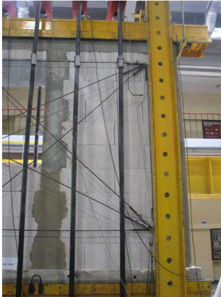
Rys. Z2.245. Wtórne zarysowania filarka od strony podpory A
