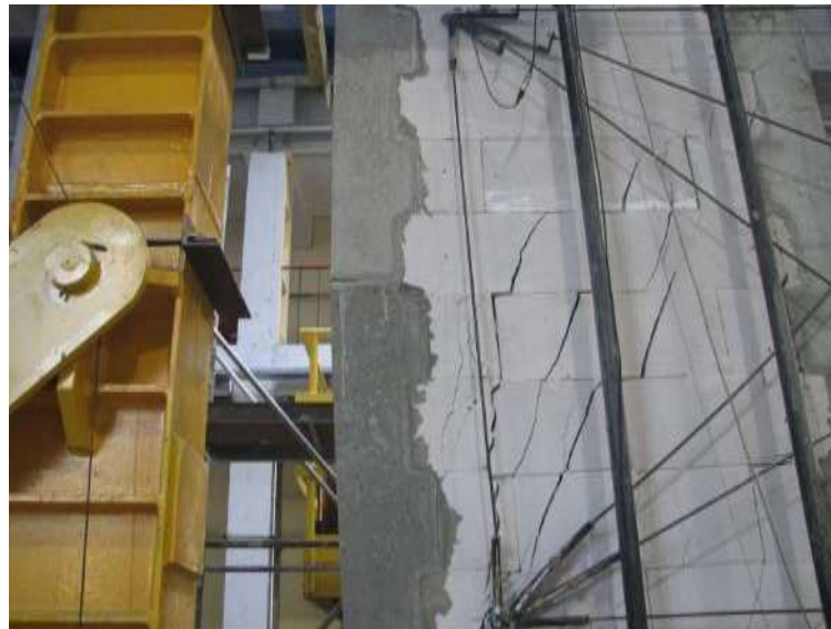
Rys. Z2.195. Poziome zarysowanie żelbetowego rdzenia w połowie wysokości od strony podpory B
