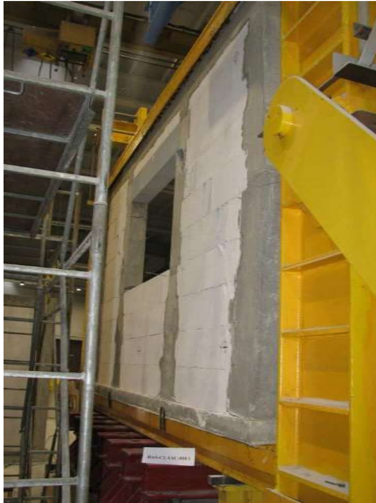
Rys. Z2.183. Widok modelu badawczego HAS-C2-AAC-010/1 w chwili zniszczenia od strony S-S
