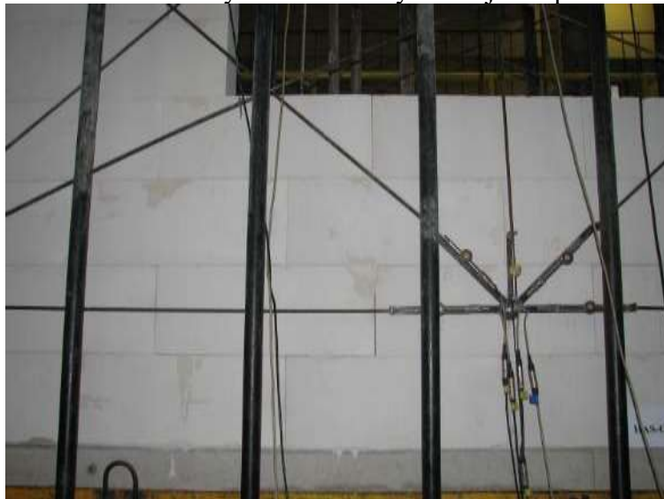
Rys. Z2.96. Pierwsze zarysowania w pasie podokiennym
