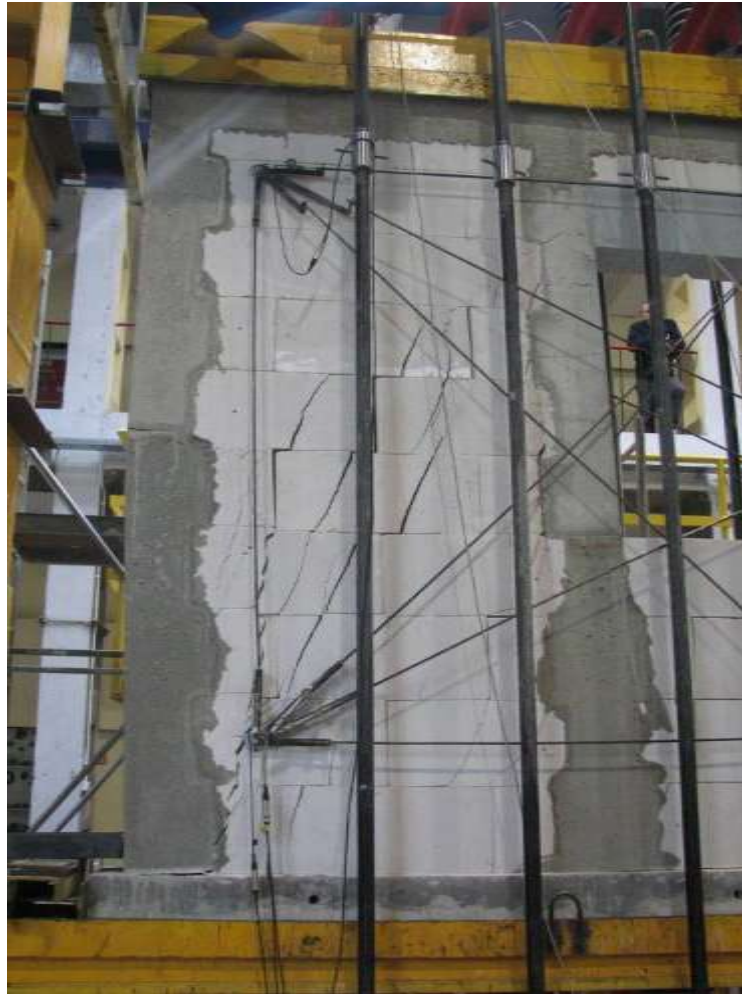
Rys. Z2.193. Zarysowania skrajnego filarka ściany od strony podpory B
