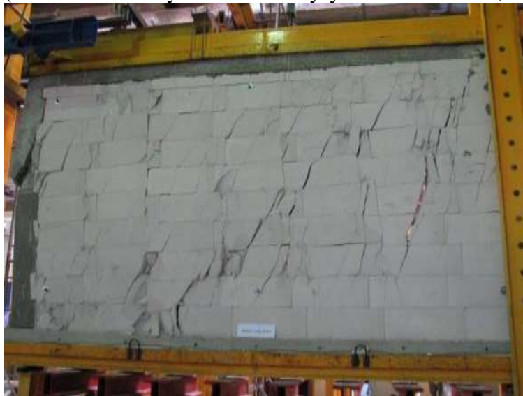
Rys.Z2. 34. Widok modelu badawczego HOS-C-AAC-075/1 w chwili zniszczenia od strony N-N
