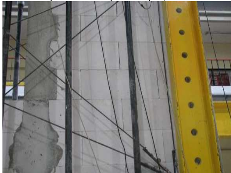
Rys. Z2.226. Pierwsze zarysowania w połowie wysokości filarka od strony podpory B
