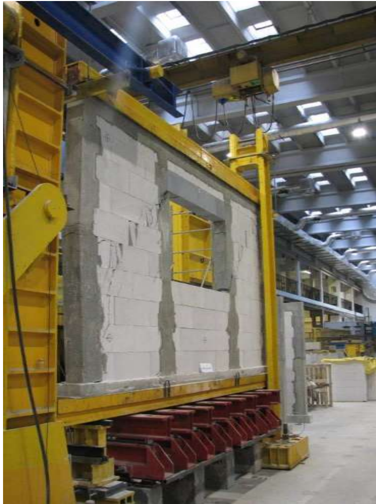
Rys. Z2.182. Widok modelu badawczego HAS-C2-AAC-010/1 w chwili zniszczenia od strony N-N
