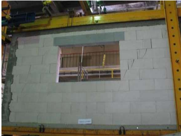
Rys. Z2.104. Widok modelu badawczego HAS-C1-AAC-010/2 w chwili zniszczenia od strony N-N
