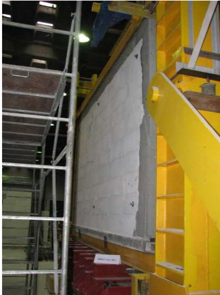
Rys. Z2. 62. Widok modelu badawczego HOS-C-AAC-10/1 w chwili zniszczenia od strony N-N
