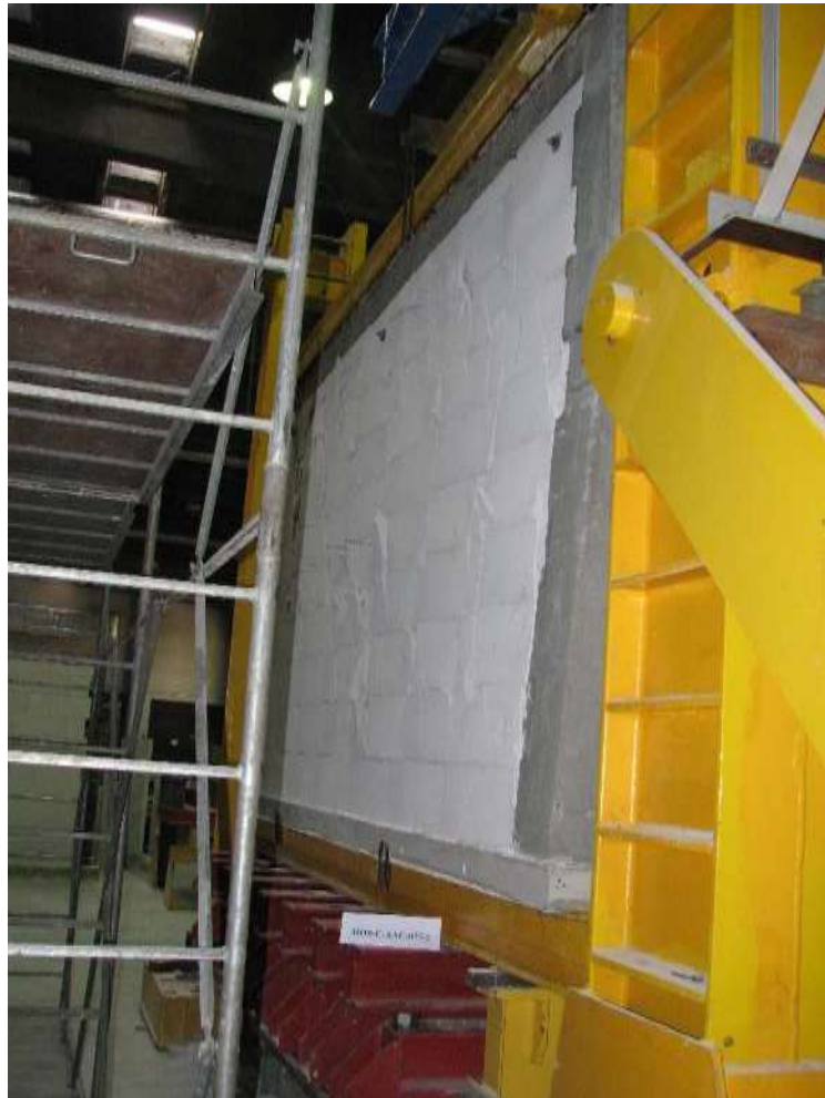
Rys.Z2. 49. Widok modelu badawczego HOS-C-AAC-075/2 w chwili zniszczenia od strony N-N
