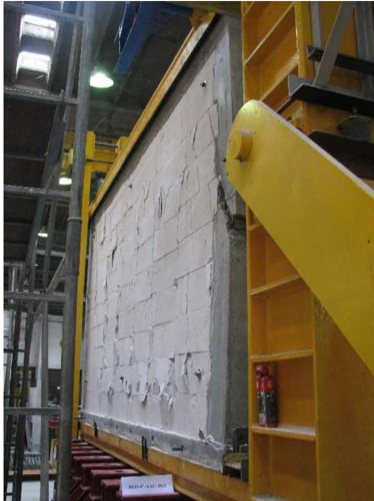
Rys. Z2.75. Widok modelu badawczego HOS-C-AAC-10/2 w chwili zniszczenia od strony N-N
