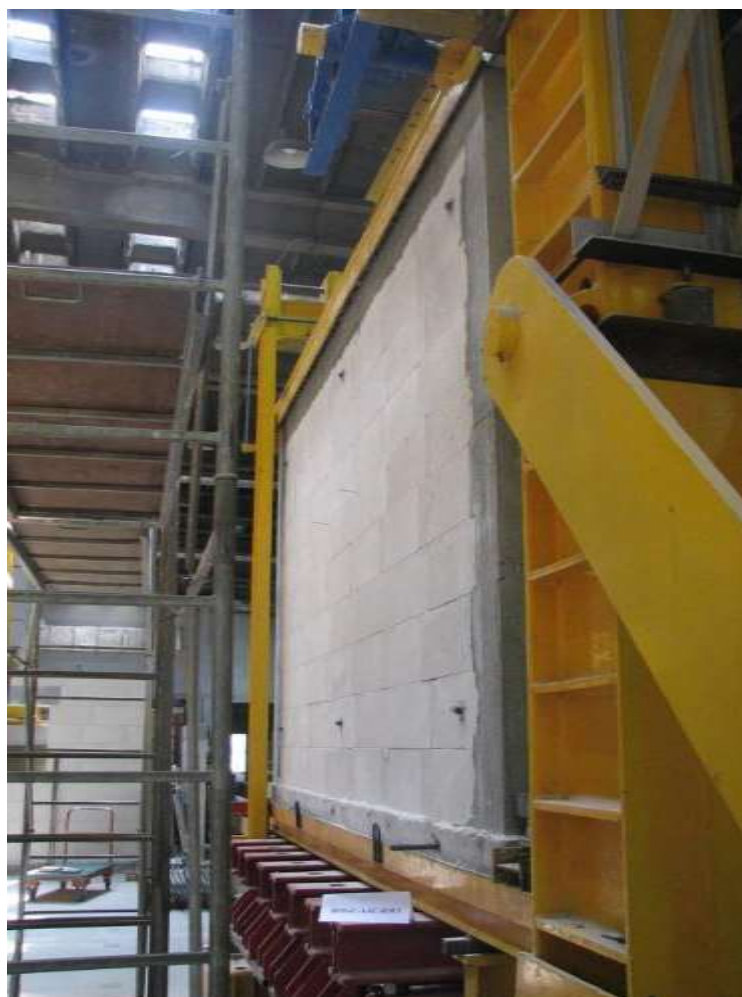
Rys.Z2. 10. Widok modelu badawczego HOS-C-AAC-010/1 w chwili zniszczenia od strony N-N
