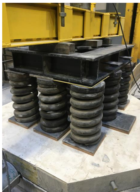
Rys. 7-2. Układ dziewięciu sprężyn walcowych ze stałą odległością zwojów
