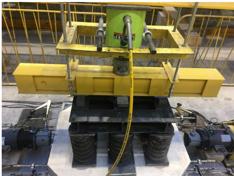
Rys. 7-1. Układ trzech siłowników podłączonych do elektrycznych pomp hydraulicznych
