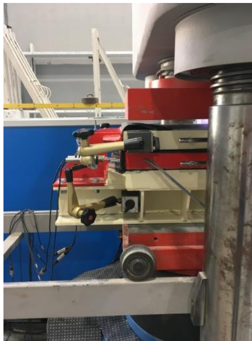
Rys. 5-14. Rozmieszczenie liniowych czujników przemieszczeń
