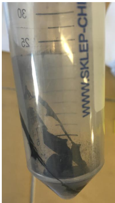
Rys. 5-6. Pozostałość stała z próbki smaru LOTOS GRAFITOWANY po wymyciu toluenem
