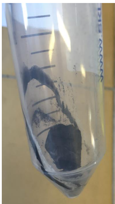
Rys. 5-7. Pozostałość stała z próbki smaru LOTOS EP 23 po wymyciu toluenem
