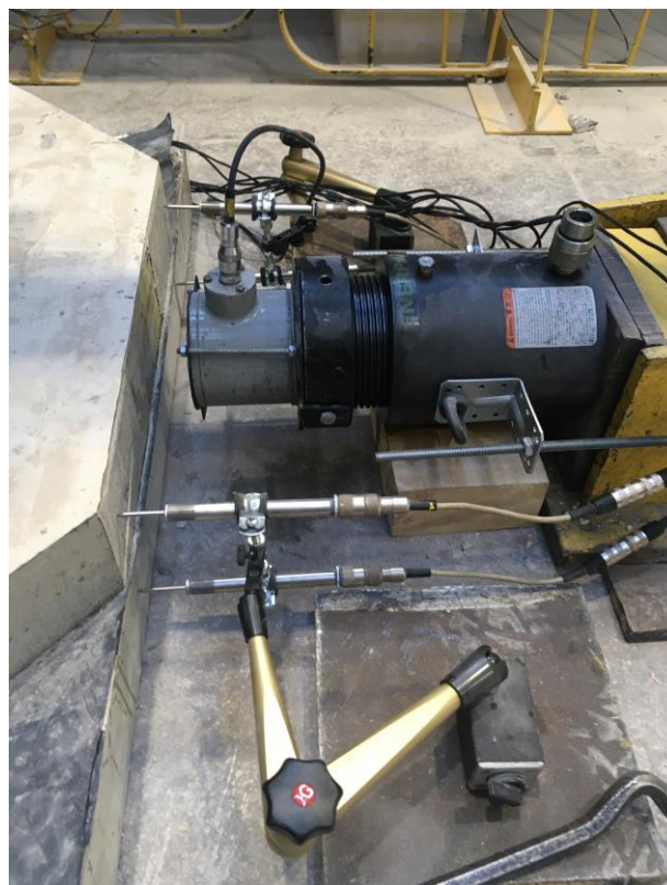
Rys. 7-8. Rozmieszczenie liniowych czujników przemieszczeń
