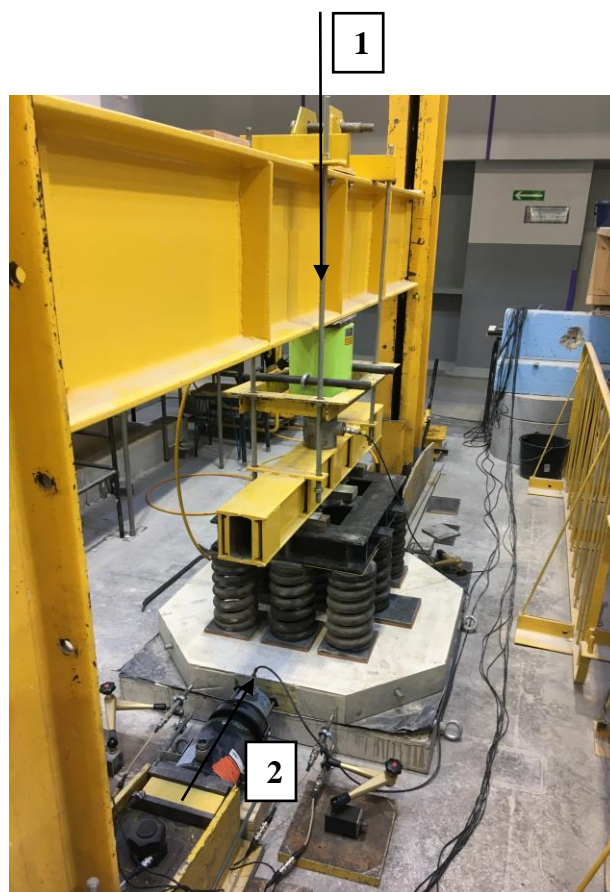
Rys. 7-6. Betonowe płyty poddane obciążeniu pionowemu (1) i poziomemu (2)
