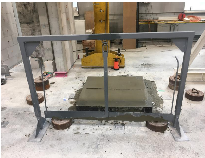
Rys. 7-5. Urządzenie służące do nadania kształtu części sfery górnej powierzchni betonowej płyty
