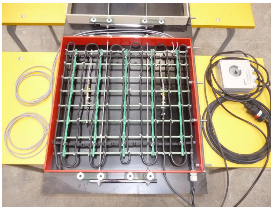
Rys. 5-15. Szalunek środkowej betonowej płyty z przewodem grzejnym TV SHTV 30 W/m THERMOVAL
