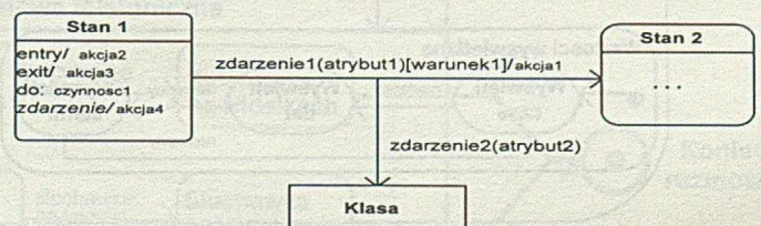
Rys. 16. Graficzna notacja diagramu stanów
