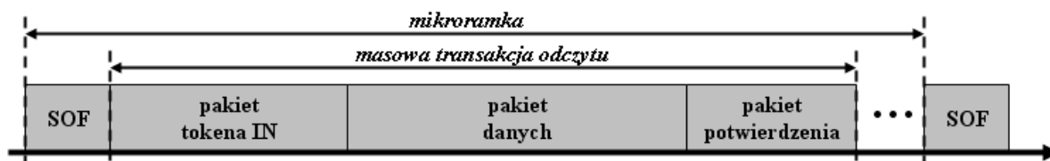
Rys. 2. Mikroramka w systemie komunikacyjnym USB Fig. 2. The micro-frame in the USB communication system
