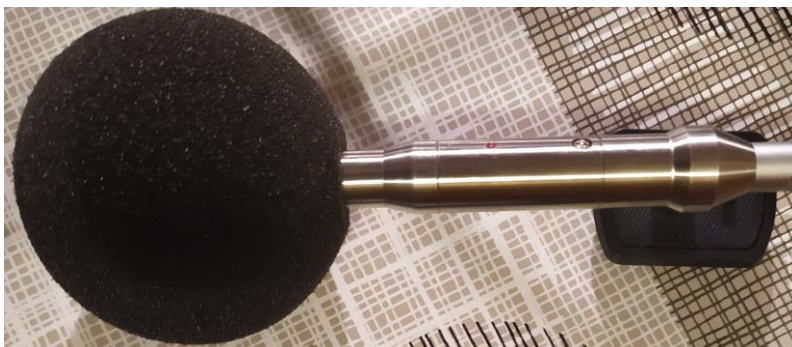
Rys. 35 . Mikrofon 7052E z zabudowanym przedwzmacniaczem SV18
