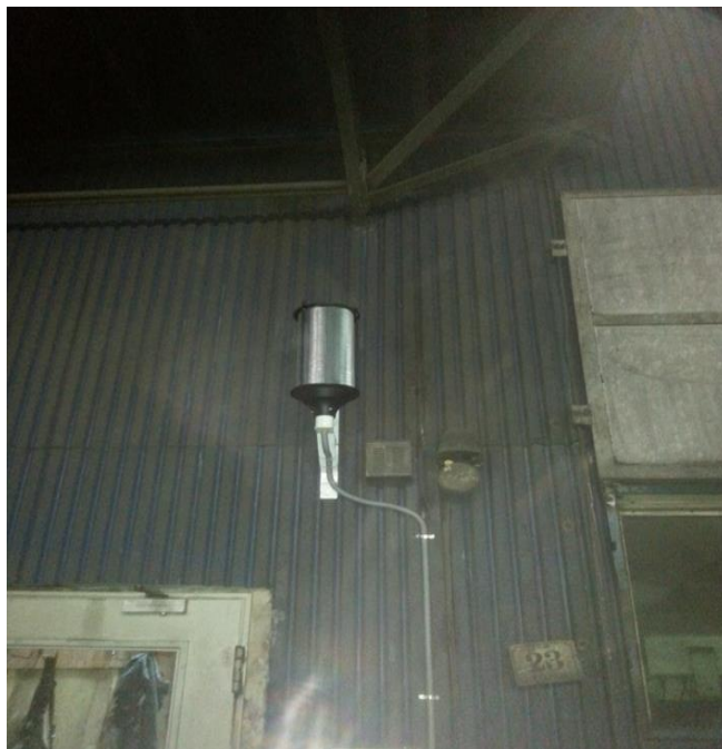
Rys. 39. Położenie mikrofonu na ścianie sterowni
