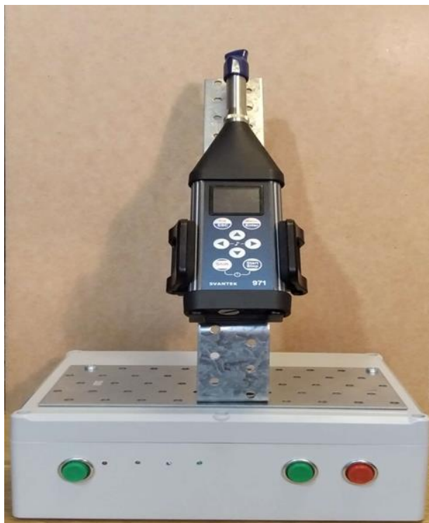
Rys.36 Kontroler wraz z miernikiem poziomu dźwięku.
