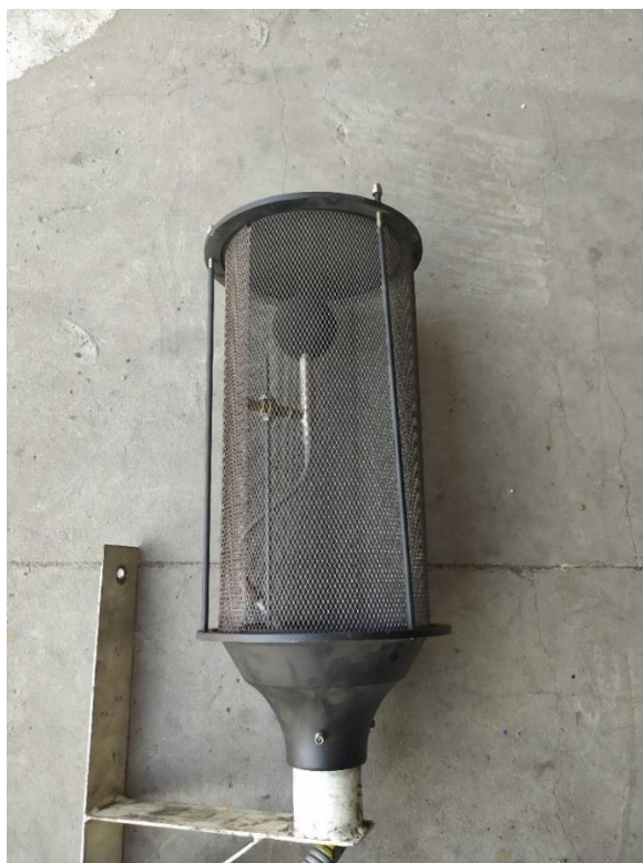
Rys. 40. Mikrofon zabudowany w osłonie
