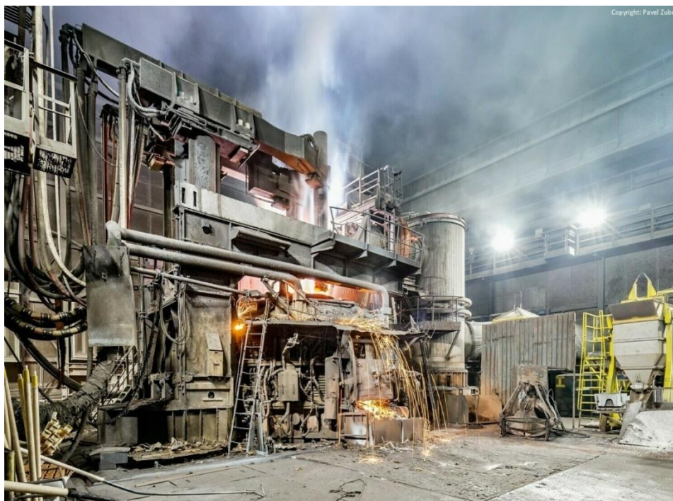
Rys. 32 . Elektryczny piec łukowy wykorzystany do badań [58]
