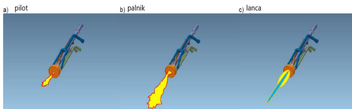
Rys. 11. Palniki typu CONSO w poszczególnych profilach [29]
