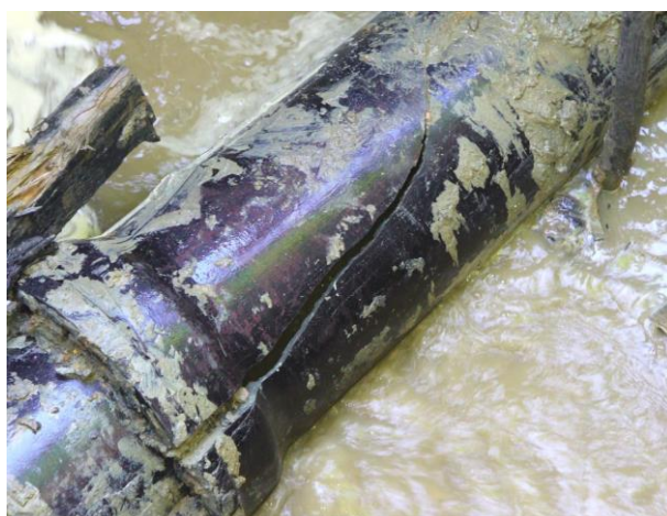
Rys. 2. Wzdłużne pęknięcie kielicha żeliwnej rury wodociągowej Fig. 2. Longitudinal cracks of the socket of a cast-iron water pipe
