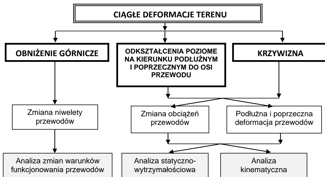
Rys. 1. Wpływ eksploatacji górniczej na podziemne rurociągi [7]
