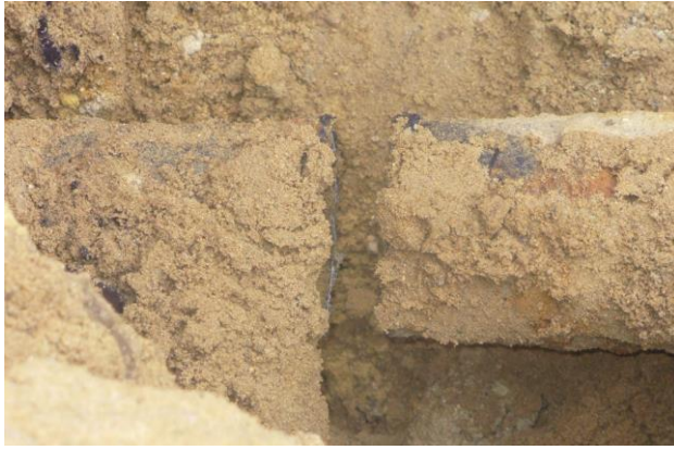
Rys. 7. Pęknięcie na spawie stalowego gazociągu Fig. 7. Crack in the weld of the steel gas pipeline
