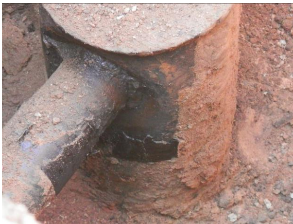
Rys. 7. Pęknięcie na spawie stalowego gazociągu Fig. 7. Crack in the weld of the steel gas pipeline
