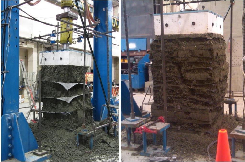
Rys. 1. Badania zachowania się konstrukcji z gruntu zbrojonego wykonanych z tego samego gruntu, ale różniących się rozstawem wkładek zbrojeniowych [3]
