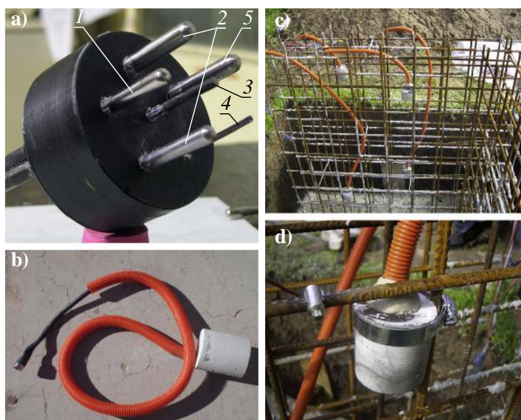
Rys. 9. Czujnik wielofunkcyjny według rozwiązania przedstawionego w pracy [7] Fig. 9. Multifunctional sensor according to the solution presented in the paper [7]
