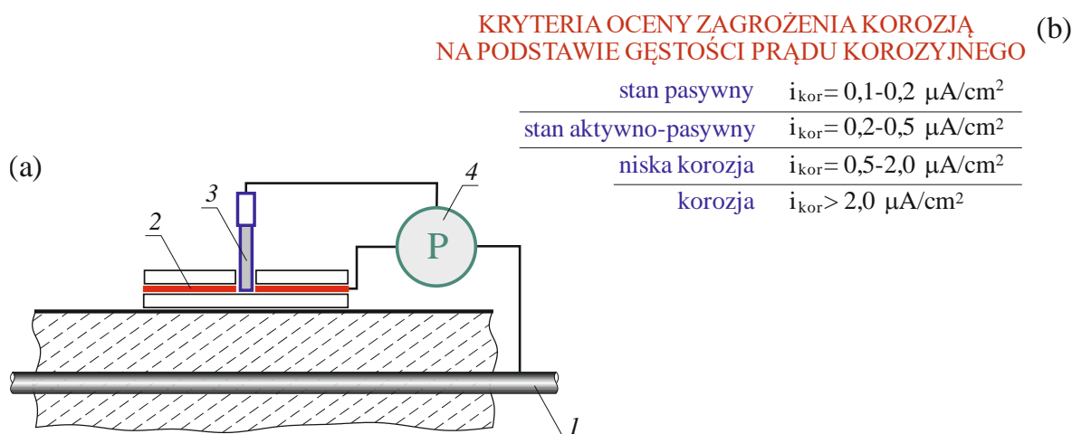
Rys. 3. Pomiary polaryzacyjne gęstości prądu korozyjnego na stalowym zbrojeniu w betonie: (a) układ pomiarowy, (b) kryteria oceny wyników pomiarów
