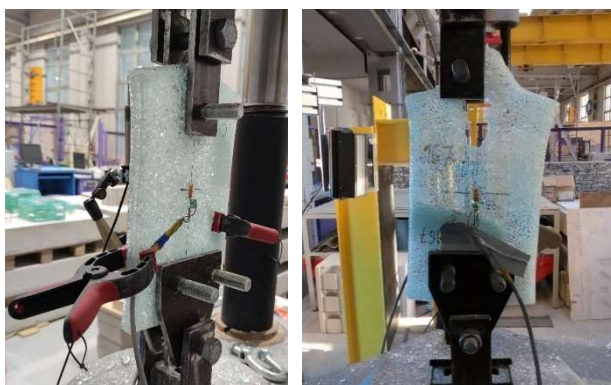
Rys. 4. Próbkę w momencie zarysowania szkła i całkowita utrata nośności
