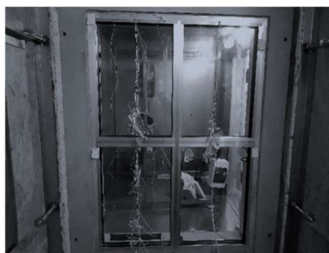
Rys. 2. Przegroda z badanymi zestawami szybowymi
