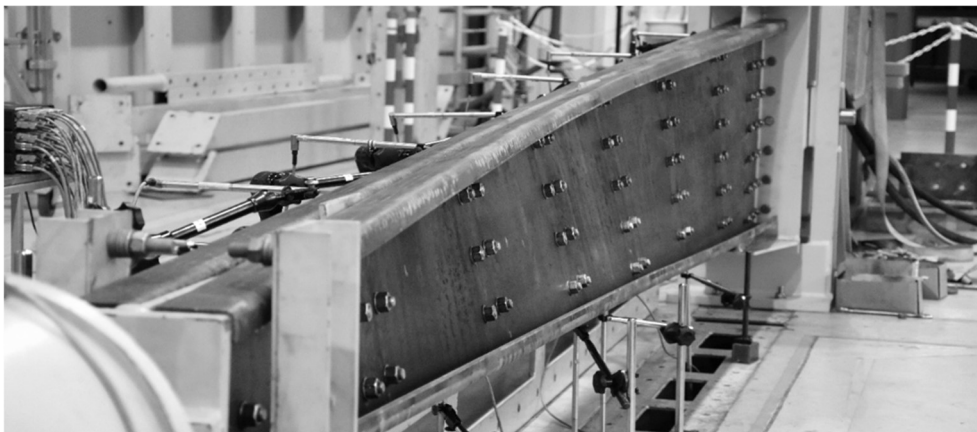
Rys. 4. Zwichrzenie elementu S-8
