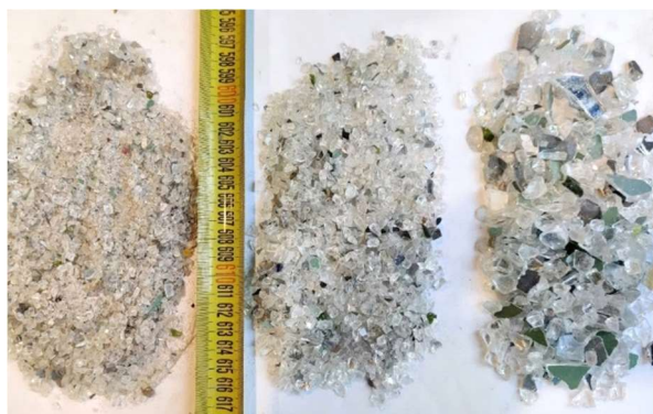
Rys. 1. Szkło frakcjonowane, frakcje: 0/2 mm; 2/5 mm; 5/16 mm
