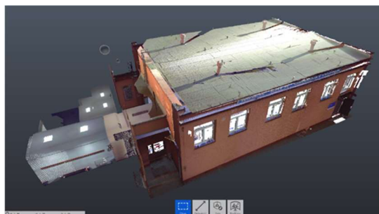
Rys. 1. Połączona chmura punktów w programie ReCap Pro inwentaryzowanego obiektu
