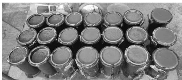
Rys. 1. Próbki o różnych konsystencjach (od K1 – skrajnie na lewo po K7 – skrajnie na prawo)
