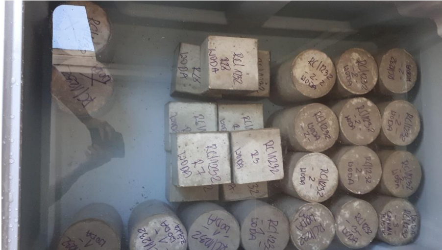
Rysunek 79. Pielęgnacja próbek w warunkach normowych
