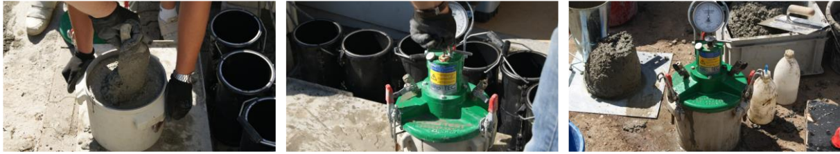
Rysunek 76. Pomiar zawartości powietrza mieszanki betonowej metodą ciśnieniową
