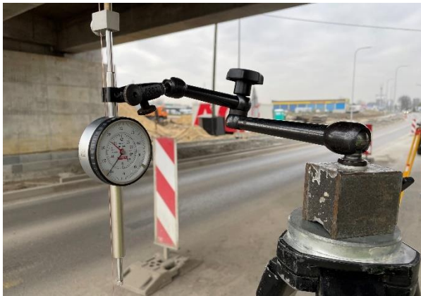
(a) pomiar przemieszczeń czujnikami zegarowymi
