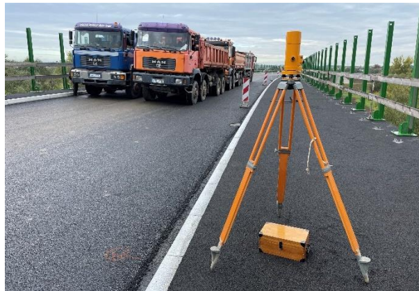
(b) pomiar przemieszczeń za pomocą niwelacji precyzyjnej
