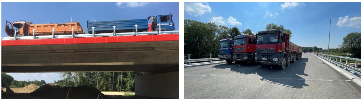
Rysunek 93. Próbne obciążenie obiektu MD-1
