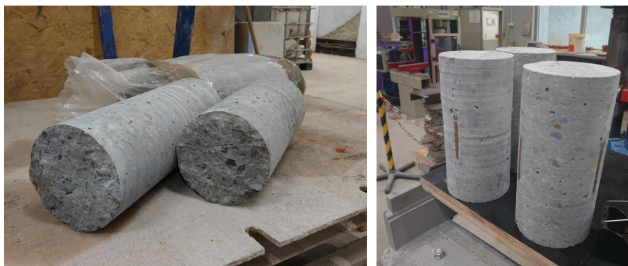
Rysunek 78. Odwierany rdzenie oraz przygotowane z nich próbki do badań
