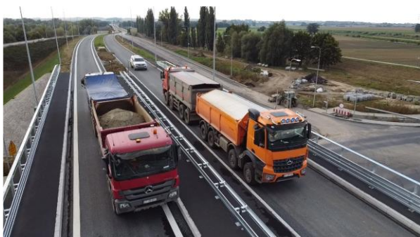
Rysunek 87. Pojazdy obciążające po wjeździe na badane objekty
