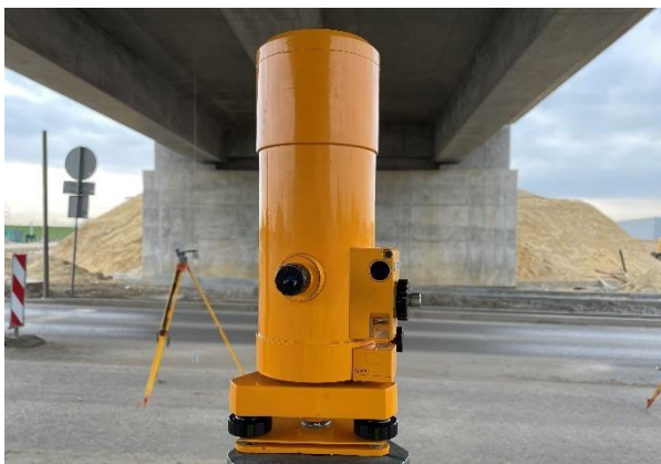
(c) pomiar osiadania podpór za pomocą niwelacji precyzyjnej
