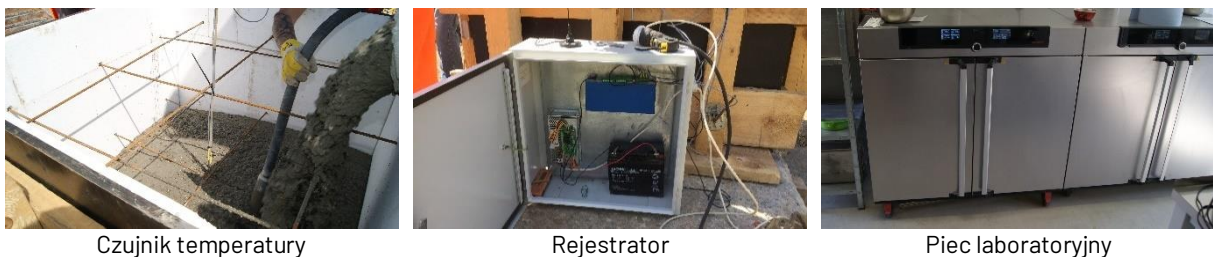
Rysunek 74. Elementy systemu odwzorowania warunków dojrzewania betonu
