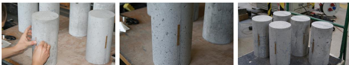
Rysunek 82. Proces naklejania tensometrów elektrooporowych
