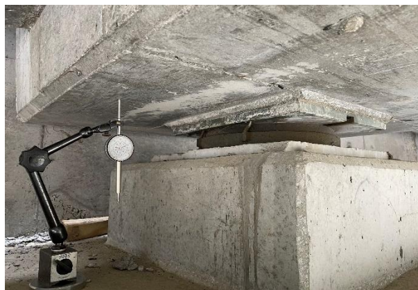
(d) pomiar zgniotu łożysk czujnikami zegarowymi
