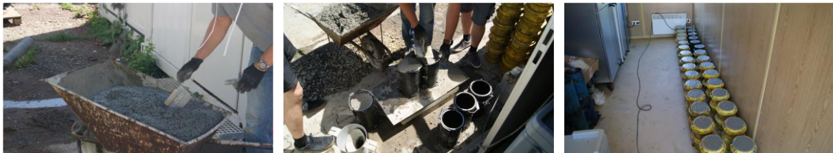
Rysunek 77. Formowanie próbek do badań laboratoryjnych
