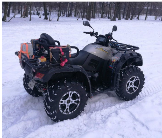
Fig. 8.1. Experimental off-road vehicle with MR dampers and suspension control system Rys. 8.1. Eksperymentalny pojazd terenowy z tłumikami MR i systemem sterowania zawieszeniem Source: Own photo, 2017.
