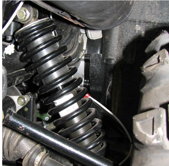
Fig. 8.3. A shock-absorber with MR damper installed in the experimental off-road vehicle Rys. 8.3. Amortyzator z tłumikiem MR zamontowany w eksperymentalnym pojeździe terenowym Source: Own photo.
