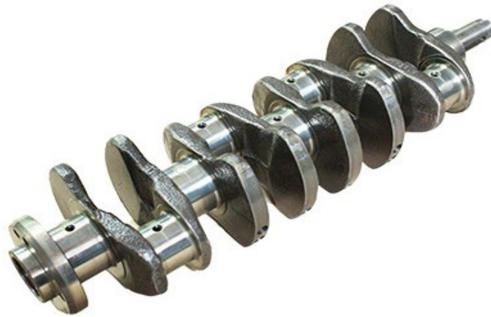
Rys. 133. Wał korbowy silnika spalinowego czterocylindrowego Fig. 133. The crankshaft of a four-cylinder internal combustion engine
