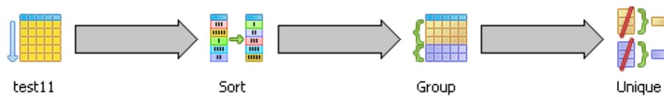
Rys. 9. Plan wykonania zapytania Z5 w bazie PostgreSQL
