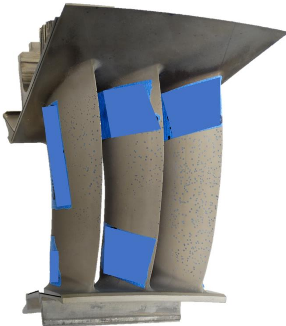
Rys. 46. Kierownica stopnia pierwszego po próbie silnikowej (badania własne).
