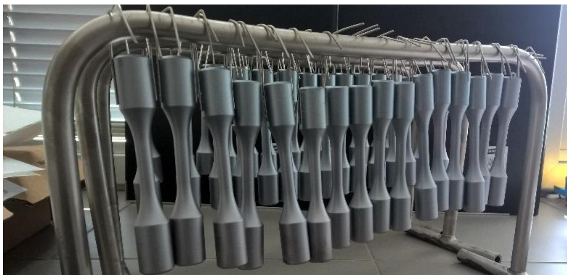
Rys. 89. Wygląd warstwy aluminikowej na próbkach do badań zmęczeniowych po procesie wyjściowym.
