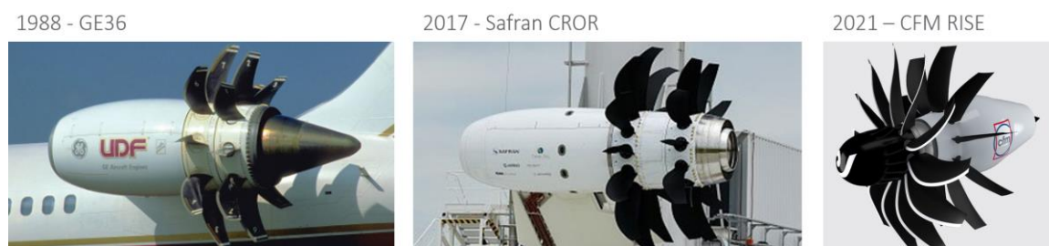
Rys. 3. Koncepcja architektury nowego silnika CFM RISE wraz z jego prekursorami. [3]
