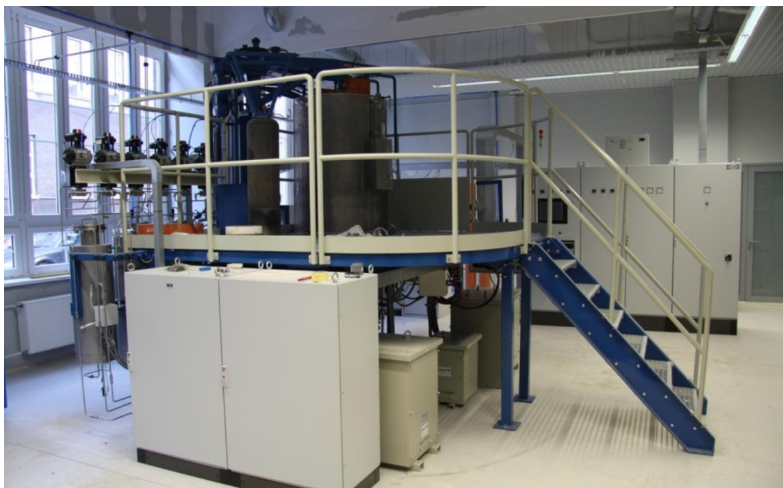
Rys. 50. Instalacja do wytwarzania warstw ochronnych metodą VPA i CVD zlokalizowana w Politechnice Śląskiej.
