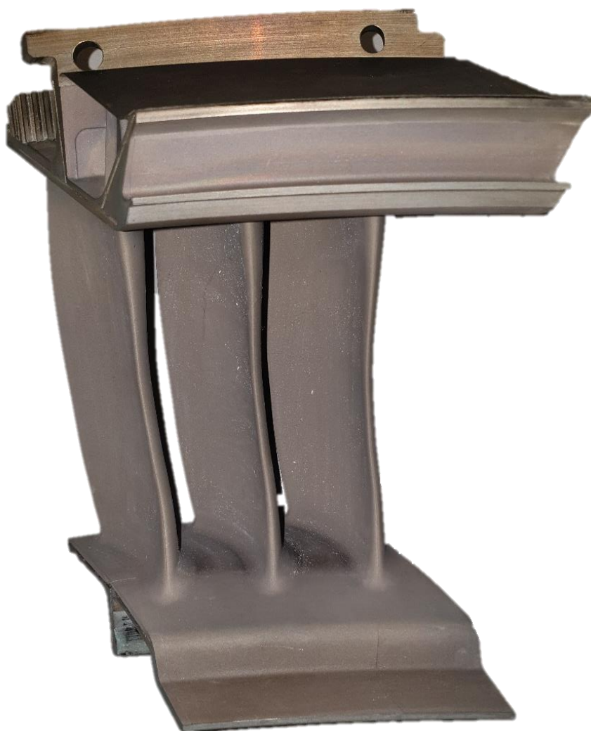
Rys. 45. Łopaska kierująca stator stopnia pierwszego turbiny niskiego ciśnienia silnika turbowentylatorowego nowej generacji GE9X.
