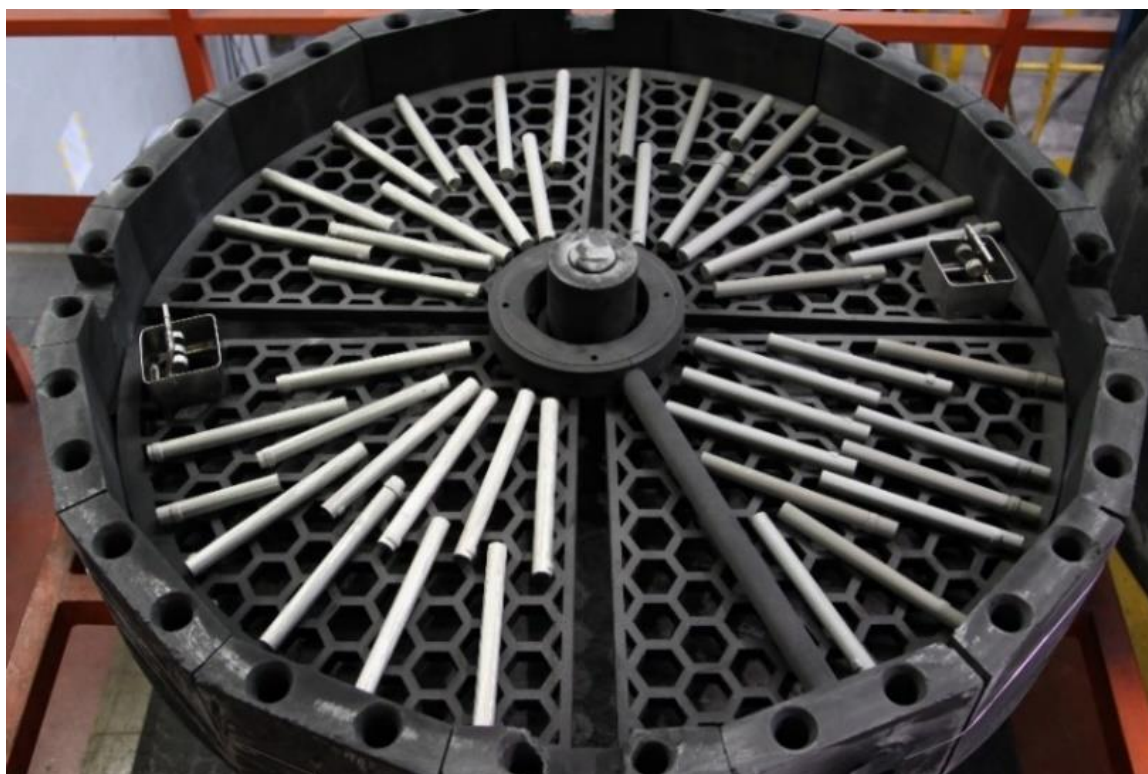
Rys. 55. Ułożenie prętów z materiału René N5 w piecu do aluminowania.
