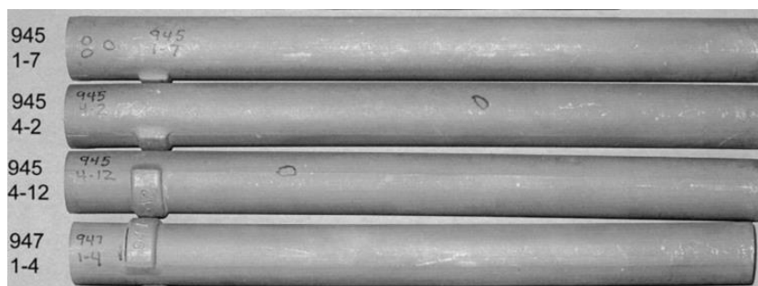
Rys. 69. Wygląd dostarczonego do badań materiału Rene’N5 w postaci prętów.
