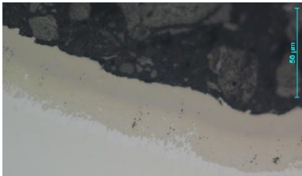
Rys. 103. Mikrostruktura warstwy aluminidkowej wytworzonej w otworze o średnicy 0,64 mm.
