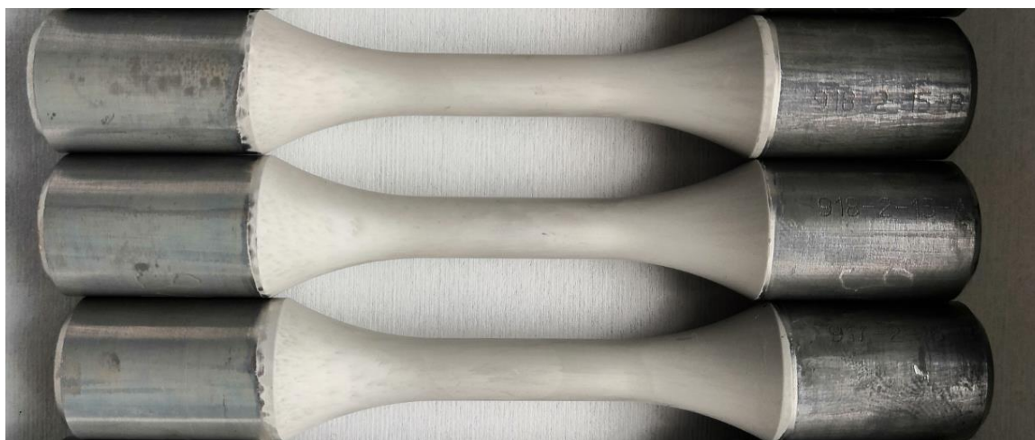
Rys. 115. Wygląd próbek po procesie galwanicznym i obróbce cieplnej.
