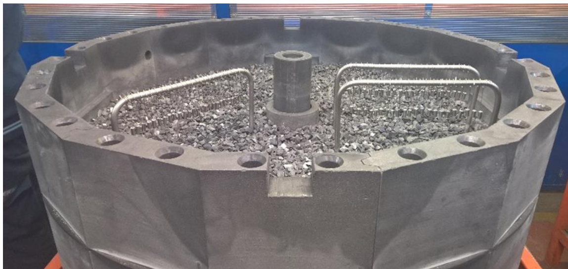
Rys. 80. Rozlokowanie próbek do badań utleniania na poziomie do aluminizacji, Avio Polska.
