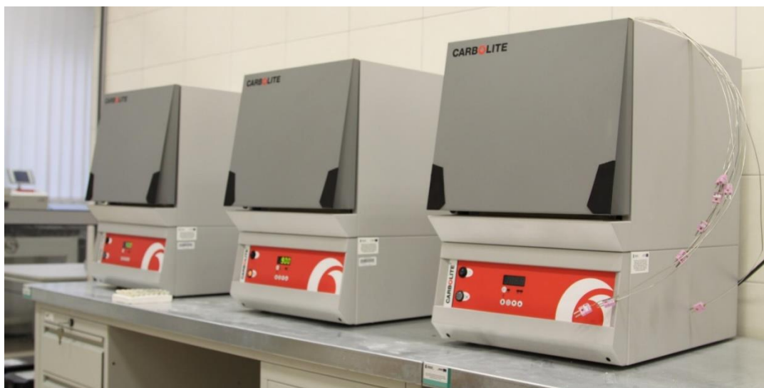
Rys. 63. Stanowisko do badań utleniania wyposażone w piece Carbolite CWF 13/13.
