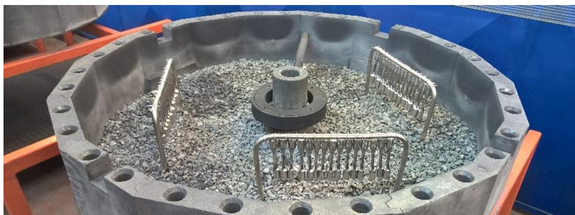
Rys. 88. Rozlokowanie próbek do badań zmęczeniowych na poziomie do aluminizacji.
