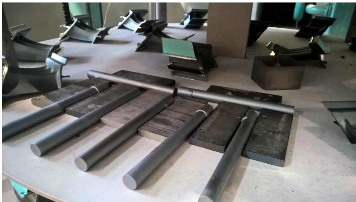
Rys. 57. Ułożenie prętów z materiału René N5 podczas obróbki dyfuzyjnej oraz końcowego starzenia.
