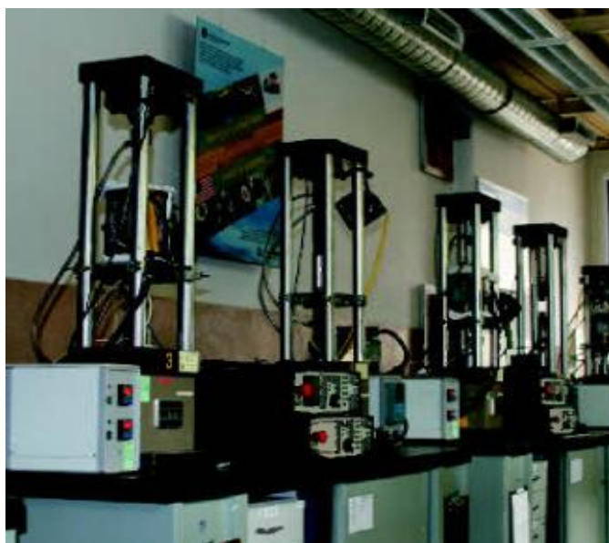
Rys. 67. Stanowiska do niskocyklowych badań zmęczeniowych [LCF] w Instytucie Lotnictwa [87].
