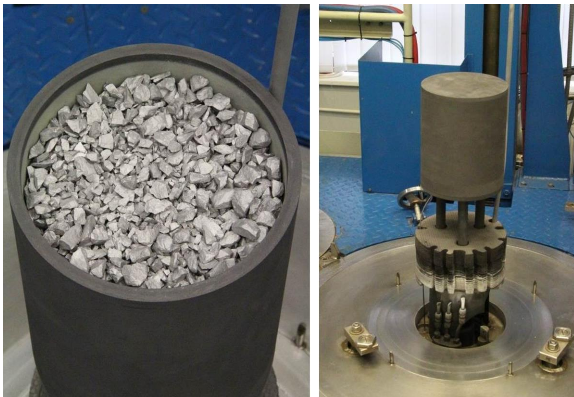
Rys. 51. Wygląd oprzyrządowania grafitowego do dyfuzyjnych procesów wytwarzania warstw ochronnych metodą VPA.
