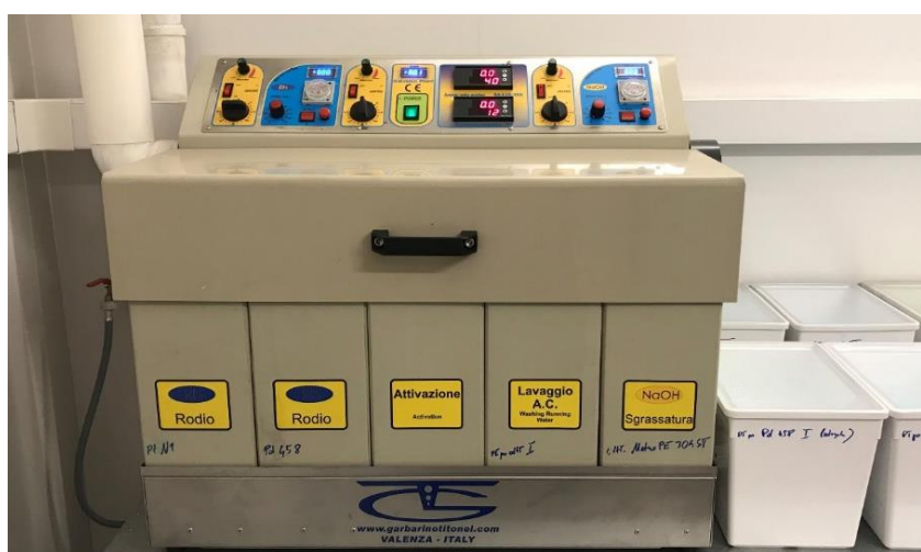
Rys. 113. Stanowisko i linia do procesów galwanicznych w skali laboratoryjnej zlokalizowane w Politechnice Śląskiej.
