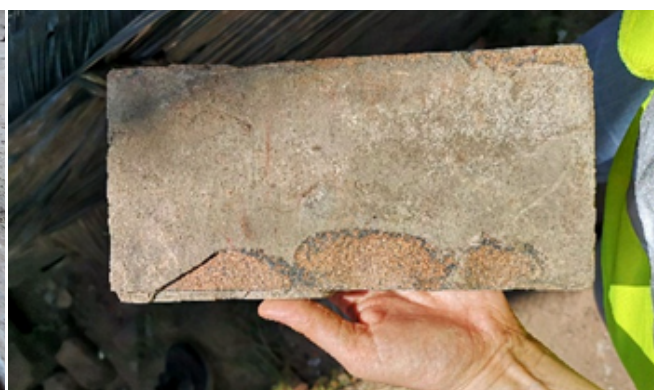
Ilustracja 86. Z prawej strony: Inwestycja Fuzja Łódź, 2021, cegła klinkierowa po procesie odzysku z bud. E2; następnie oczyszczona i użyta w tym samym budynku. Źródło: Materiały Medusa Group, zdjęcie Sandra Przepiórkowska
