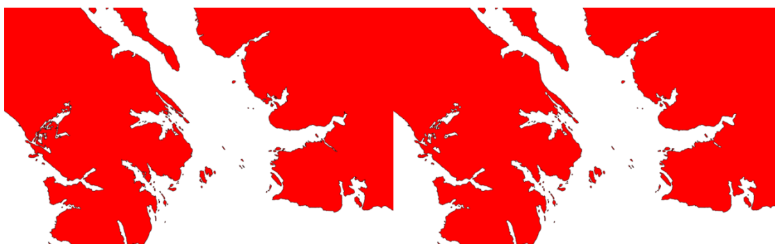
Rys. 14. Po lewej – mapa przed operacją zamknięcia, po prawej – mapa po zamknięciu elementem strukturalnym 1
