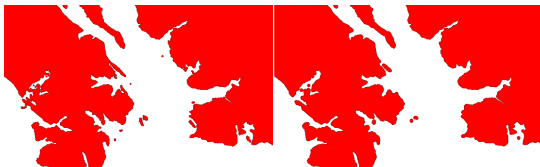
Rys. 5. Po lewej – mapa po otwarciu elementem strukturalnym 2, po prawej – mapa po otwarciu elementem strukturalnym 4
