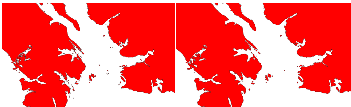
Rys. 4. Po lewej – mapa przed operacją otwarcia, po prawej – mapa po otwarciu elementem strukturalnym 1
