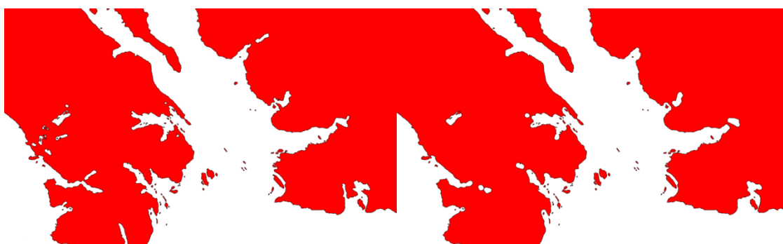
Rys. 15. Po lewej – mapa po zamknięciu elementem strukturalnym 2, po prawej – mapa po zamknięciu elementem strukturalnym 4
