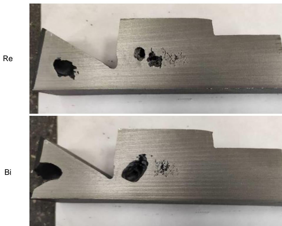
Rys.94. Zdjęcia wad odlewów schodkowych po przecięciu dla poszczególnych modyfikatorów
