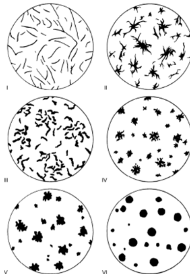
Rys.1. Klasyfikacja kształtu cząstek grafitu z żeliwa, zgodnie z normą DIN-EN-ISO 9445-1:2008 [4]
