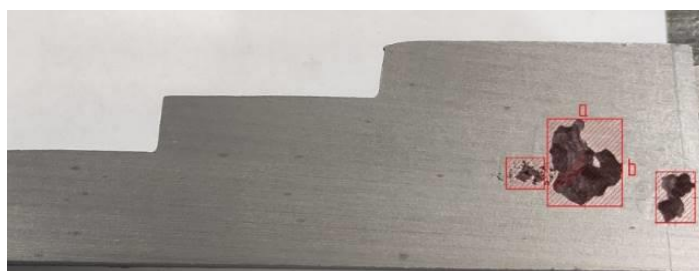
Rys. 84. Pomiar powierzchni wad skurczowych po przecięciu odlewu schodkowego
