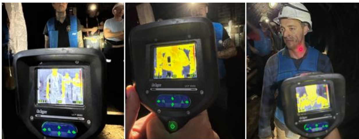
Rys.7.14. Przykładowe przyrosty temperatury dla ludzi ubranych w standardowe ubranie robocze i kamizelki chłodzące z wkładami żelowymi.
