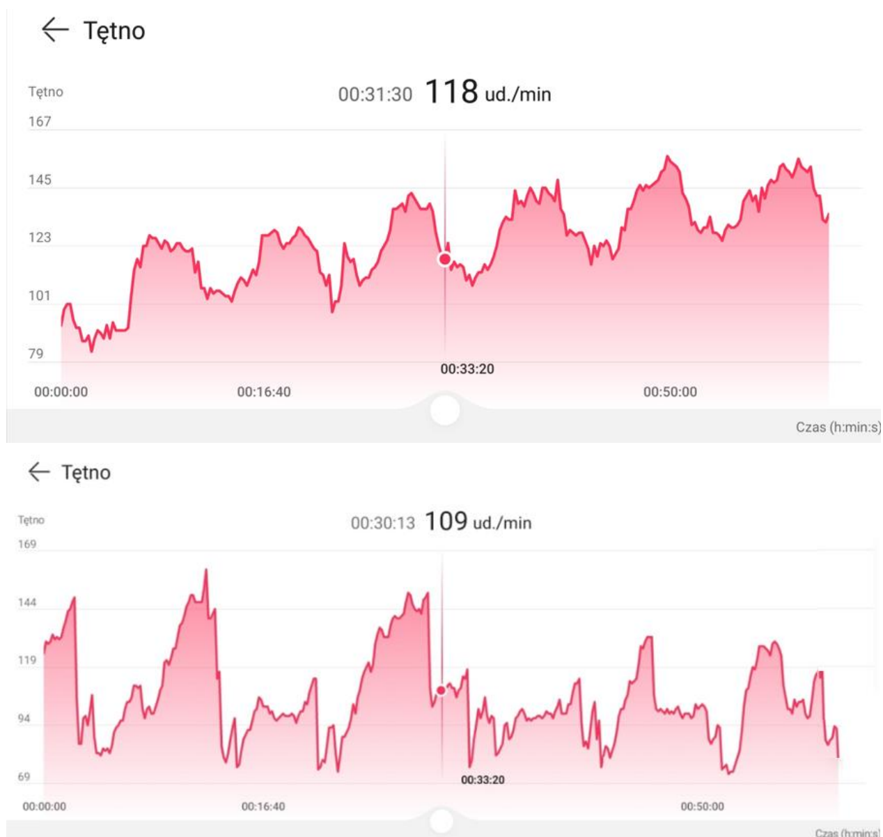
Rys. 7.7 Przykładowy wykres tetna ratownika nr 2 bez kamizelki (wykres górny) i w kamizelce (wykres dolny) przy temperaturze 34°C i wilgotności 90%
