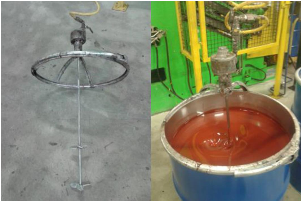
Rys. 9. Wyremontowane mieszadło do lakieru Fig. 9. Renovated to paint stirrer
