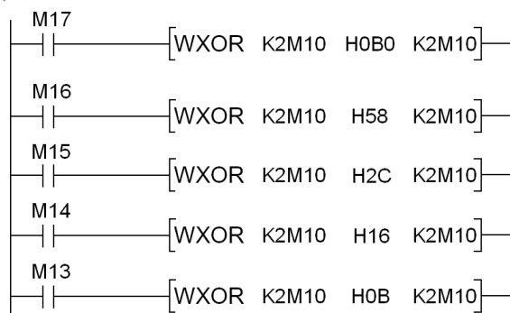
Rys. 7. Dzielenie dwóch wielomianów: (a) zapis operacyjny, (b)-(e) operacja na markerach
