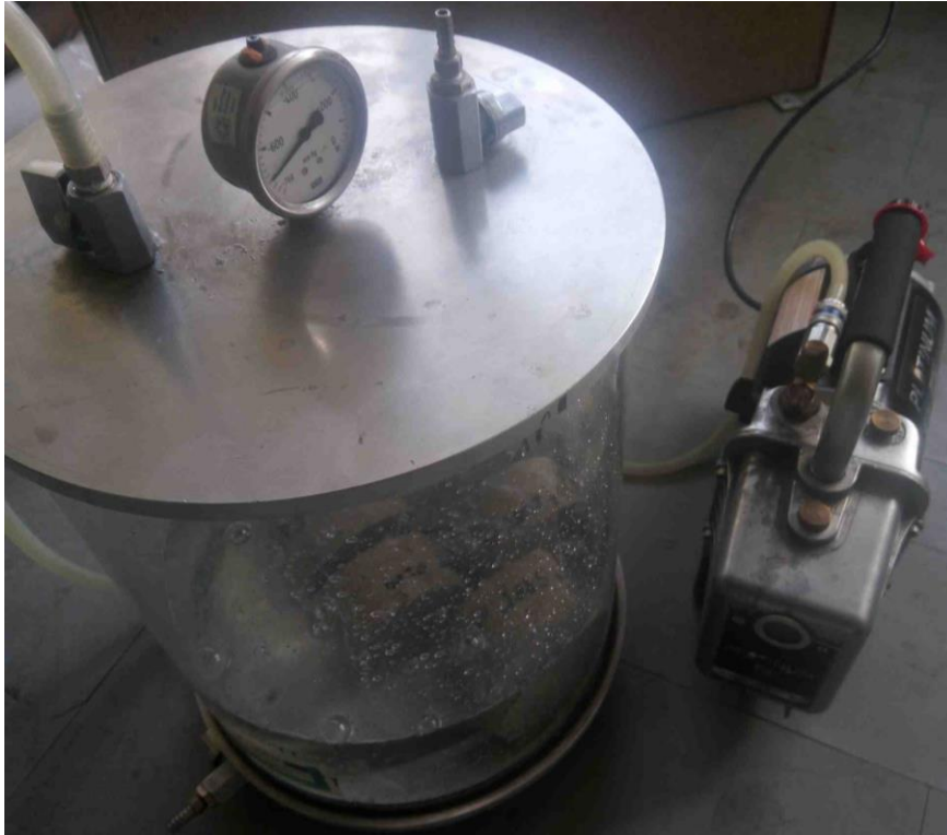
Rys. 39. Próbki umieszczone w pojemniku próżniowym
