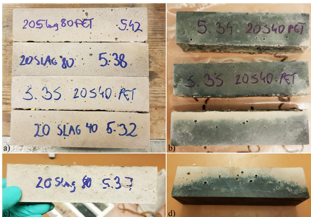
Rys. 126. Belecзки zapraw zawierających GGBFS: a) po 28 dniach od wykonania; b) po 24 godzinach od wykonania – 20S40 + P; c i d) po 24 godzinach od wykonania – 20S80
