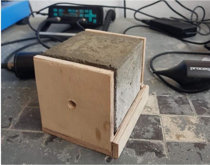
Rys. 36. Badanie betonoskopem próbki sześcienniej, powierzchnia A
