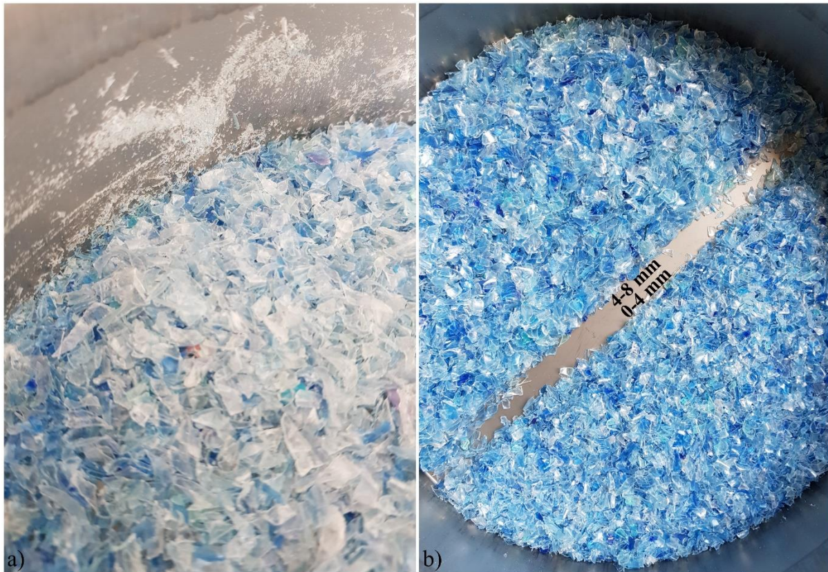
Rys. 32. Frakcje PET: a) 0-4 mm, b) 50% 0-4 mm + 50% 4-8 mm
