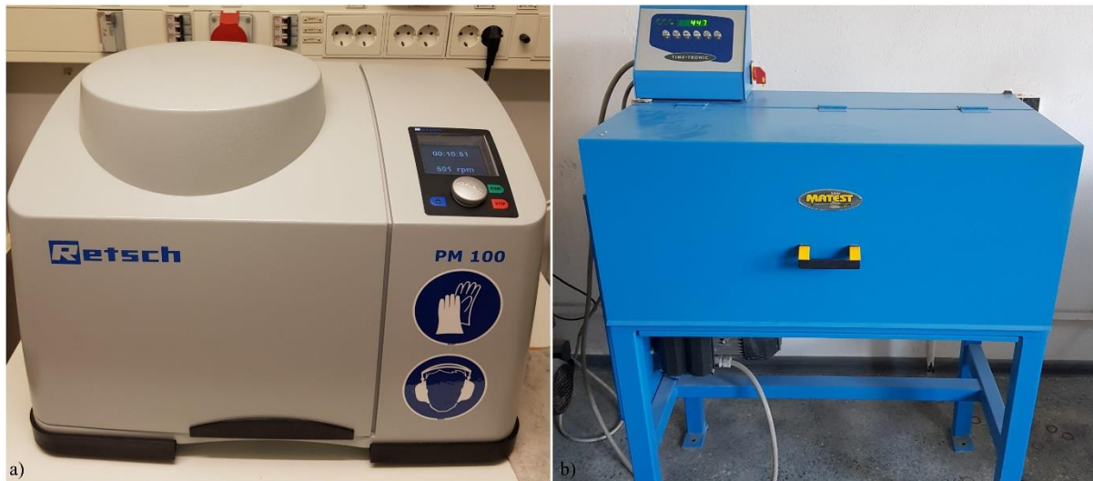
Rys. 40. a) Planetarny młyn kulowy; b) Bęben Micro-Devala
