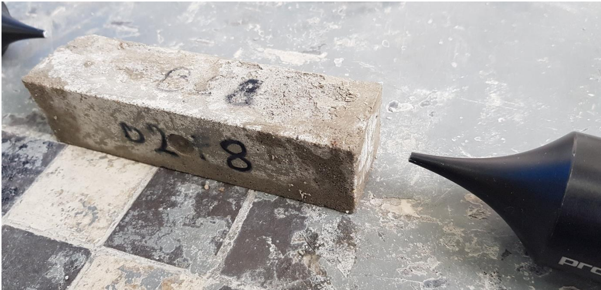
Rys. 35. Badanie belek za pomocą betonoskopu
