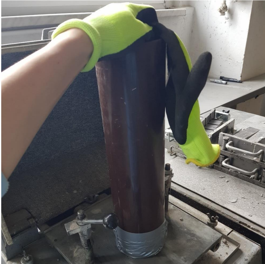
Rys. 37. Zagęszczanie zaprawy przeznaczonej do badania przepuszczalności chlorków
