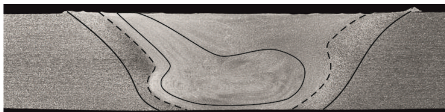
Rys. 3. Makrostruktura złącza FSW z zaznaczonymi obszarami charakterystycznymi Fig. 3. Macrostructure FSW joints with marked characteristic areas
