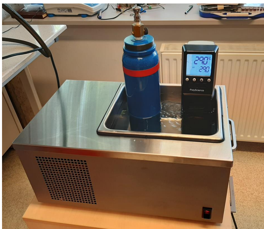
Rys. 5.5. System chłodzenia zastosowany w instalacji
