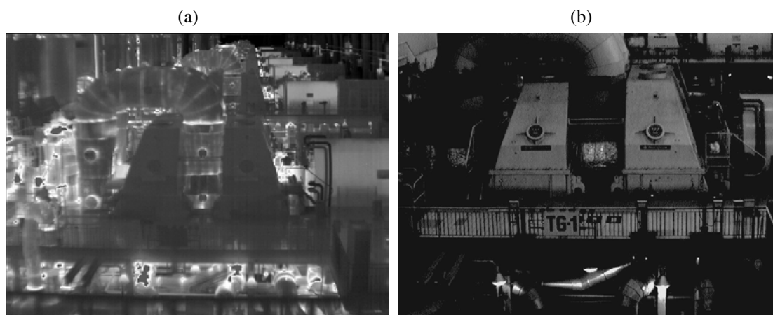
Rys. 5.60. Przykładowy obraz termograficzny 5.60(a) i wizyjny 5.60(b) zarejestrowane w trakcie obserwacji turbogeneratora energetycznego
