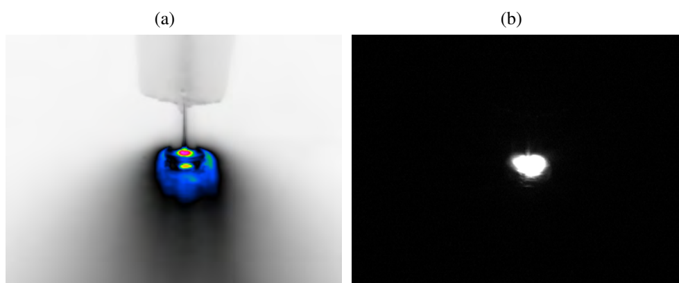
Rys. 5.73. Przykładowy obraz termograficzny (a) i wizyjny (b) zarejestrowane w trakcie obserwacji procesu spawania
