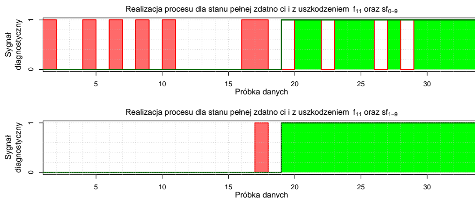
Rys. A.16: Porównanie wpływu stanu funkcjonalnego sf_0 na liczbę generowanych fałszywych i prawdziwych alarmów.
