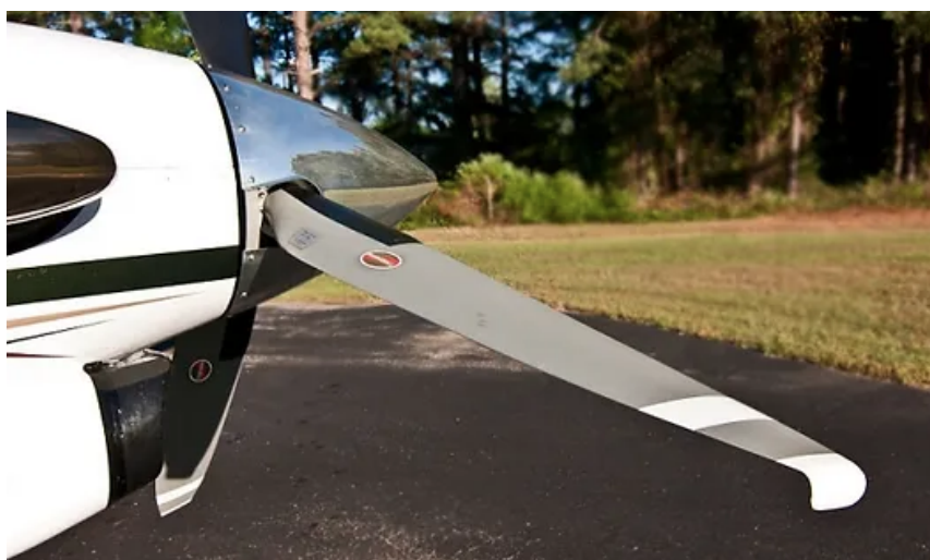
Rys 10.6 Śmigło Q-Tip z zagiętymi końcówkami łopat [7]
