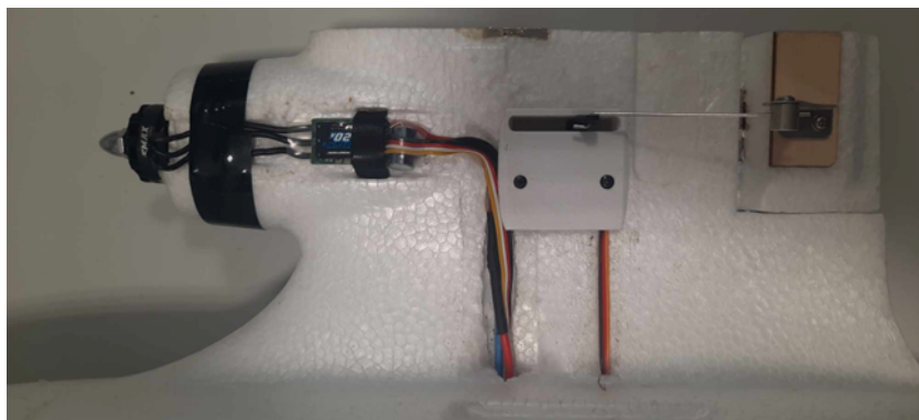
Rys. 5.11 Silnik BSP wraz ze sterownikiem ESC, serwomechanizmem oraz mechanizmem lotki
