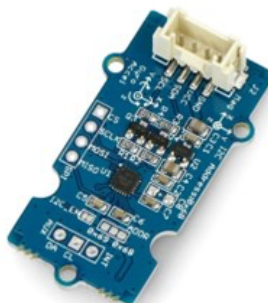
Rys. 3.3 Czujnik IMU bazujący na układzie MPU-9250 [10]
