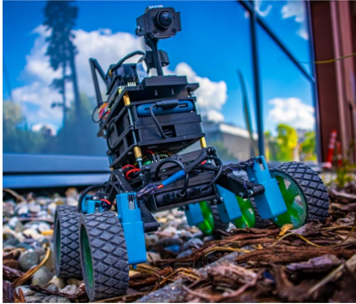
Rys. 2.2 Widok platformy robotycznej do nauki i rozwoju autonomicznych systemów sterowania w kontekście robotów eksploracyjnych
