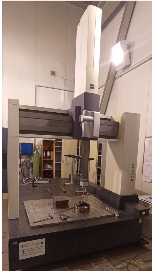
Rys 10.8 Ocena metrologiczna próbek za pomocą maszyny pomiarowej współrzędnościowej Zeiss Accura 2
