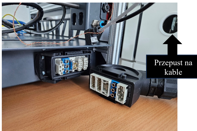
Rys 9.4 Złącze przemysłowe testera do ekranów HMI.
