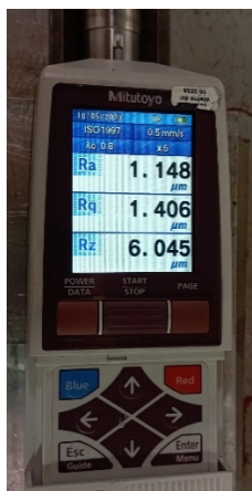
Rys 10.14 Chropowatościomierz Mitutoyo SJ-210 z zadanymi parametrami
