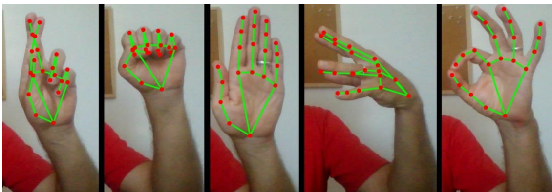
Rys. 6.3 Przykład detekcji ruchu ręki za pomocą kamery wideo [5]
