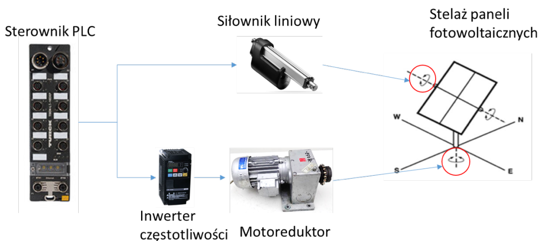
Rys 3.5. Elementy układu pozycjonowania nadążnego stelaża paneli fotowoltaicznych
