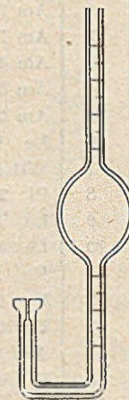
Rys. 4. Stalagmometr do pomiaru napięć na granicy ropa naftowa / roztwory wodne soli
