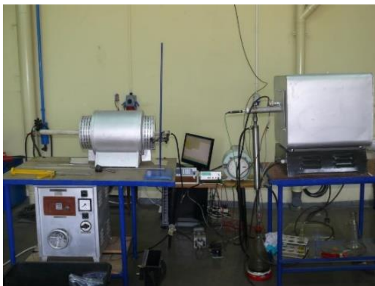
Rys. 6.14. Ogólny widok pieca do pirolizy z systemem kontrolno- pomiarowym DL1 (Zakład Hutnictwa Łukasiewicz – IMN).
