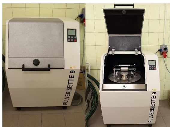
Rys. 6.10. Młyn tarczowo-wibracyjny Fritsch pulverisette 9 z zestawem dysków mielących
