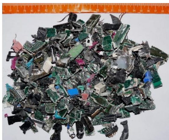
Rys. 9.3. Widok próbki średniej WPCB K1 przed procesem rozdziału na WPCB K1-T i WPCB K1-M
