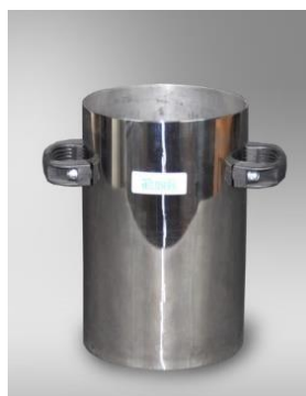
Rys. 6.7. Cylinder 1 dm 3 do pomiaru gęstości nasypowej i jamistości.
