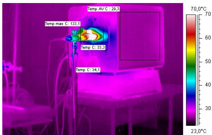
Rys. 6.21. Rozkład temperatur tył pieca – po 120 minutach procesu.
