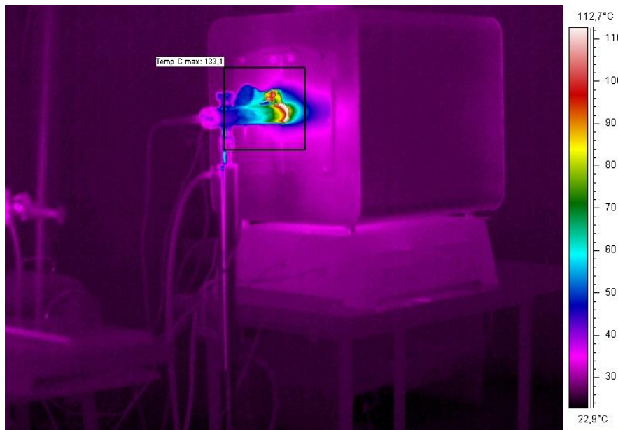
Rys.6.22. Strefa odlotowa gazów pizolitycznych – pomiar ciągły 120 min.
