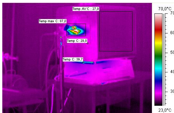
Rys. 6.17. Rozkład temperatur tył pieca i lewa ściana – piec po 60 minutach pracy.
