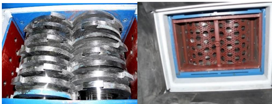
Rys. 6.3. Rozdrabniacz nożowy Moco AZ5F widok z góry na noże tnące oraz od dołu na sito separujące
