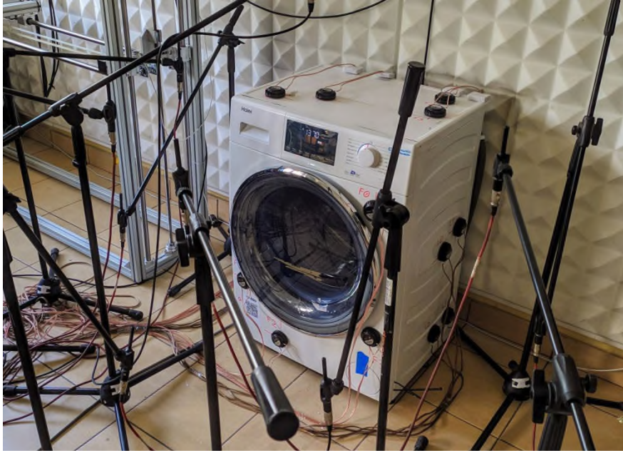
Fig. 1. A washing machine during a design of an active noise control system Rys. 1. Pralka podczas prac projektowych nad systemem aktywnej redukcji hałasu
