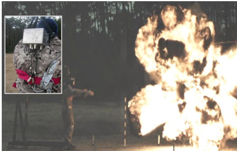
Fig. 3. The use of an autonomous system to identify the impact of the blast shock wave on the human body [1, 2, 3] Rys. 3. Zastosowanie autonomicznego systemu do identyfikacji wpływu fali uderzeniowej wybuchu na ciało człowieka [1, 2, 3]
