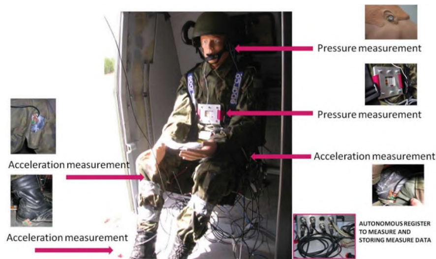
Fig. 1. The test stand for identifying the impact of impulse loads on the crew of special vehicles [4, 5] Rys. 1. Stanowisko badawcze do określenia wpływu obciążeń impulsowych na załogę pojazdów specjalnych [4, 5]
