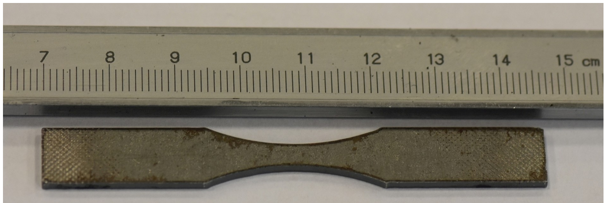
Rys. 5.13. Próbka klepsydryczna przygotowan dla procesu P w 1
