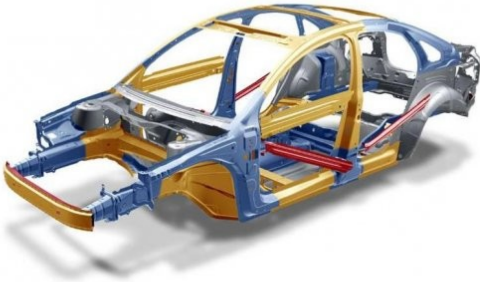
Rys. 1.1. Konstrukcja samonośna pojazdu. Kolor niebieski – stale o niskiej wytrzymałości, kolor żółty – stale o podwyższonej wytrzymałości, kolor czerwony stale AHSS [11]
