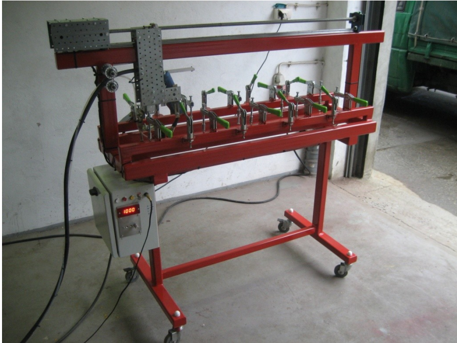
Rys. 5.1. Stół spawalniczy wykorzystany przy wykonywaniu próbek
