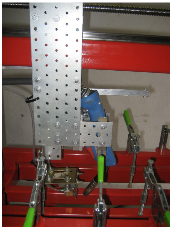
Rys. 5.4. Flansze regulujące położenie palnika i dyszy
