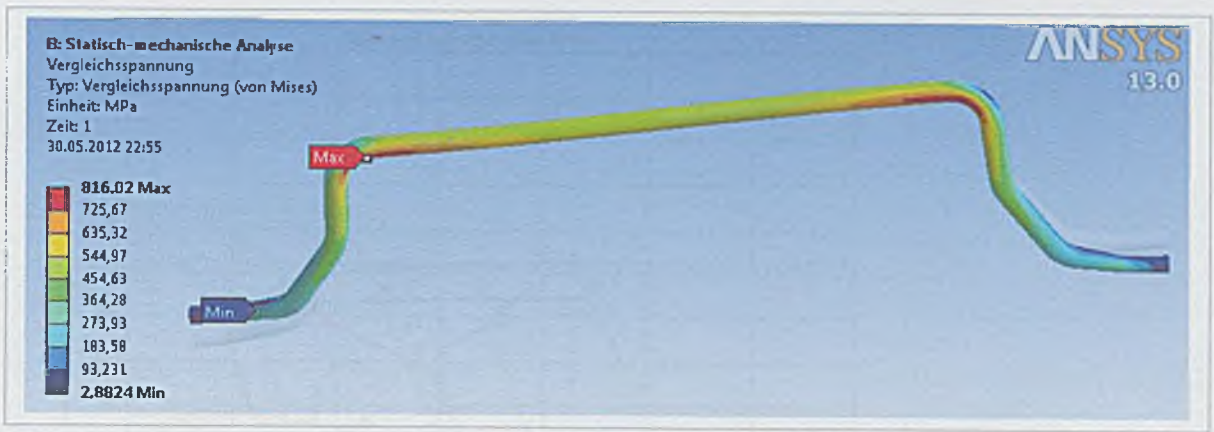
Rys. 10.15. Rozkład naprężeń w stabilizatorze giętym na gorąco, umiejscowienie maksymalnych naprężeń odpowiada pozycji przelomu zmęczeniowego, w promieniu gięcia (rys. 10.14)
