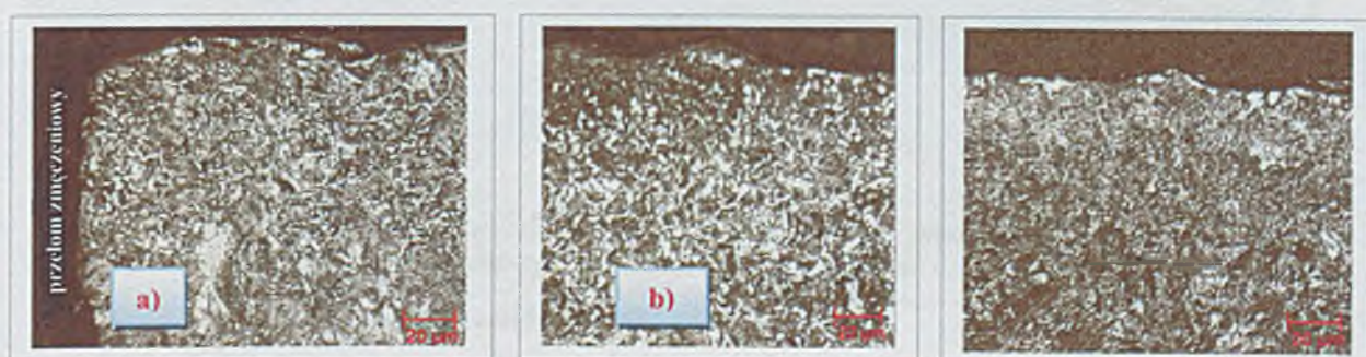
Rys. 10.12. Struktura metalograficzna stali w promieniu gięcia (przełomu zmęczeniowego) (rys. 10.10), ferryt przedeutektoidalny + martenzyt + szczątkowy bainit a) b)
