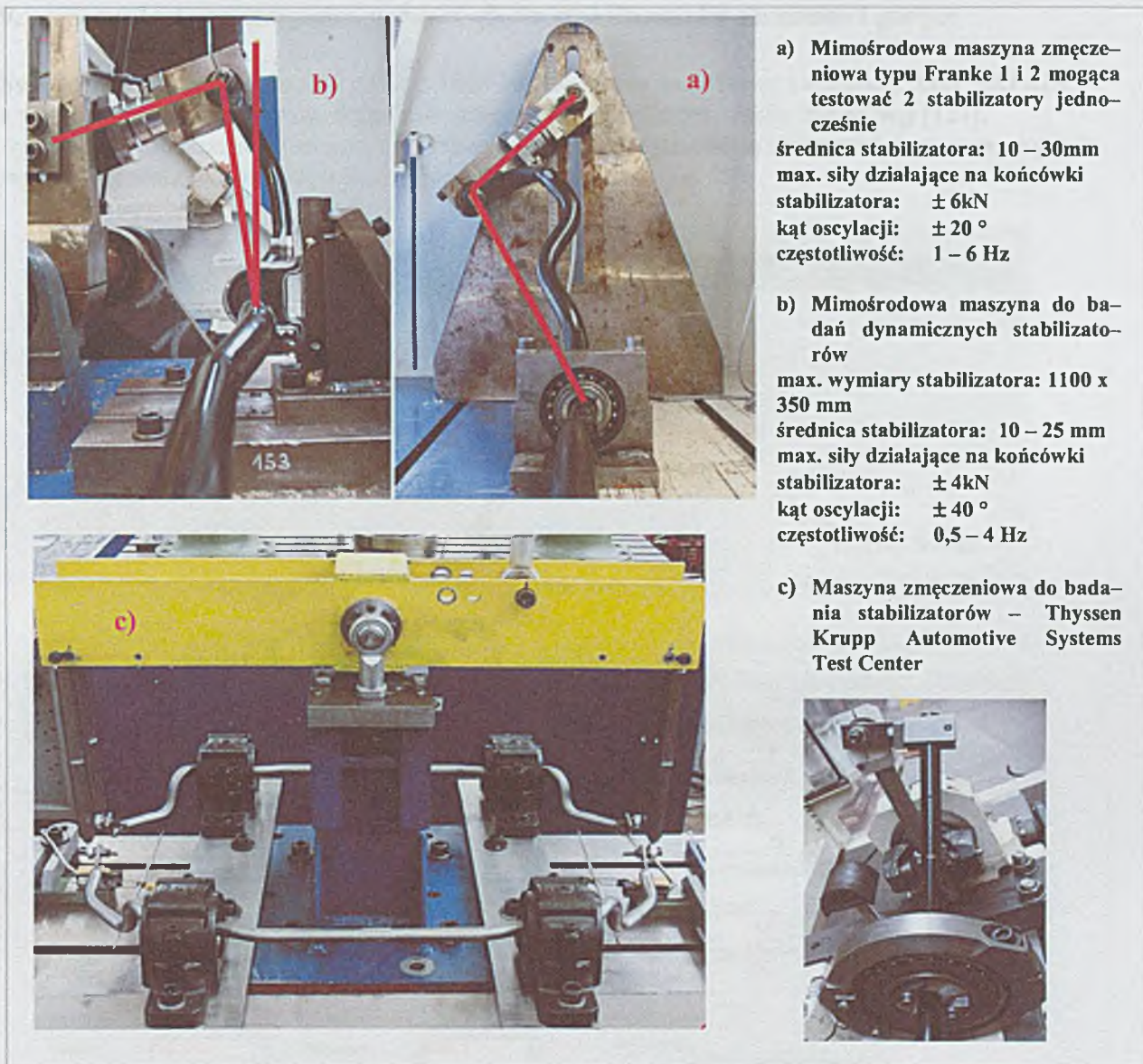
Rys. 8.2. Maszyny do badań wytrzymałościowych stabilizatorów (źródło TKF&S )
