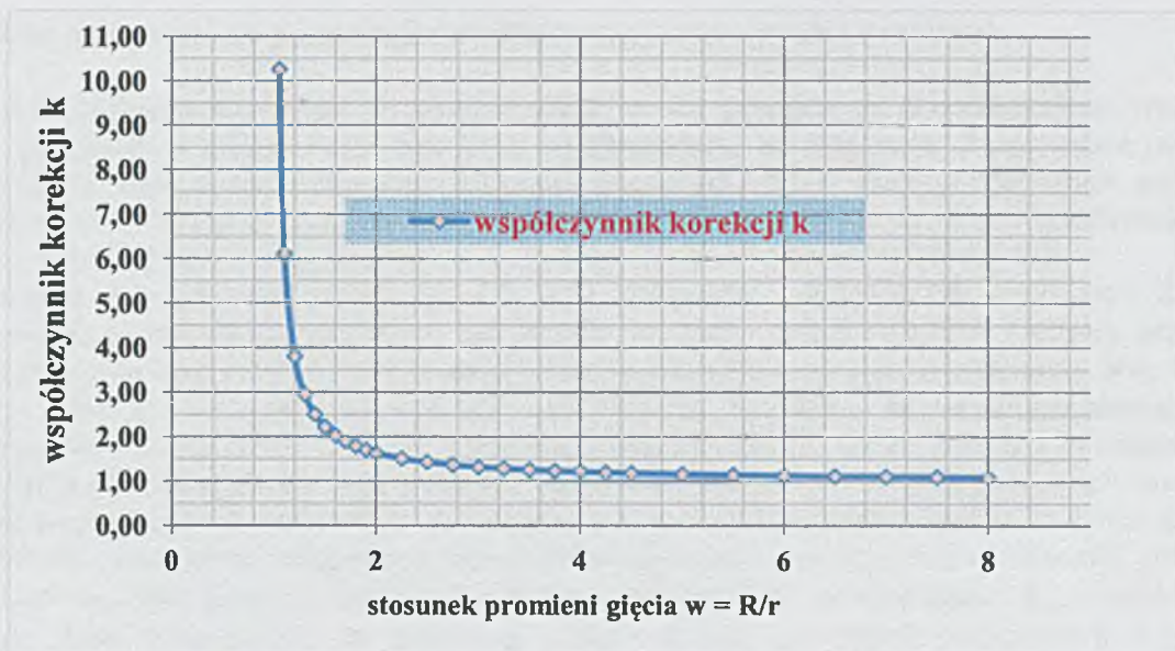
Rys. 2.17. Współczynnik korekcji naprężeń gnących w zależności stosunku promieni [134]
