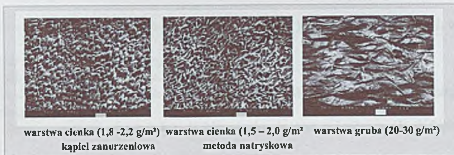
Rys. 2.51. Grubości powłok fosforanowych stosowanych w produkcji stabilizatorów
