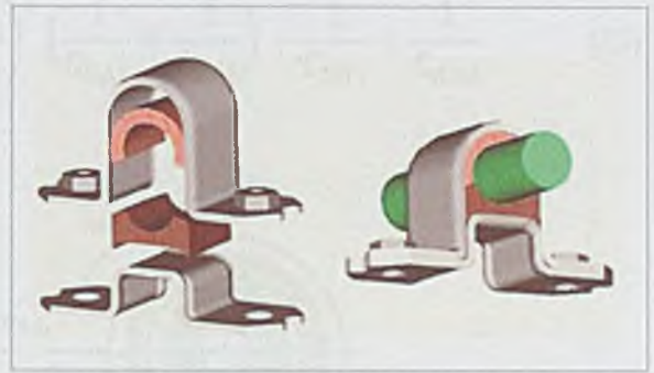
Rys. 2.10. Typowe łożysko stabilizatora samochodowego [11]
