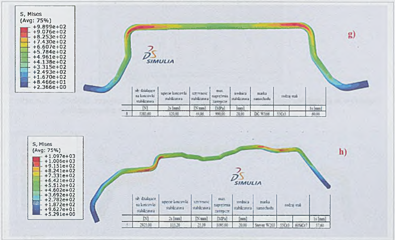
Rys. 6.2. Obliczenia MES różnych stabilizatorów zarówno masywnych jak i rurowych
