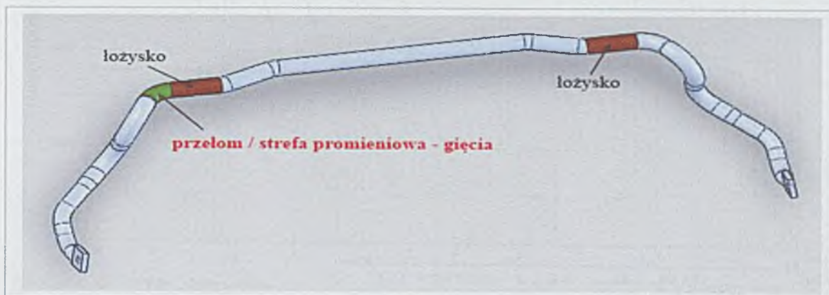
Rys. 10.10. Stabilizator rurowy gięty na gorąco, strefa promieniowa – przełomu zmęczeniowego została poddana szczegółowym badaniom metalograficznym
