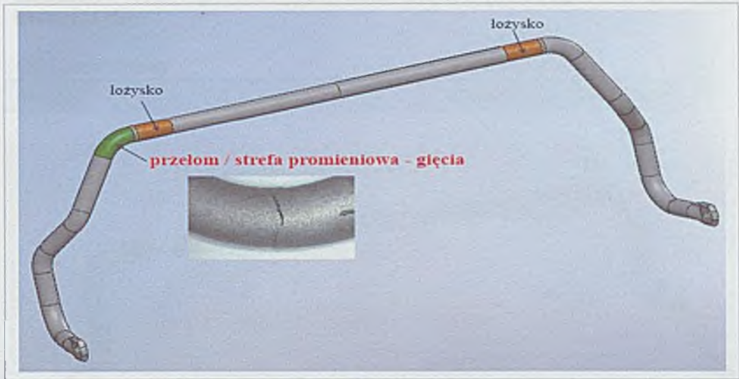
Rys. 10.4. Stabilizator rurowy gięty na gorąco, strefa promieniowa – przełomu zmęczeniowego została poddana szczegółowym badaniom metalograficznym
