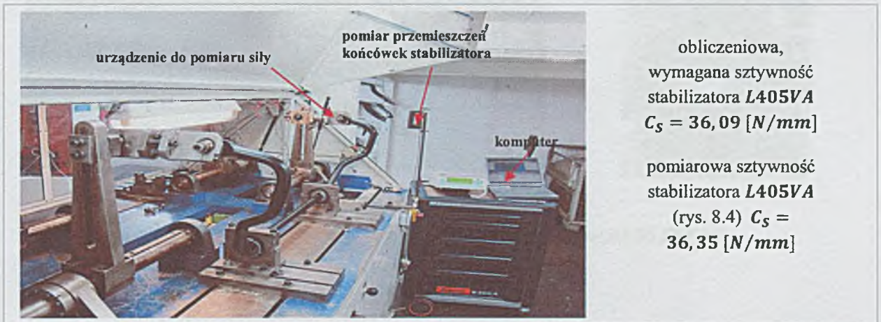
Rys. 8.1. Stanowisko pomiarowe sztywności stabilizatora (źródło TKF&S )
