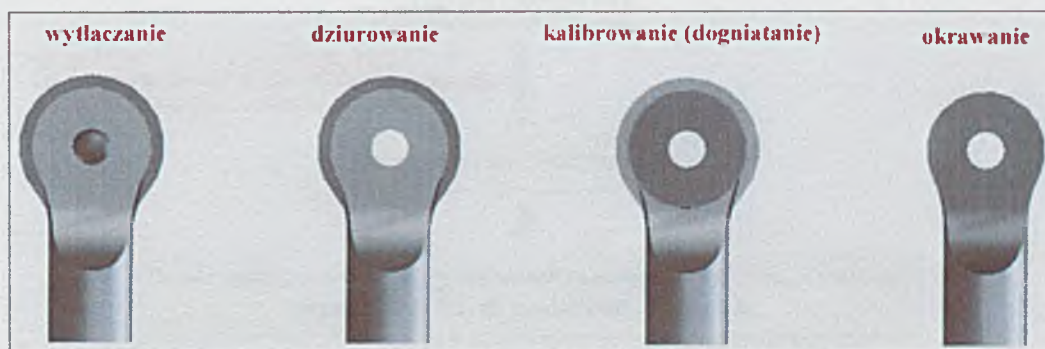
Rys. 2.61. Końcówki stabilizatora prętowego, masywnego po obróbce kształtowania [11] (źródło TKF&S )
