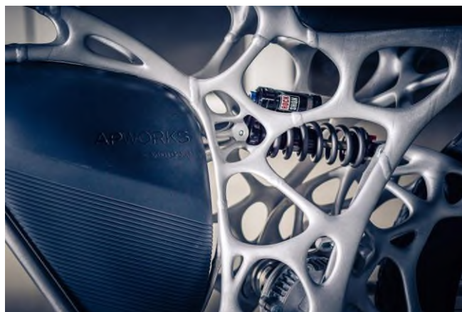
Rys. 37. Widoczne miejsca spawania wydrukowanych części ramy aluminiowej [82]
