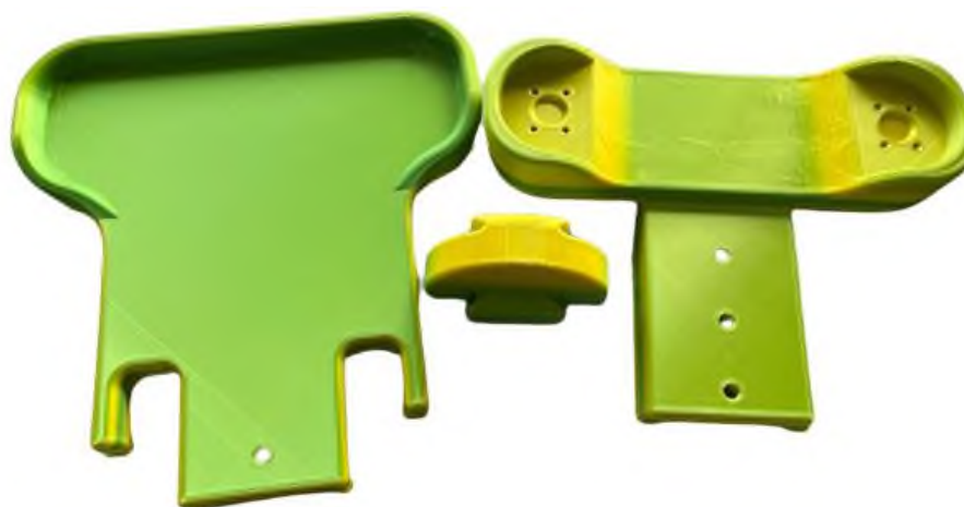
Rys. 80. Ponowny wydruk podnóżka, bazy kółek tylnych oraz łącznika
