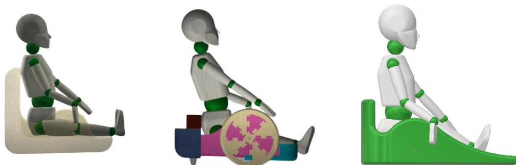
Rys. 44. Wirtualne testowanie ergonomii i sprawdzenie odpowiednich wymiarów dla różnych koncepcji pojazdu
