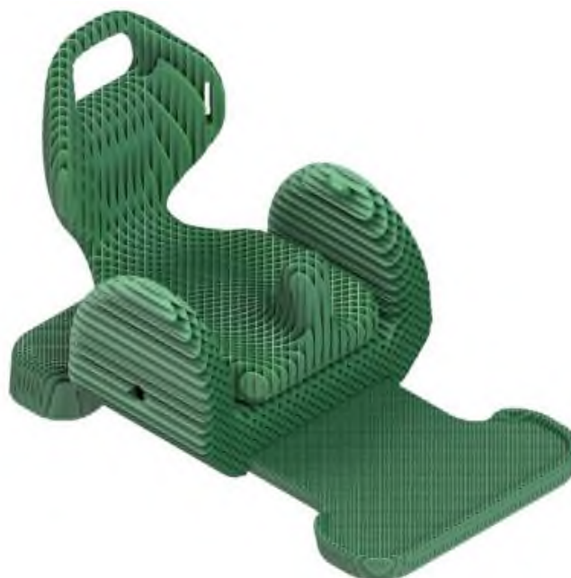
Rys. 109. Analiza modelu z wypełnieniem typu grid o gęstości 20%
