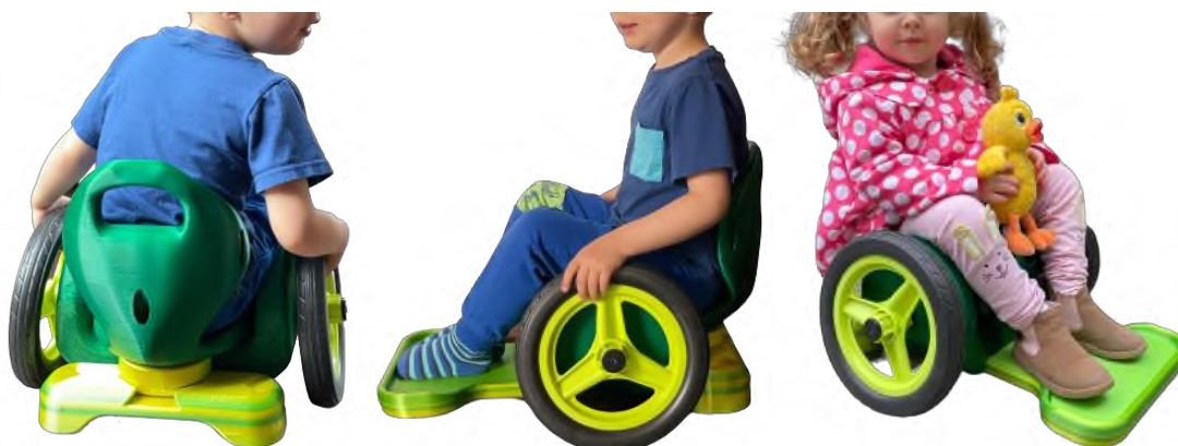
Rys. 81. Fizyczne testowanie prototypu z przeprojektowanym podnóżkiem
