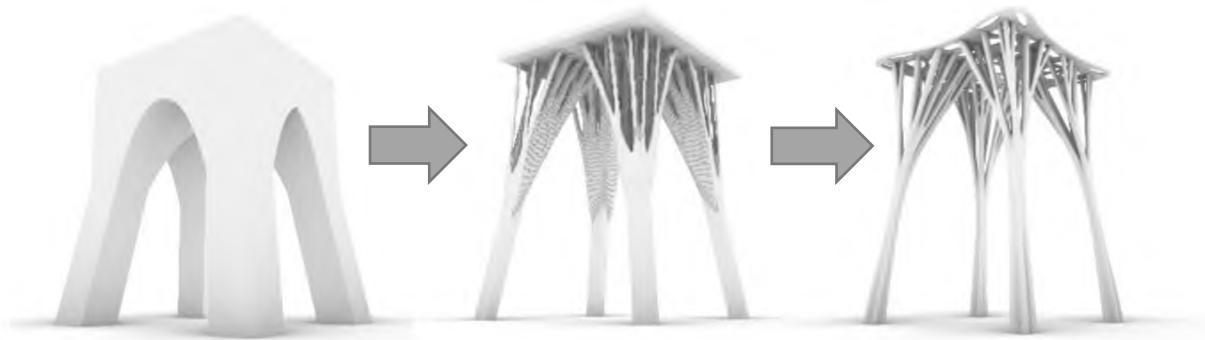
Rys. 23. Kolejne etapy optymalizacji konstrukcji pawilonu X-Form 1.0 [5]
