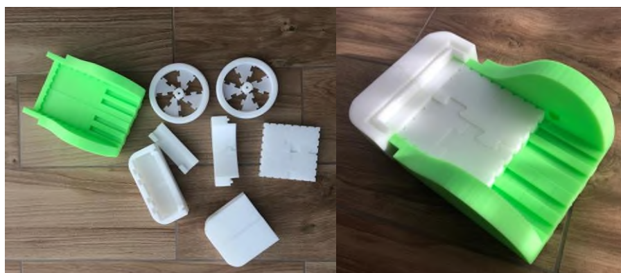
Rys. 46. Wydruk testowy połączeń wciskanych w podziałce 1:5
