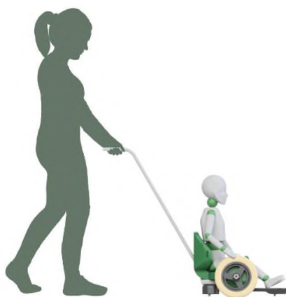
Rys. 92. Siła F_4 wywołana przez pchanie wózka z użytkownikiem
