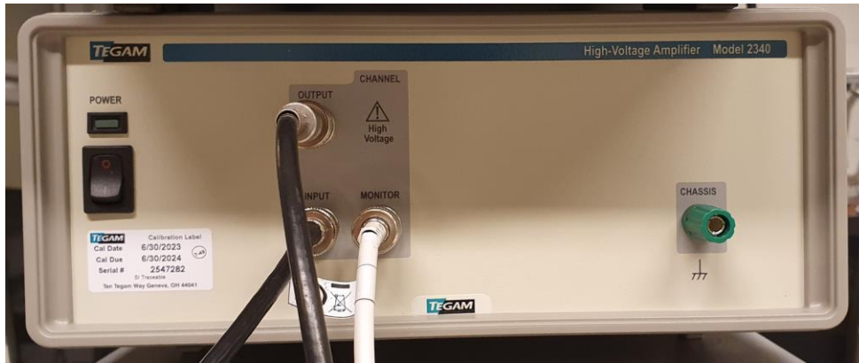
Rys. 6.24. Wzmacniacz TEGAM 2340 zastosowany w badaniu układów piezoelektrycznych
