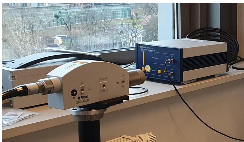
Rys. 6.6. Kontroler OFV-2570 oraz emiter OFV-574 wibrometru laserowego zastosowanego w badaniu
