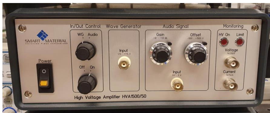
Rys. 6.5. Wzmacniacz HVA1500/50 firmy Smart Material użyty w badaniu układu piezoelektrycznego
