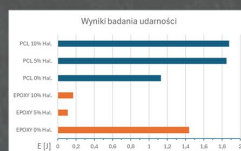
Porównanie pracy łamania próbek z PCL oraz żywicy epoksydowej z różną zawartością haloizytu
