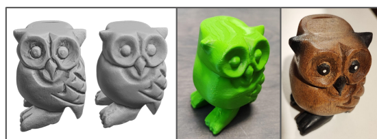
Rys. 1. Porównanie modeli skanowanych telefonem oraz skanerem ze światłem strukturalnym, model drukowany FFF oraz model rzeczywisty
