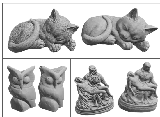
Rys. 3. Porównanie modeli skanowanych telefonem oraz skanerem ze światłem strukturalnym
