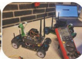
Rys. 5 Implementacja i badanie poboru prąd z ogniw wodorowych
