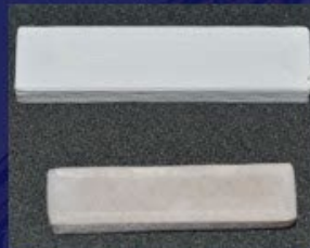
Rys. 1. Belki przeznaczone do zginania po wydruku i po spiekanii
