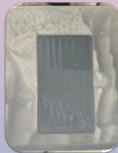
Zdj.2. Świeżo wydrukowany mold do układu.
