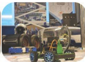
Rys. 4. Testy weryfikacyjne systemu sterowania bazującego na głębokiej sieci neuronowej
