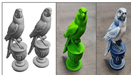
Rys. 2. Porównanie modeli skanowanych telefonem oraz skanerem ze światłem strukturalnym, model drukowany FFF oraz model rzeczywisty
