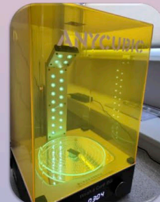
Zdj.3. Proces utwardzania moldu za pomocą promieni UV.
