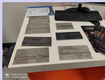
Rysunek 4. Demonstratory złączy próbnych wykonanych laserową spawarką ręczną IPG LightWeld
