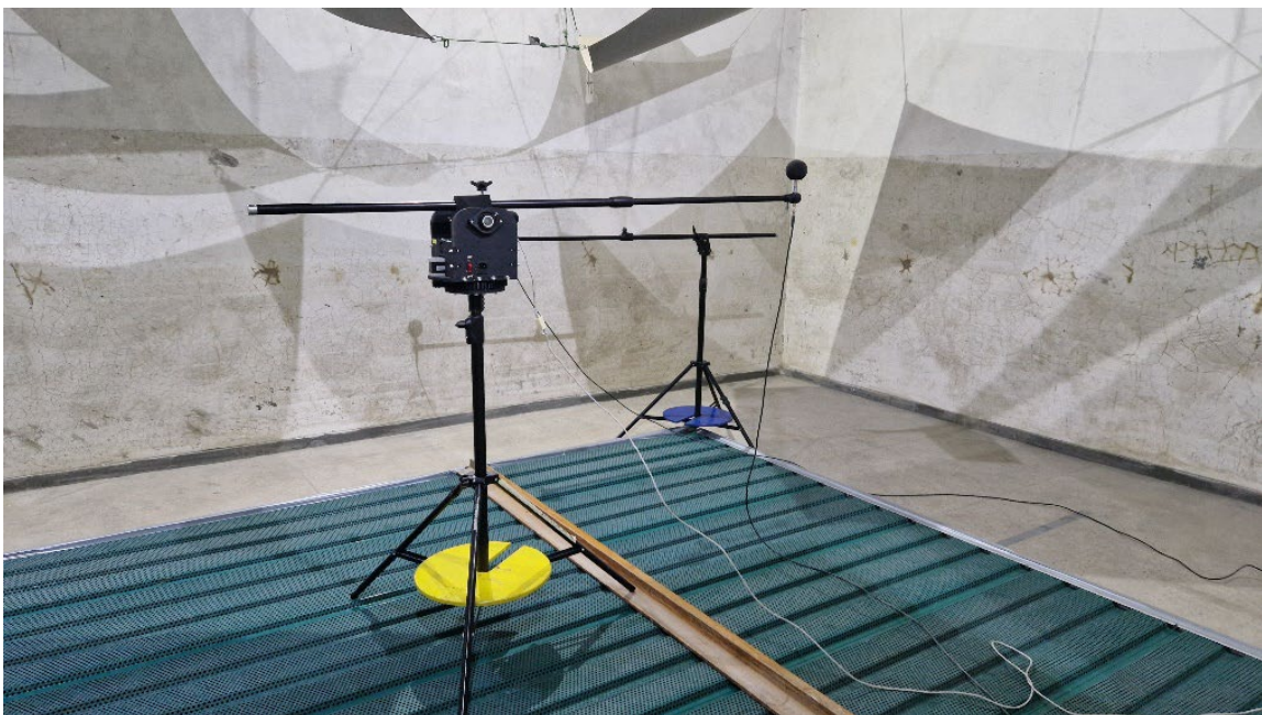
Fig. 29.7. View of the reverberation time measurement using the rotating arm Rys. 29.7. Widok pomiaru czasu pogłosu przy użyciu ramienia obrotowego
