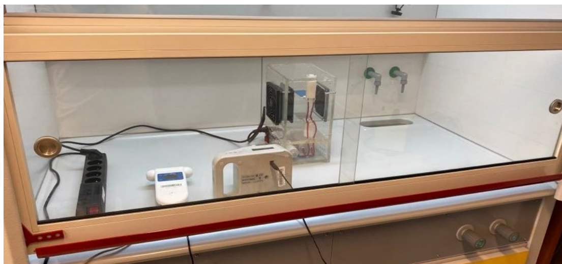
Rys. 12.1. Stanowisko pomiarowe składało się z: generatora ozonu wytwarzającego 0,12 g/min ozonu; próbnika Air Ideal 3P Biomerieux do pobierania bakterii i grzybów, miernika ozonu aeroqual serii 500
