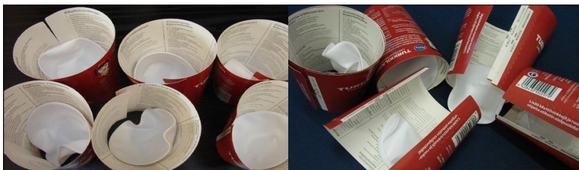
Rys. 3.3. a. – po lewej – pojemniki z PS po wyciągnięciu z suszarki po 2 minutach w temperaturze 160°C, b. – po prawej – kubki, w których tworzywo połączyło się z papierem po ostygnięciu Fig. 3.3. a – on the left – PS cups after removal from the dryer, b – on the right – connection of the plastics and paper after cooling
