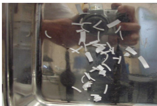
Rys. 3.2. Polistyren „przyczepiony” do metalowej powierzchni kuwety (fot. W. Hryb)
