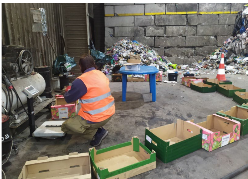
Rys. 1.1. Widok miejsca badań składu morfologicznego frakcji nadsitowej z odpadów komunalnych zmieszanych (fot. W. Hryb)
