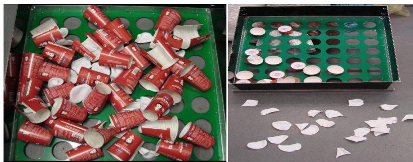
Rys. 3.4. Rozdzielenie frakcji tworzywa sztucznego i papieru na sicie po procesie skurczu termicznego pojemników PS/papier – wymiar średnicy oczka sita – 80 mm
