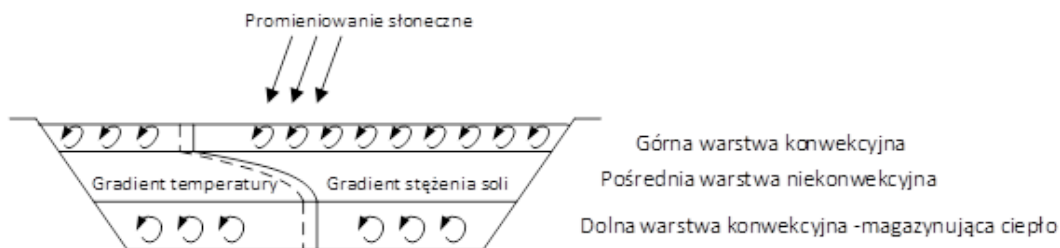
Rys. 18.1. Schemat stawu słonecznego wraz zaznaczonym gradientem temperatury i zasolenia [2, 8] Fig. 18.1. Diagram of a solar pond with temperature and salinity gradient marked [2, 8]
