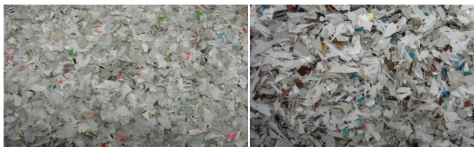
Rys. 3.1. Widok rozdrobnionej frakcji PS/papier – po lewej i PP/papier – po prawej (fot. W. Hryb) Fig. 3.1. View of the shredded fractions: PS/paper – on the left; PP/paper – on the right (photo W. Hryb)
