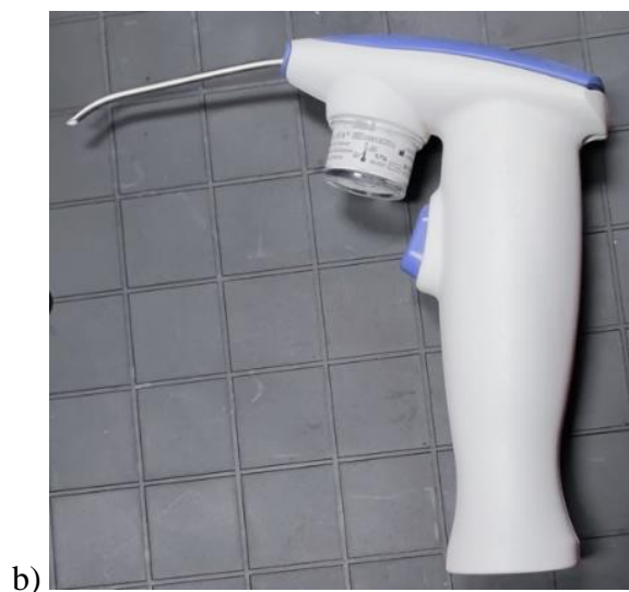
Rys. 5.5. Przyrządy do nanoszenia wzoru plamkowego: a) aerograf Infinity Harder&Steenbeck, b) rozpylacz proszku firmy 3M
