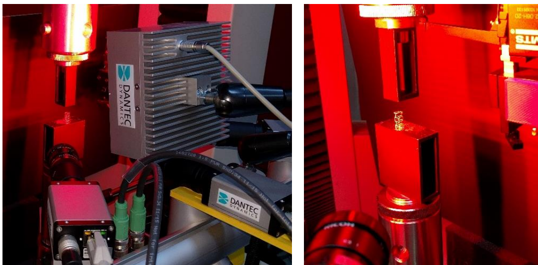
Rys. 6.22. Stanowisko z implantem medycznym o średnicy 6,0mm (DIC w skali makro)
