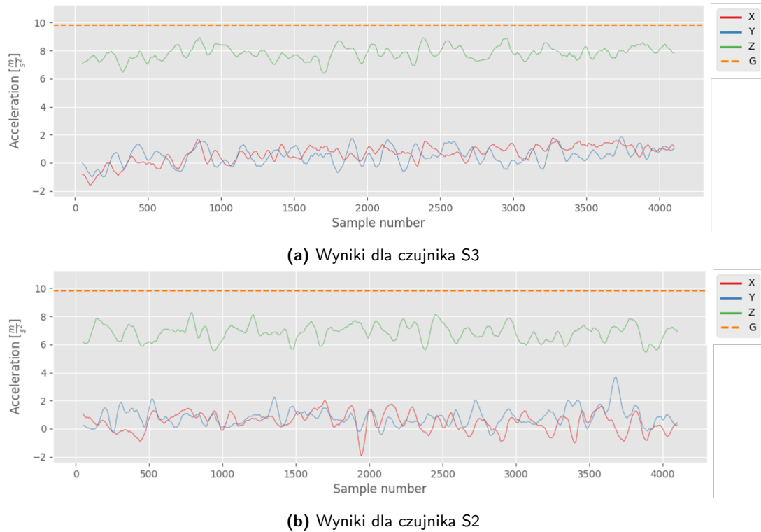
Rys. 5.10: Wykresy uzyskanych przyspieszeń dla czujników znajdujących się z tyłu zoptymalizowanego modelu platformy Phoenix III
