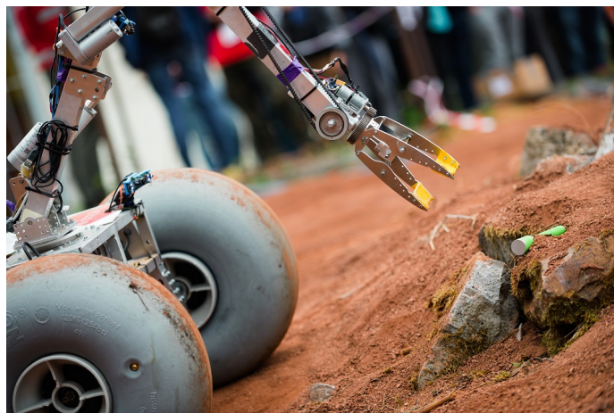
(b) Zmodyfikowana wersja chwytaka z dwoma palcami
