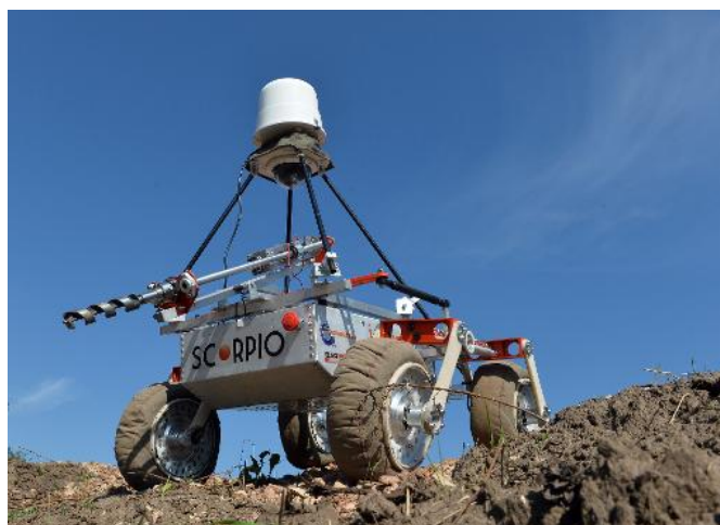
Rys. 2.15: Przykład wiertnicy zastosowanej w łaziku SCORPIO [71]
