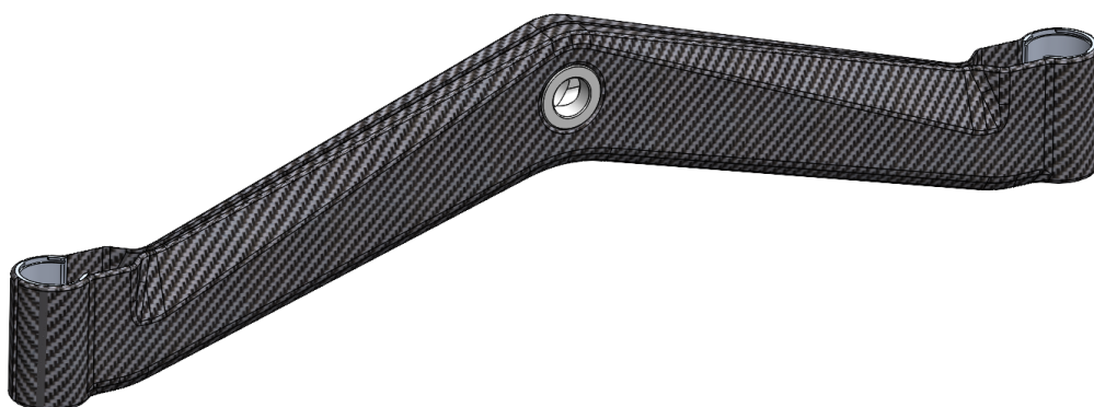
Rys. 3.34: Postać konstrukcyjna ramienia wykonanego z kompozytu węglowego
