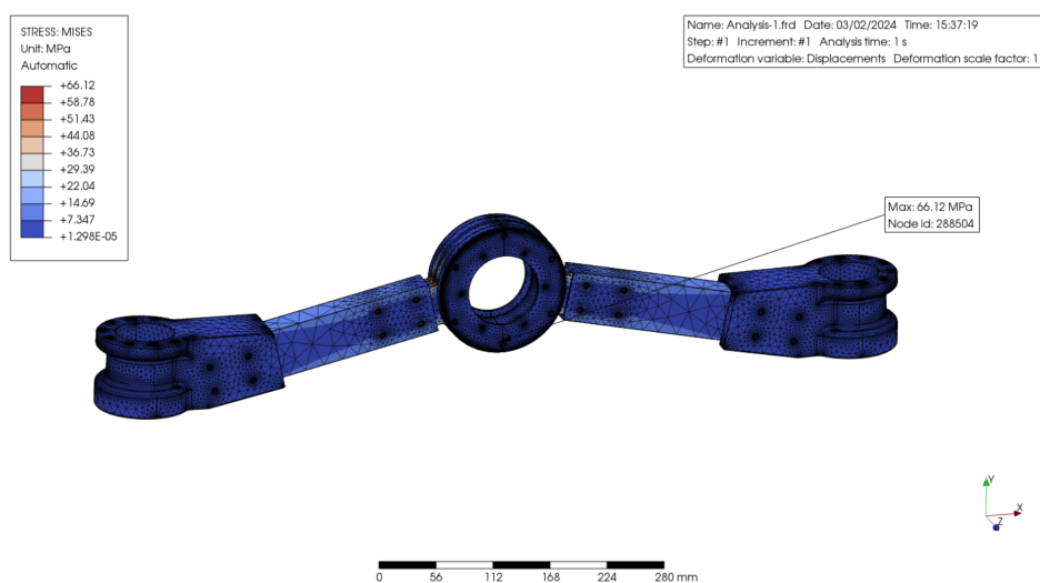
(c) Wyniki analizy MES dla naprężeń zredukowany według Hubera-Misesa
