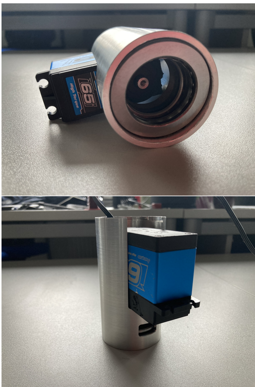
Rys. 4.6: Fizycznie wykonany prototyp układu skręcania
