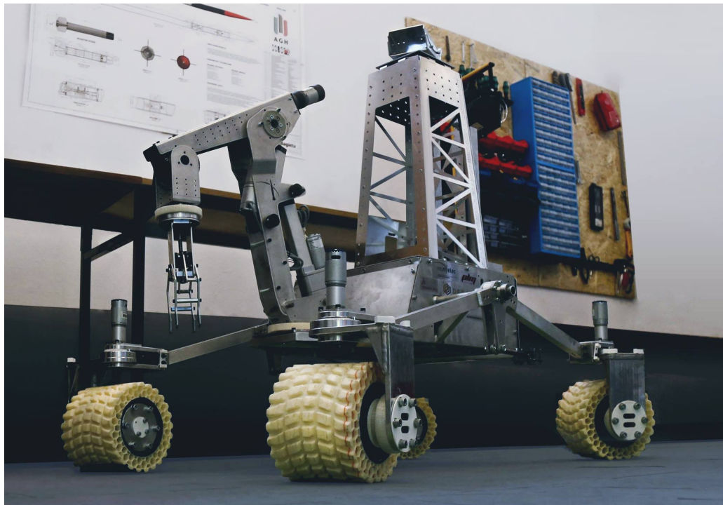
Rys. 2.8: Układ osi skrętnej zastosowany w platformie KALMAN [2]
