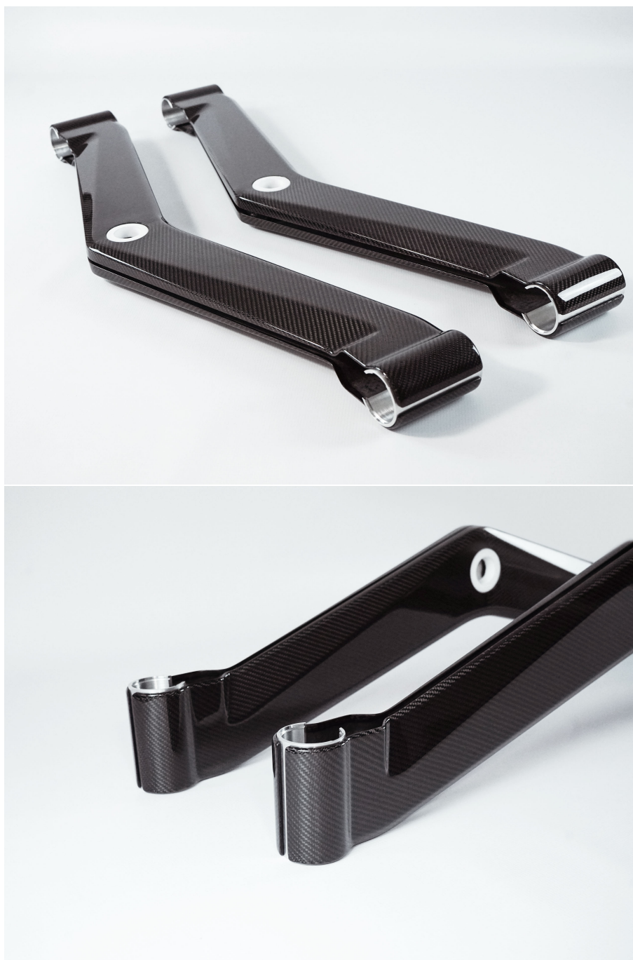
Rys. 4.4: Fizycznie wykonane elementy ramion zawieszenia
