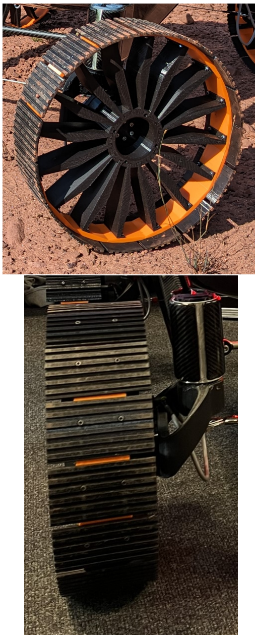
Rys. 4.8: Fizycznie wykonany prototyp układu napędowego
