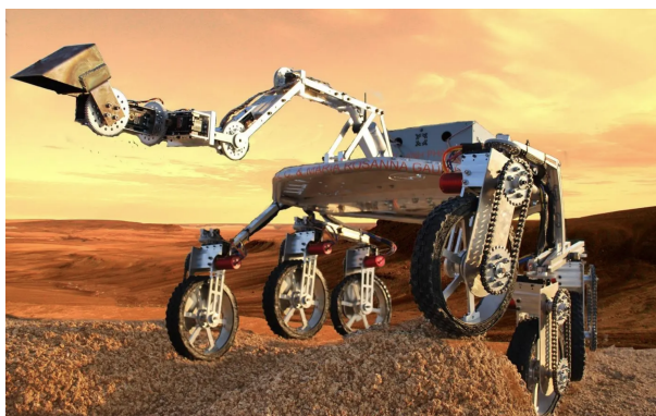
Rys. 2.14: Łazik Tytan z czepakowym systemem pobierania próbek [32]
