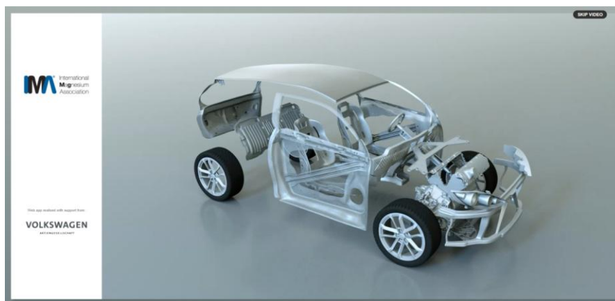
Rys. 7. Przykładowe wykorzystanie stopów magnezu w przemyśle motoryzacyjnym [13]
