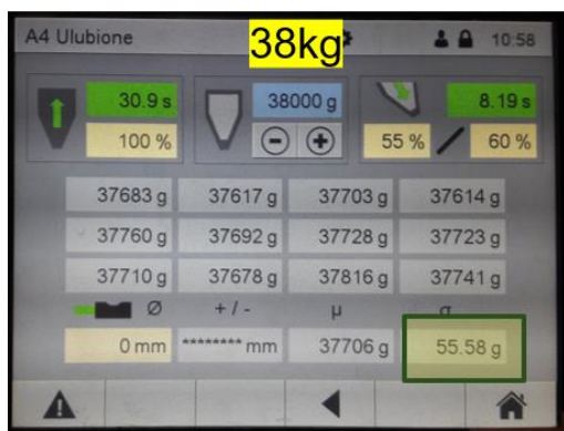
Rys. 78. Weryfikacja dozowania: a) test powtarzalności, b) pomiary na odlanych wlewkach.
