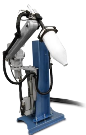
Rys. 18. System dozowania bazujący na podciśnieniu a) Przykładowe urządzenie AVD firmy MELTEC b) bazujący na dozowaniu z wykorzystaniem podciśnienia [52, 60].
