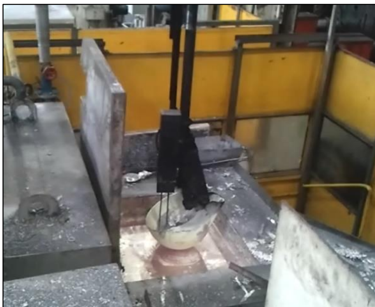
Rys. 34. Przykładowy system dozowania: „automatyczna łyżka zalewowa” zintegrowana z maszyną wysokociśnieniową oraz piecem podgrzewczym.
