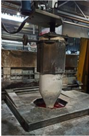
Rys. 76. Programowanie i weryfikacja poszczególnych etapów procesu dozowania: a) pozycjonowanie systemu nad piecem, kalibracja jednostki ważącej, b) zanurzenie i proces napelniania c) transport oraz dozowanie stopu do komory strzałowej.
