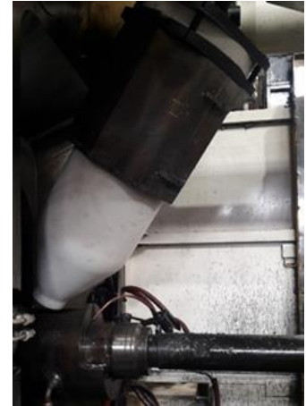
Rys. 76. Programowanie i weryfikacja poszczególnych etapów procesu dozowania: a) pozycjonowanie systemu nad piecem, kalibracja jednostki ważącej, b) zanurzenie i proces napelniania c) transport oraz dozowanie stopu do komory strzałowej.
