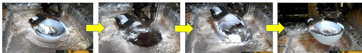
Rys. 35. Etapy pobierania ciekłego stopu przez automatyczną łyżkę zalewową z pieca podgrzewczego.
