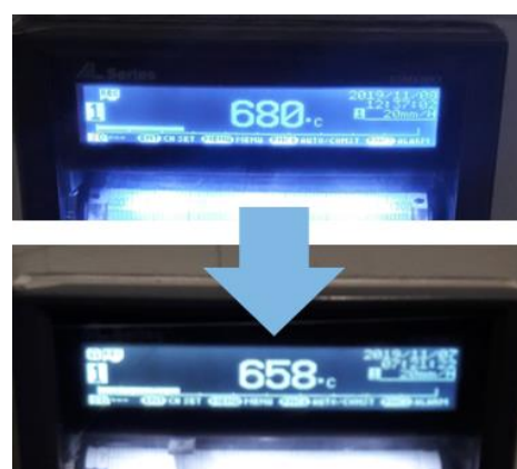
Rys. 80. Ograniczenie strat cieplnych w systemie dozowania AVD, dzięki zamkniętej konstrukcji czerpaka umożliwiło obniżenie temperatury ciekłego stopu o 20°C względem łyżki automatycznej [61].
