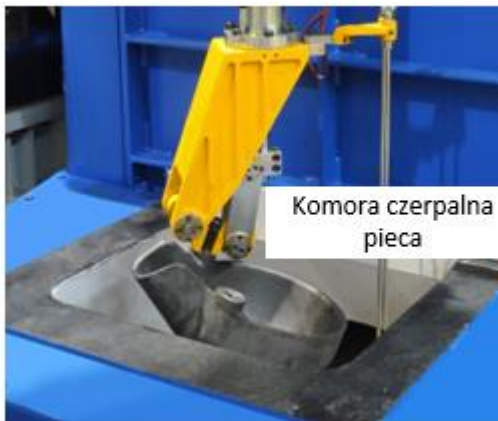
Rys. 12. System łyżki automatycznej: a) czerpak o kształcie otwartym w komorze pieca podgrzewczego, b) manipulator z zamontowanym systemem dozowania [54].
