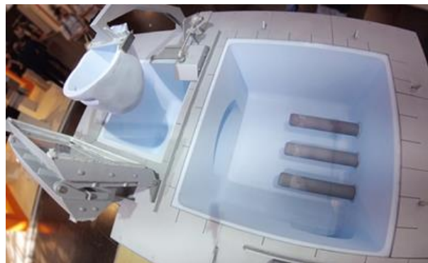
Rys. 14. Piece podgrzewcze: a) niezależne urządzenia b) współpracujące z automatyczną łyżką zalewową [49, 55].
