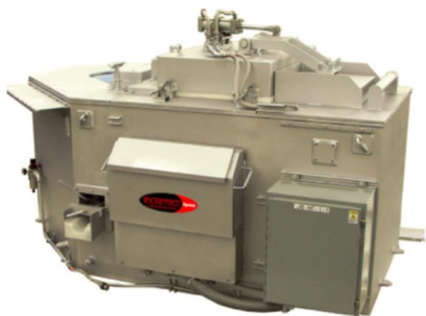
Rys. 14. Piece podgrzewcze: a) niezależne urządzenia b) współpracujące z automatyczną łyżką zalewową [49, 55].
