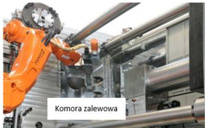
Rys. 12. System łyżki automatycznej: a) czerpak o kształcie otwartym w komorze pieca podgrzewczego, b) manipulator z zamontowanym systemem dozowania [54].
