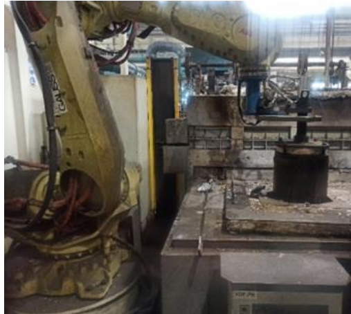
Rys. 76. Programowanie i weryfikacja poszczególnych etapów procesu dozowania: a) pozycjonowanie systemu nad piecem, kalibracja jednostki ważącej, b) zanurzenie i proces napelniania c) transport oraz dozowanie stopu do komory strzałowej.
