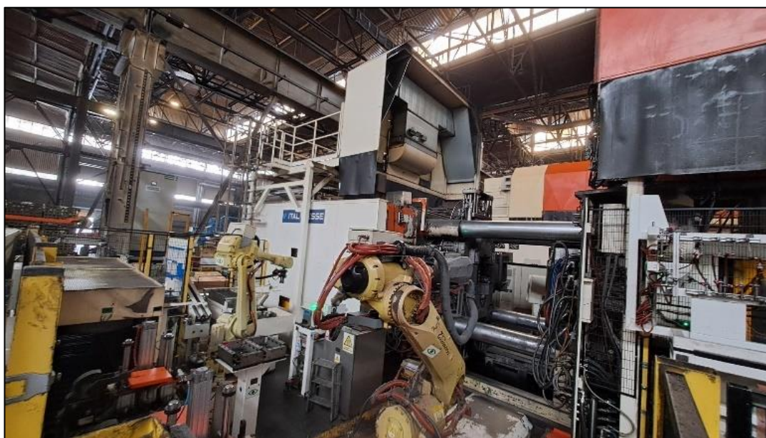
Rys. 37. Maszyna wysokociśnieniowa o sile zwarcia 2500 ton dedykowana do produkcji seryjnej korpusów silników spalinowych ze stopu AlSi9Cu3(Fe) .
