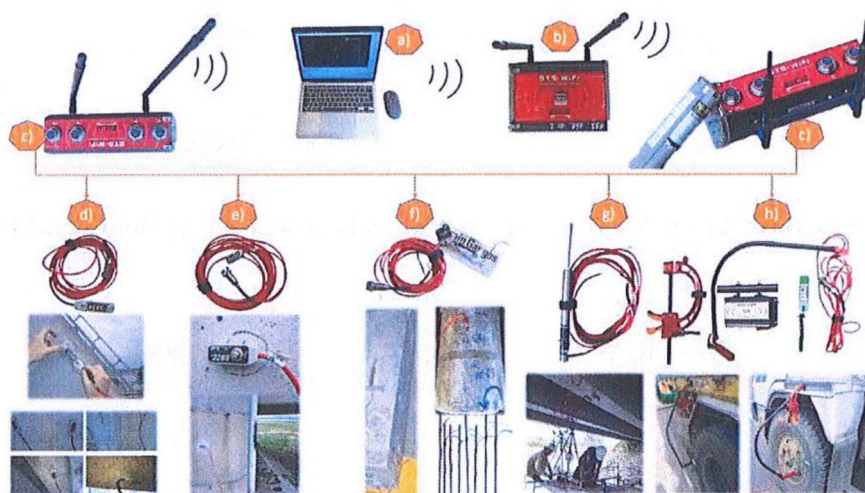
Rys. 5. Bezprzewodowy system badań strukturalnych (STS-WiFi) do diagnostycznych badań obciążeniowych istniejących obiektów mostowych.
